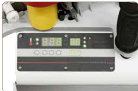
Panou de operare vizibil, operare prin intermediul tastaturii folie.
