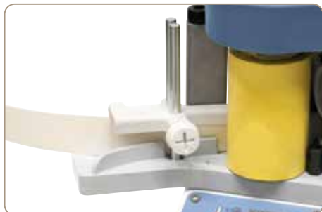
Sistemul de ghidare reglabil permite utilizarea grosimilor de muchii între 0,3 - 3,0 mm și înălțimilor de muchii între 10 - 65 mm
