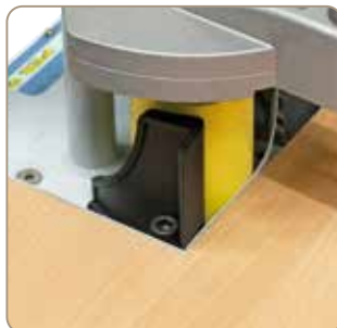
În fabricație de serie cu placă de ghidare pentru aducerea în colțuri a materialului de cant.
