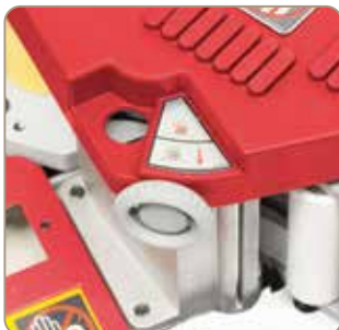
Cantitatea de clei alimentată poate fi reglată exact prin intermediul unui buton rotativ.
