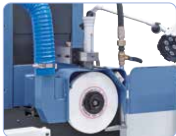
Dispozitiv de ascuțire paralel manual cu ajustare micrometrică cuprins în completul de livrare
