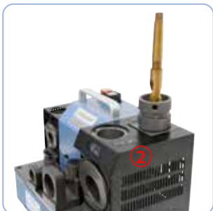
1. Detalonarea prin rectificare a unghiului feței de așezare Ø 2 - 13 mm 2. Detalonarea prin rectificare a unghiului feței de așezare Ø 8 - 32 mm
