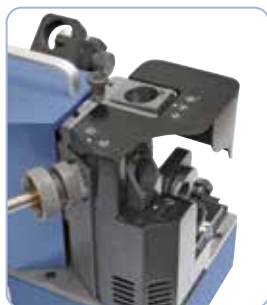
Șlefuirea unghiului feței de așezare la frezele cu 3 și 4 tășuri
