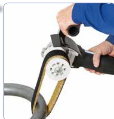
Optional cu centura de transmisie pentru a atinge sus balustrada din inox la montare
