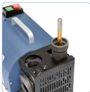
Detalonarea prin rectificarea a unghiului feței de așezare
