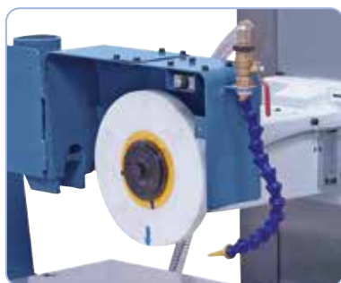
Funcționare cu puține vibrații și precizie înaltă a axului de șlefuire datorită rulmentului special pretensionat.
