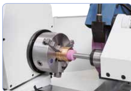
Este furnizat integral cu dispozitiv intern mobil de polizare
