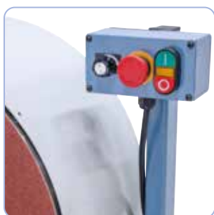
Reglare turație electronică.
