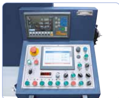
Inclusiv Siemens SMART-panou IE V3 cu ecran tactil și roată de mână electronică
