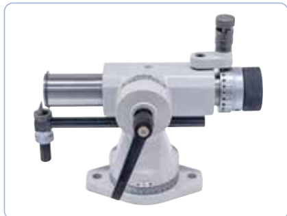
Dispozitiv de șlefuire tije freze 50D, Domeniul de șlefuire: 3 - 25 mm (opțional).
