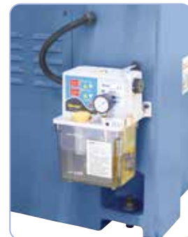
Lubrifiere centralizată pentru toate căile de ghidare și axele
