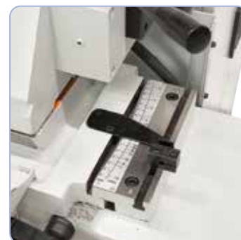
Pentru rectificare conică între vârfuri masa poate fi pivotată de la +3° până la -7°
