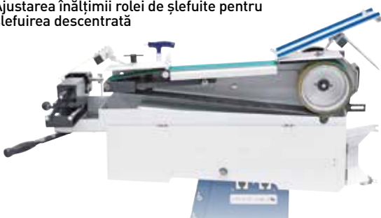
Capacul rabatabil permite schimbarea confortabilă a benzii de șlefuit
