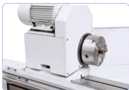
Cap de ax rabatabil de la +30° la -30°, dotat cu reglare continuă a vitezei
