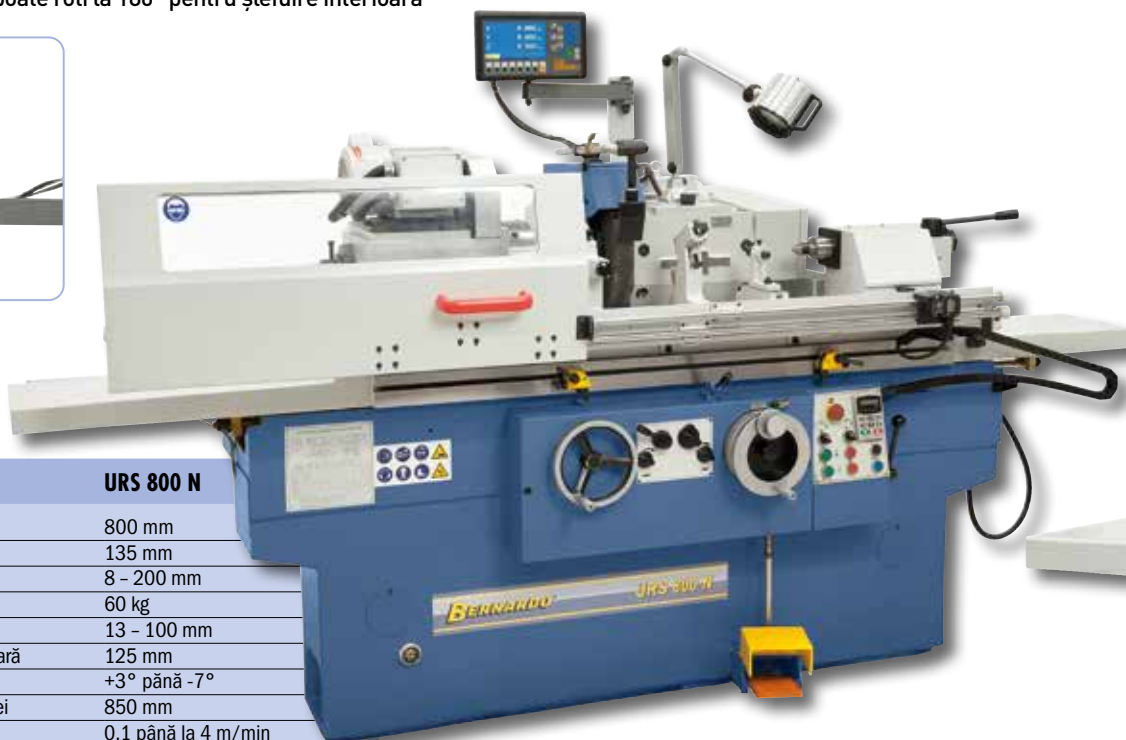
Echiptat în fabricație de serie cu indicator de poziție în 2 axe
