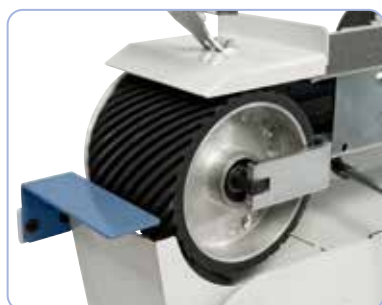
Rolă de contact 70° - 74° Shore A, optimă pentru prelucrări de degroșare
