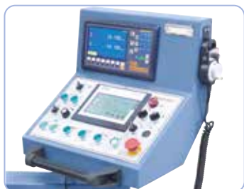
Afișaj digital cu ecran tip display LCD în 2 axe cuprins în completul de livrare.
