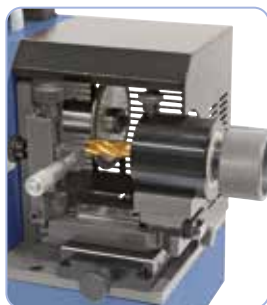
Șlefuirea tășului spiralei exterioare
