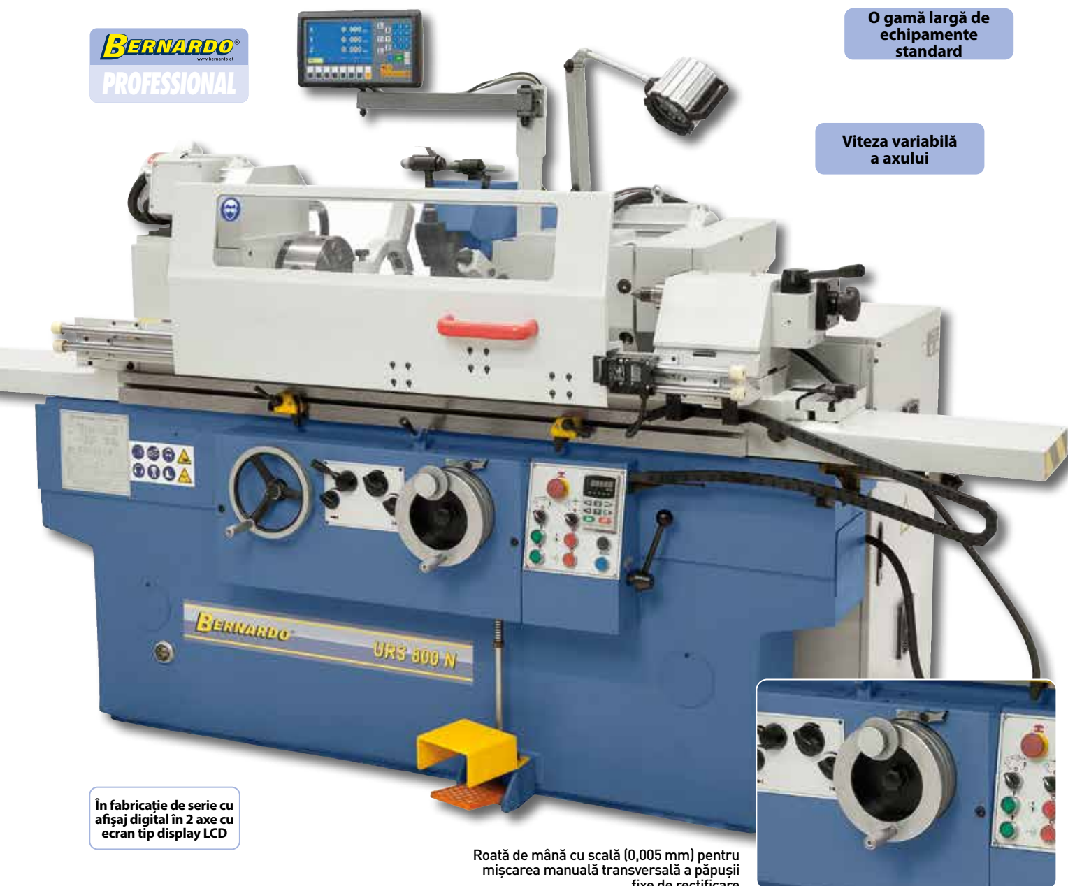
Păpușă mobilă hidraulică cu o exactitate și stabilitate ridicată, deplasabilă de la pedala de picior ridicată
