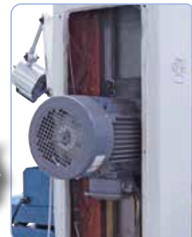
Ghidajul robust al capului de șlefuire asigură așezare precisă.
