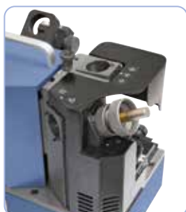
Șlefuirea unghiului feței de așezare la frezele cu 2 tășuri
