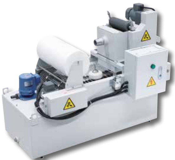
Echipament agent de răcire cu aspirare, separator magnetic și filtru de hârtie ce se obține opțional
