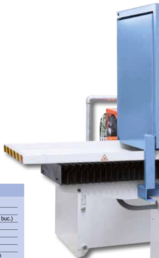
Echipament agent de răcire cu aspirare, separator magnetic și filtru de hârtie ce se obține opțional
