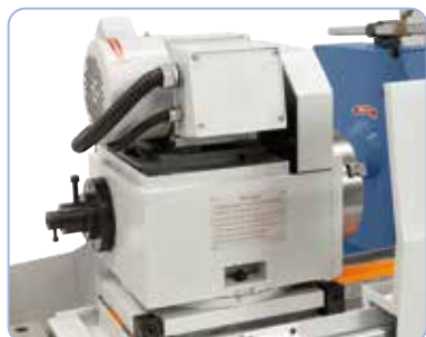
Cap ax pivotabil între 0° - 90° ajustabil pentru rectificare conică
