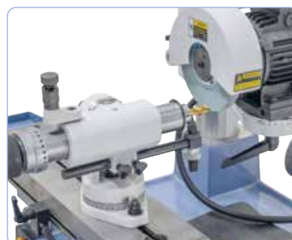
Freza cu coada cu degajare exterioară
