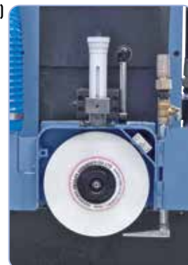
Funcționare cu puține vibrații și precizie înaltă a axului de șlefuire datorită rulmentului special pretensionat
