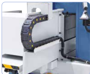
Inclusiv ghidare cablu prin lanț energetic
