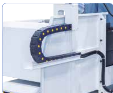
Inclusiv ghidare cablu prin lanț energetic
