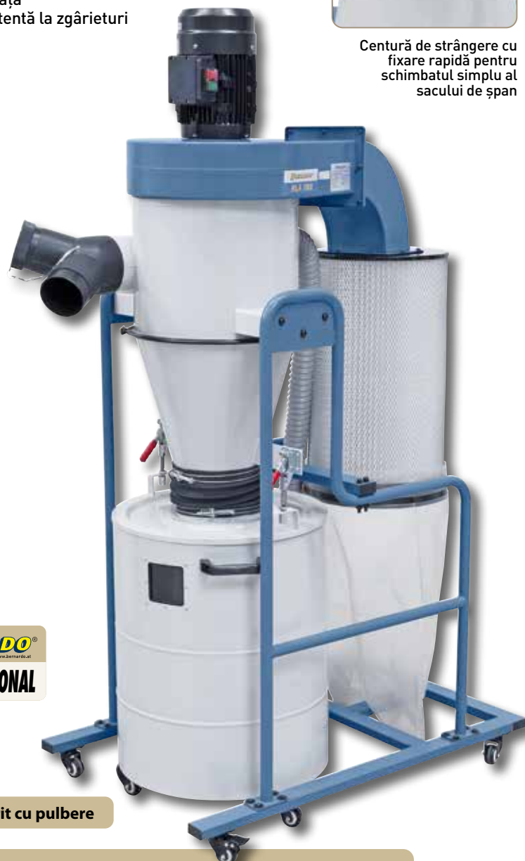
Cartușul filtrului inclusiv periile de curățare pentru îndepărtarea prafului fin fac parte din echipament.
