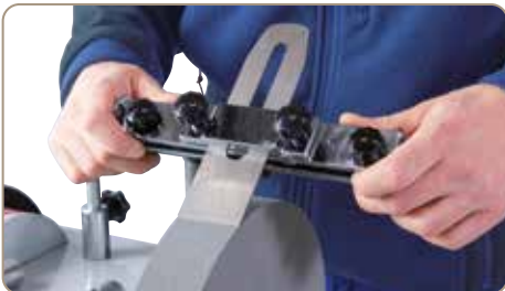
05-2054 Dispozitiv pentru muchii drepte: Potrivit pentru fier plan și dălți cu o lățime maximă de 70 mm și o grosime maximă de 6,5 mm
