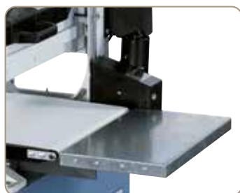
Suprafață de așezare mărită datorită prelungirile mesei pe ambele părți.
