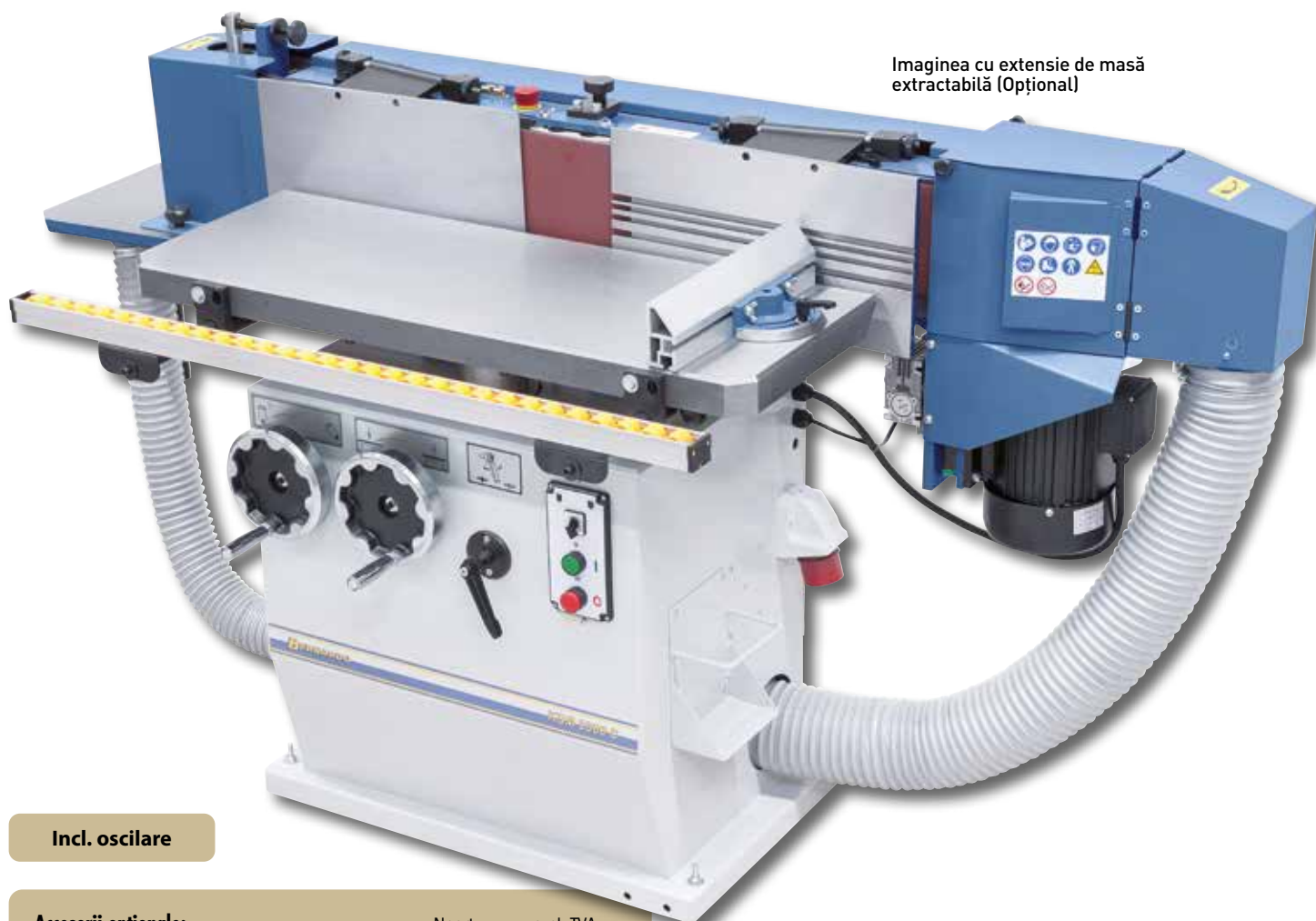
Strângerea rapidă a riglelor de ghidare pentru șlefuirea lemnului solid.
