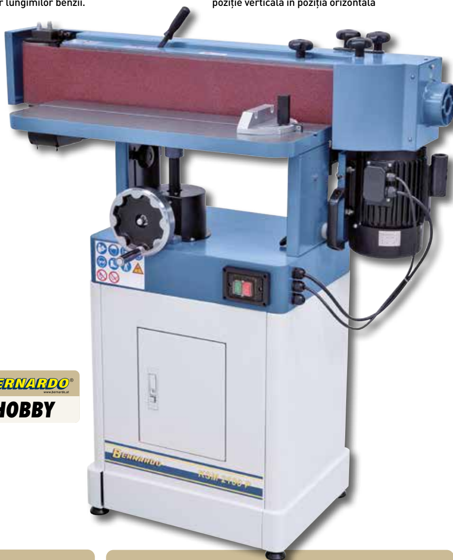
Tensionare bandă cu arc și astfel compensare automată a diferențelor lungimilor benzii.
