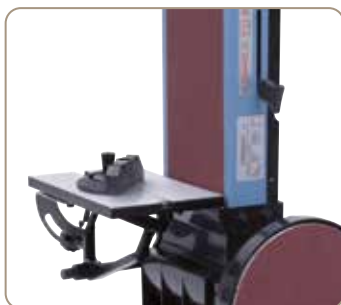
Masa de șlefuit platan poate fi utilizată la șlefuirea bandă.
