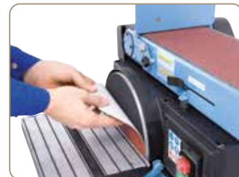
Dispozitivul de strângere cu balama și colțar permite schimbarea rapidă și ușoară a discurilor de șlefuire.
