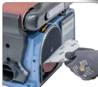
Inclusiv prindere tip arici pentru fixare platanului de șlefuit.
