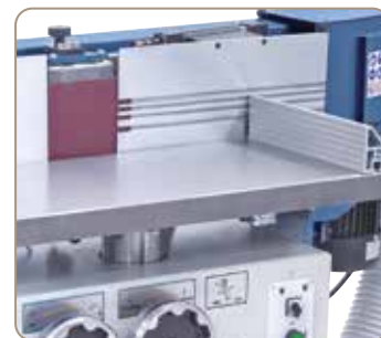
Cilindru de alimentare crestet pentru bucățile de furnir în exces.
