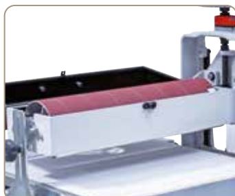
Capotă de aspirare rabatabilă deschisă pentru schimbarea benzii de șlefuit.
