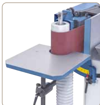
Masa suplimentară reglabilă pe înălțime cu aspirare dă posibilitatea șlefuirii de contururi la rola de întoarcere.
