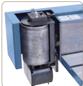
Agregat de șlefuire oscilant cu o cursă de 10 mm.
