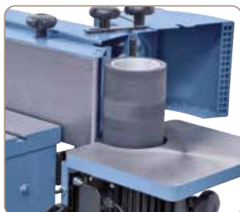
Suplimentar pentru șlefuirea conturilor în fabricație de serie cu o rolă de șlefuire cauciucată
