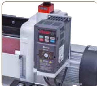
Convertorul de frecvență de calitate ridicată permite reglarea continuă a vitezelor axului.
