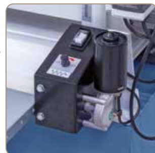
Motorul de avans de calitate asigură o funcționare uniformă a saltelei de avans.
