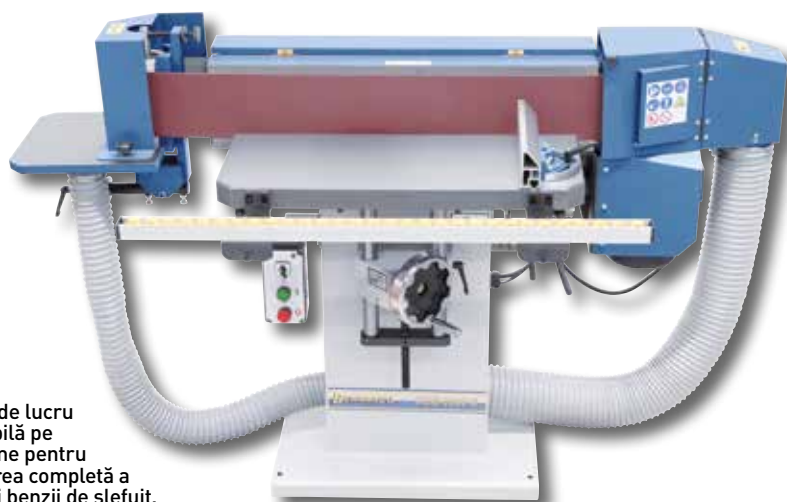
Schimbare simplă pentru operator a benzii de șlefuire datorită dispozitivului de prindere rapidă.
