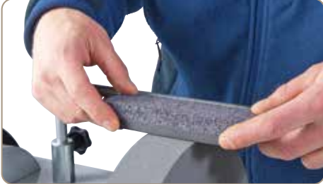
05-2050 piatră de șlefuit: fovacște la pregătirea discului de șlefuit (fin/grosier)
