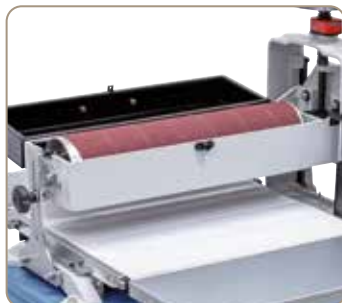
Capotă de aspirare rabatabilă deschis pentru schimbarea benzii de șlefuit.
