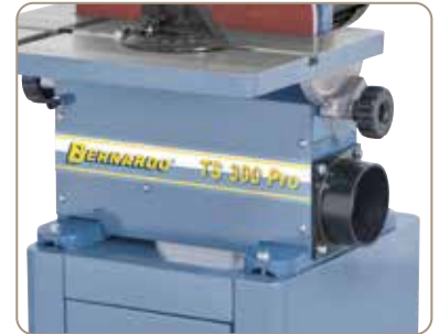
În fabricație de serie cu ventilator de aspirare în corpul mașinii.
