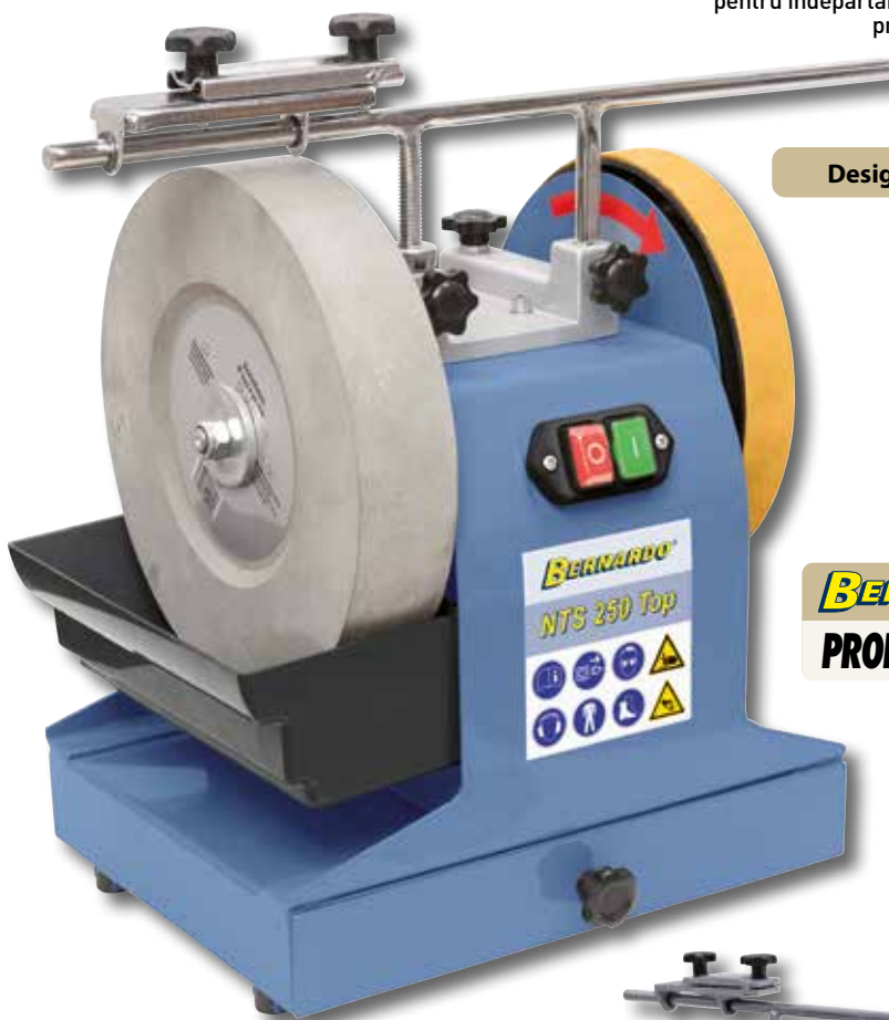
Dispozitiv universal UNI-100, adecvat pentru cel mai diferite scule drepte (standard)
