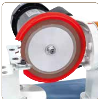
Echiptat în fabricație de serie cu disc de șlefuire diamantat.
