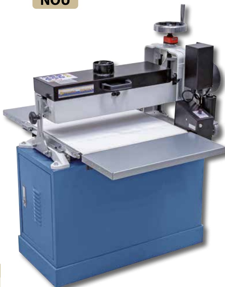
Suprafață de așezare mărită datorită prelungirile mesei pe ambele părți.
