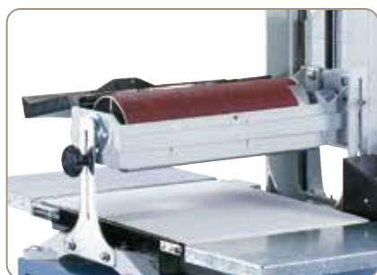
Capotă de aspirare rabatabilă deschisă pentru schimbarea benzii de șlefuit.
