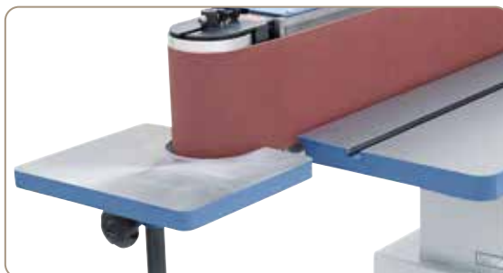
Masa suplimentară reglabilă pe înălțime dă posibilitatea șlefuirii de contururi la rola de întoarcere
