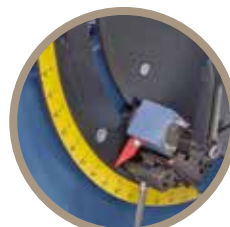
Agregat de șlefuire pivotabil fără trepte pentru șlefuire verticală și orizontală.
