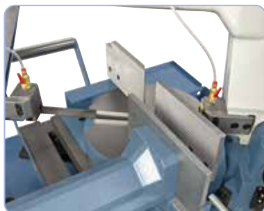
Fanta fierăstrăului în discul rotativ se mișcă simultan cu etrierul fierăstrău
