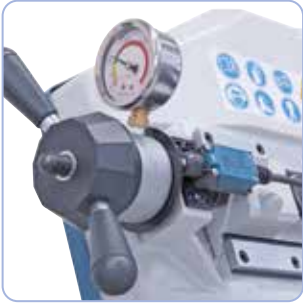
Controlul tensiunii benzii fierăstrău prin intermediul manometrului
