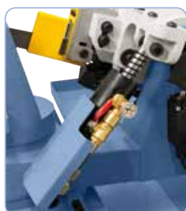
În fabricație de serie cu cilindru hidraulic pentru coborârea fără trepte a etrierului fierăstrăului
