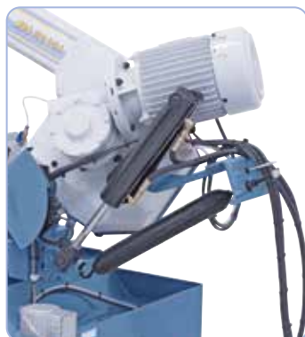
În fabricație de serie cu cilindru hidraulic de coborâre pentru coborârea fără trepte a etrierului fierăstrău și deconectarea automată de capăt după secționarea materialului
