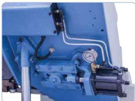
Echizat în fabricație de serie cu tensionarea hidraulică a benzii (NC Pro)
