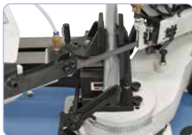
Etrier fierăstrău pivotabil pentru tăieri oblice de la -45^\circ până la 45^\circ
