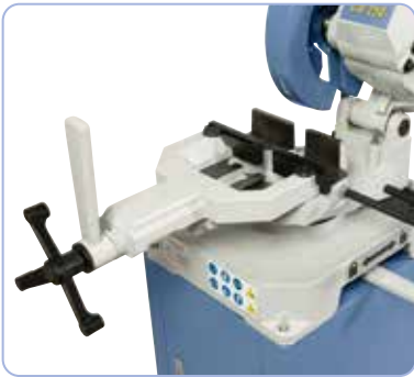
Menghină dimensionată mare cu mâner stea, pârghie de prindere rapidă și bacuri de prindere speciale pentru tăieri precise și fără bavuri
