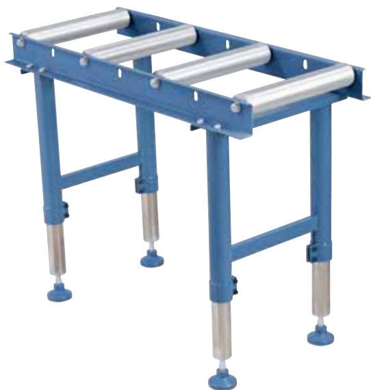
Role din oțel rezemate pe ambele părți pe rulmenți cu bile pentru asigurarea unei capacități de încărcare ridicate
