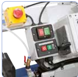
Disponere centrală a elementelor de comutare la etrierul fierăstrău
