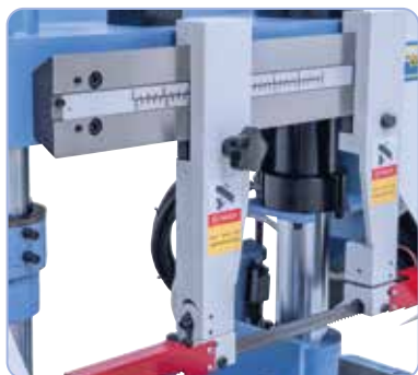
Ghidarea benzii fierăstrău reglabilă împiedică o deviere laterală sau o îndoire a benzii fierăstrău.
