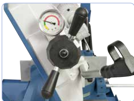
Manometrul din fabricația de serie dă posibilitatea unui reglaj optim al tensionării pânzei de fierăstrău
