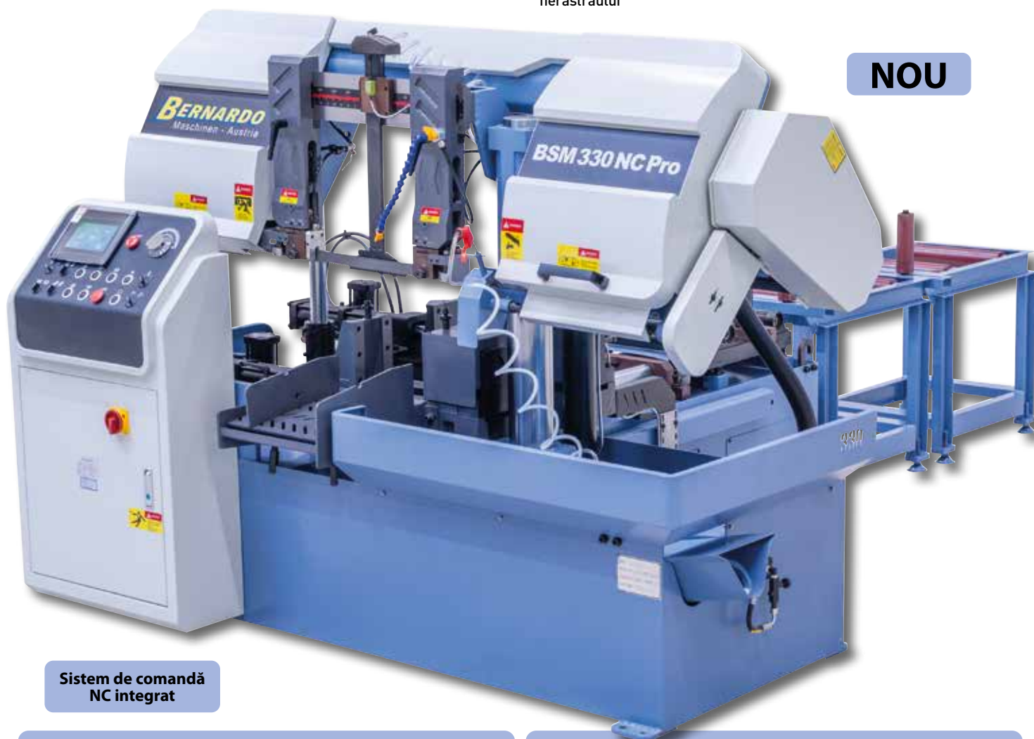
Cilindru hidraulic stabil pentru coborârea de finețe a etrierului fierăstrăului
