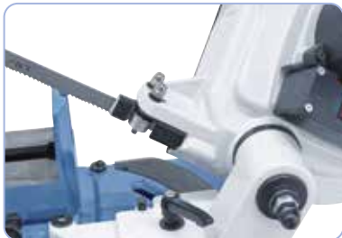
Rezultate de tăiere optime datorită ghidajului benzii fierăstrău rezemat pe lagăre cu bile
