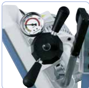
Controlul tensiunii benzii fierăstrău prin intermediul manometrului
