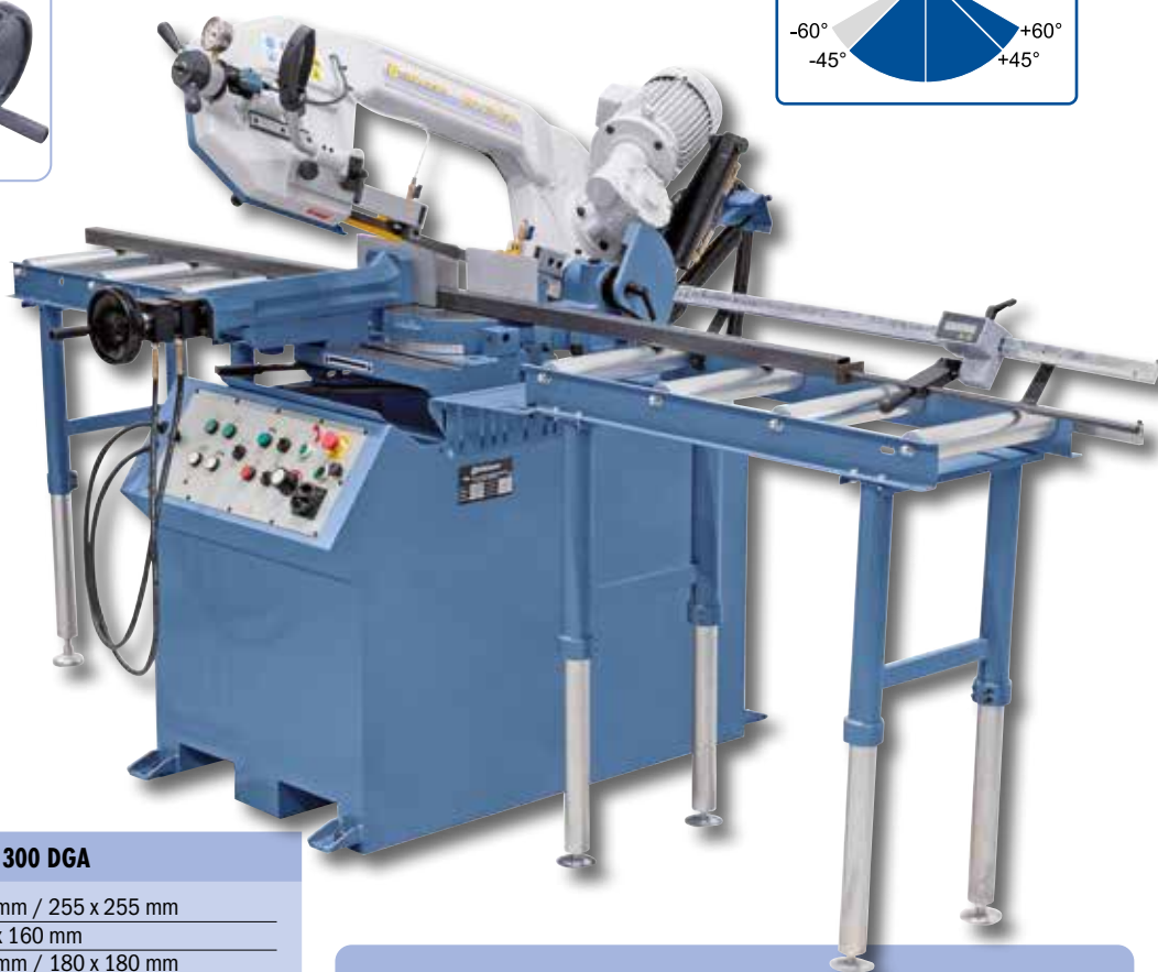
În fabricație de serie cu cilindru hidraulic de coborâre pentru coborârea fără trepte a etrierului fierăstrău și deconectarea automată de capăt după secționarea materialului
