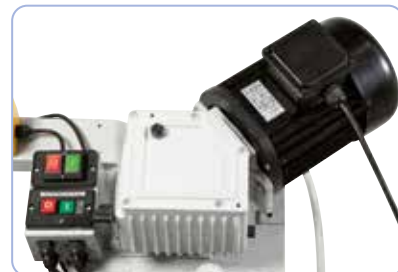
Transmisie cu arbore melcat călit și rectificat, roată melcată este din bronz
