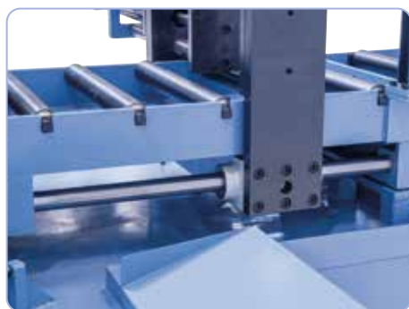
Ghidare de precizie și acționare hidraulică pentru exactitatea cea mai înaltă a poziționării a piesei de prelucrat.
