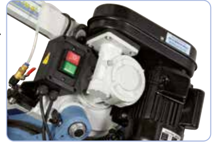
Prin intermediul curelei trapezoidale viteza de tăiere (24 / 41 / 61 / 82 m/min) poate fi schimbată
