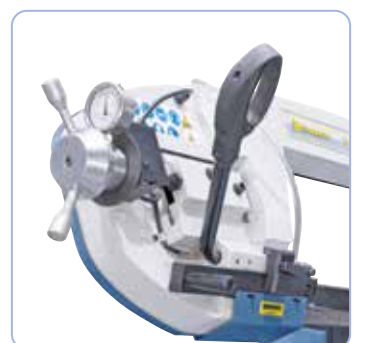
Mâner ergonomic, reglarea tensionării plăcii are loc prin intermediul roții de mână.
