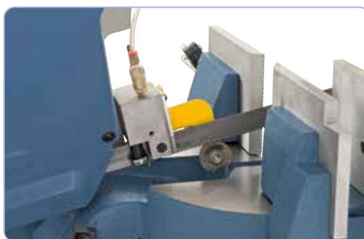
Ghidajului benzii fierăstrău rezemat pe lagăre cu bile și perii de șpan pentru rezultate optime ale tăierii
