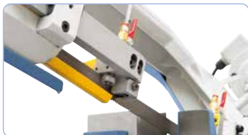
Elementele atașate role-metal dur asigură o ghidare ideală a benzii fierăstrăului și garantează astfel rezultate de tăiere optime
