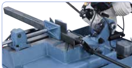
Ajustarea simplă a menghinei prin intermediul pârghiei de prindere rapidă.
