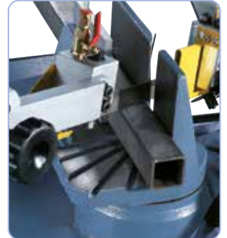
Pentru tăieri oblice etrierul fierăstrăului poate fi pivotat de la 90° până la 60°
