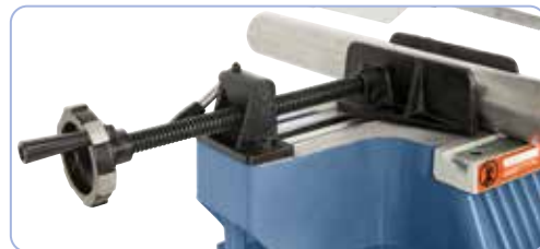
În fabricați de serie echipat cu menghină cu prindere rapidă patentată
