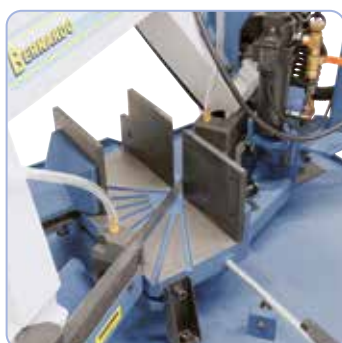
Pentru tăieri oblice etrierul fierăstrăului poate fi pivotat de la 90° până la 60°
