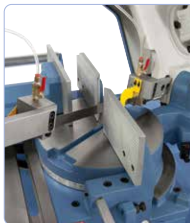
Fanta fierăstrăului în discul rotativ se mișcă simultan cu etrierul fierăstrău
