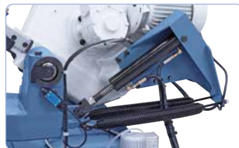
În fabricație de serie cu cilindru hidraulic pentru coborârea de finețe a etrierului fierăstrăului
