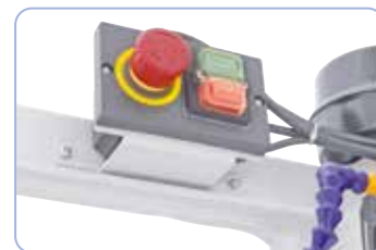
Înterupător de siguranță cu declanșator la subtensiune cu buton separat de oprire de urgență
