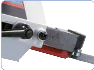
Rezultate de tăiere optime datorită ghidajului benzii fierăstrău rezemat pe lagăre cu bile
