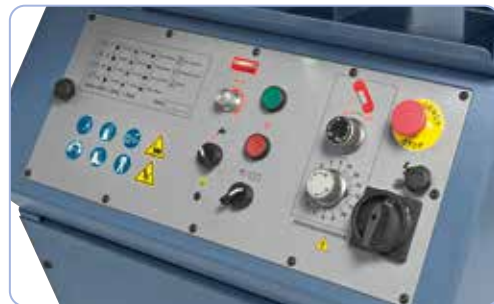
Comutator rotativ pentru viteza de tăiere fără trepte și supapa de reglare pentru presiunea de așezare la tabloul de operare montat ergonomic
