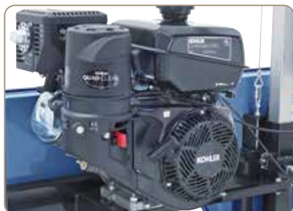
Motor cu benzină de putere Kohler Command Pro CH 440 14 CP și cablu de start
