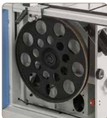
Roata de acționare cu bandaj de cauciuc asigură o funcționare silențioasă și crește durata de viață funcțională a benzii fierăstrău.
