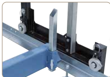
Patru role rezemate pe rulmenți cu bile garantează o funcționare ireproșabilă a agregatului fierăstrău
