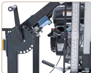
Reglarea înălțimii agregatului fierăstrău se realizează prin intermediul manivelei și poate fi citit pe o scală
