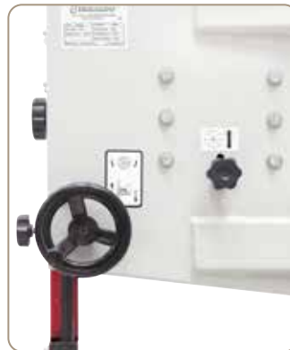
Roți de mână montate ergonomic pentru reglarea tensiunii lamei sau a înălțimii de tăiere pe partea posterioară
