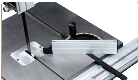
Masă fierăstrău dimensionată mare cu suprafață rectificată și canelură T pentru opritorul oblic (standard).
