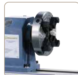
Pentru prinderea pieselor de prelucrat asimetrice mașina poate fi echipată cu o planșăibă cu 4 bacuri
