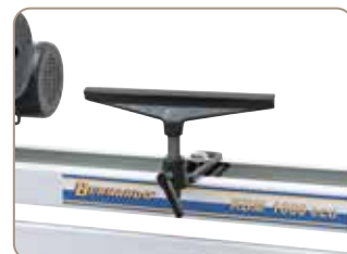
În fabricație de serie cu reazem de mână 300 mm.
