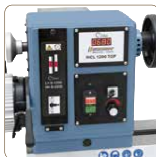
Afișajul digital în fabricație de serie înlesnește reglarea turației dorite
