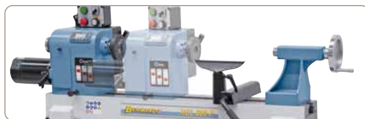
Unitatea cu ax se poate deplasa longitudinal și poate fi blocată în orice poziție.
