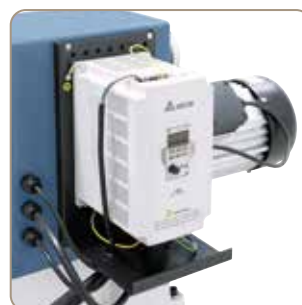
Convertorul de frecvență de calitate ridicată permite reglarea continuă a vitezelor axului.
