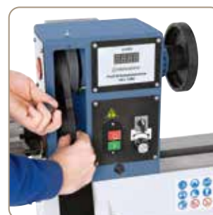
Schimbare simplă a treptei de transmisie prin reasezarea curelei trapezoidale.
