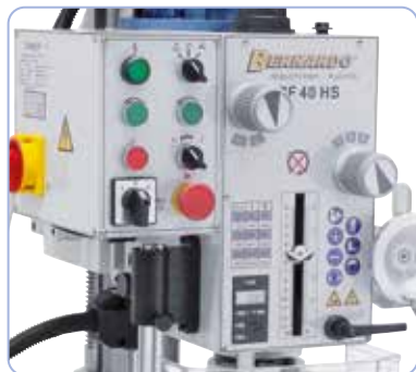
Elemente de comutare și operare înmontate vizibil la capul transmisiei
