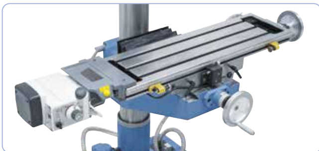
Masă în cruce dimensionată mare având caneluri T și jgheab cu agent de răcire. Reprezentare cu dispozitivul de avans opțional al mesei de frezare AL 450 D
