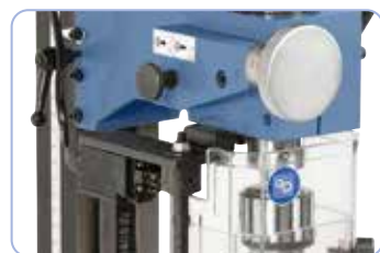
Pinolă cu așezare de finețe pentru lucru de precizie
