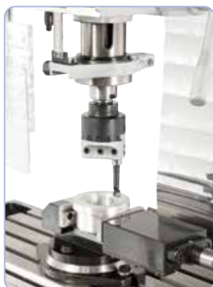
Alezare cu cap de strunjire interioară
