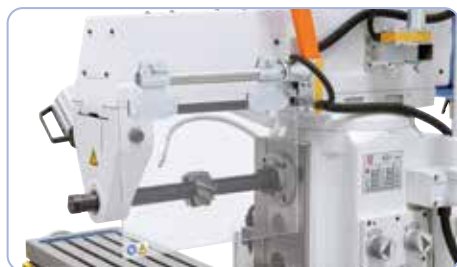
Pentru frezele în poziție orizontală cu contralagăr și dorn de frezare lung în fabricație de serie
