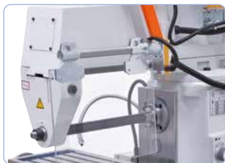
Include contralager și dorn lung de frezare, pentru operațiuni în poziție orizontală
