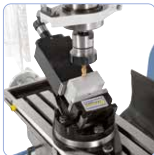
Frezarea cu menghină cu 2 axe
