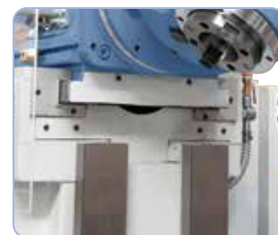
Ghidajul dreptunghiular dimensionat mare în axele y și z asigură o stabilitate crescută (FU 1600 / FU 2000)
