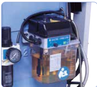
Lubrifierea centrală electrică pentru toate șinele și axele de ghidare
