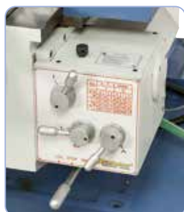
Prin avansul masei cu funcție de mers rapid în toate cele 3 axe existente în fabricația de serie sunt reduși timpii auxiliari în mod substanțial
