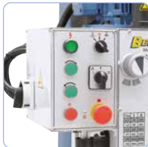
Elemente de control ușor de manevrat (filetare, Start - Stop...)
