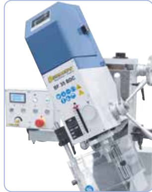
Cap de frezare pivotabil pe ambele laturi de la -90° până la +90°
