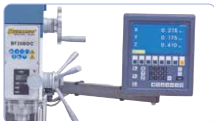
Un afișaj digital al poziției Bernardo ES-12 V în axele x, y și z este cuprins în completul de livrare (Nr. art. 02-1113 / 02-1114).
