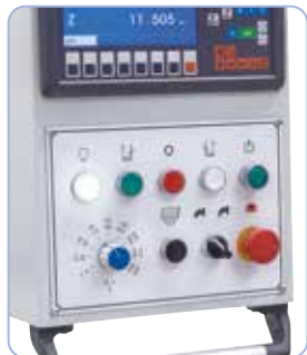
Reglarea rapidă și simplă a vitezei dorite a avansului direct la panoul de operare
