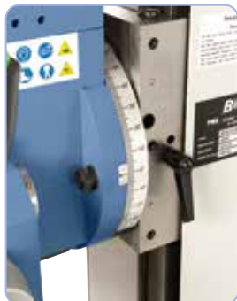
Ghidaj coadă de rândunică fără întreținere cu rigle până ajustabile
