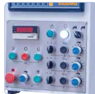
Reglarea rapidă și simplă a vitezei dorite a avansului direct la panoul de operare
