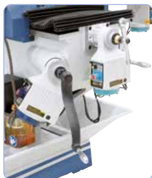
Dotat cu alimentare continuă în axa x, y și z
