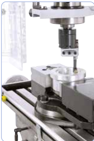
Alezare cu cap de strunjire interioară
