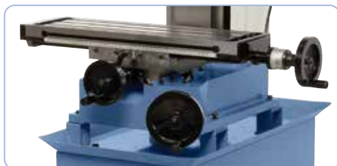
Ajustarea înălțimii capului de frezare confortabil pentru operator de la roata manuală la partea frontală
