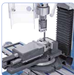
La cerere mașina poate fi echipată cu un cap de strunjire interioară
