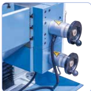
În fabricație de serie cu roți de mână electronice pentru deplasarea manuală în axele x, y și z.
