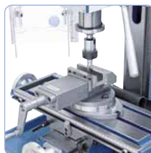
Livrabil opțional: Freză tijă cu plăci interschimbabile HM
