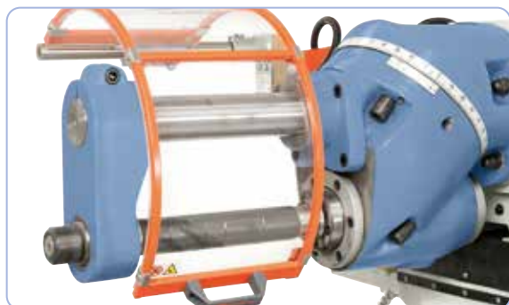
Pentru frezele în poziție orizontală cu contralagăr și dorn de frezare lung în fabricație de serie
