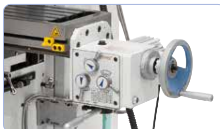
Masina se livreaza cu avans longitudinal masa cu functia de miscare rapida
