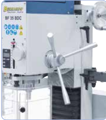
Mâner stea dimensionat mare pentru o poziționare ușoară a pinolei la găurire, roată de mână pentru poziționarea de finețe la frezare
