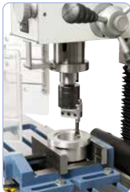
La cerere mașina poate fi echipată cu un cap de strunjire interioară
