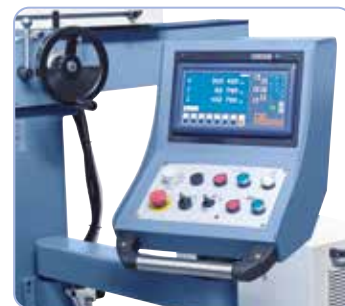
Elemente de control aranjate ergonomic la panoul de comandă înclinat, în serie cu citire digitală în 3 axe cu afișaj LCD.
