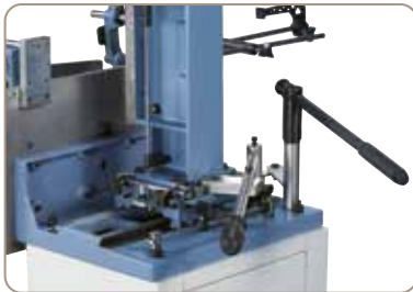
Mișcare longitudinală și transversală cu opritoarele reglabile
