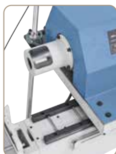
Ghidajul precis al cilindrului permite mișcarea cu acuratețe a unității de perforare.
