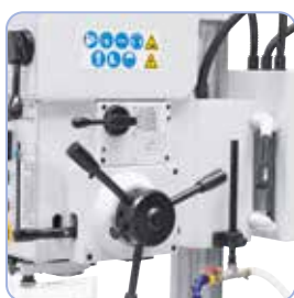
În fabricație de serie dotat cu 3 avansuri automate de găurire
