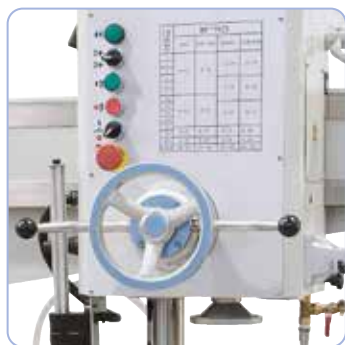
Toate elementele de comutare și control sunt montate vizibil la păpușa fixă
