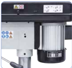
Motor din aluminiu silențios și puternic conform IP 54
