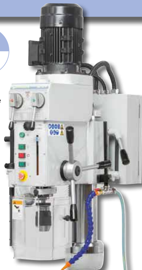
Elemente de conectare și operare montate vizibil pe partea frontală a mașinii
