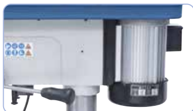
Motor de aluminiu putere de antrenare conform IP 54
