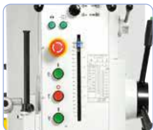
Operarea simplă a elementelor de comutare la partea frontală
