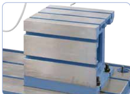
Masă cubică șlefuită cu precizie cu 5 T-caneluri, cuprinsă în completul de livrare în fabricația de serie
