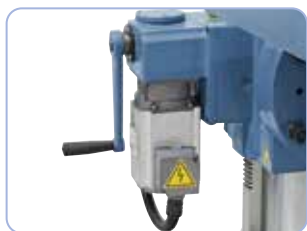
Reglarea înălțimii mesei motorizată, confortabilă
