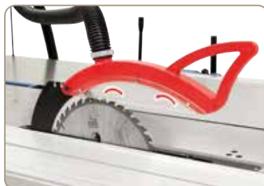
Protecția discului fierăstrău cu racord integrat de aspirare este fixată la pana de despicat. În fabricație de serie echipat cu agregat de canelare preliminară.
