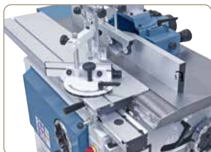
Masa de formare în fabricație de serie simplifică prelucrarea pieselor lungi.
