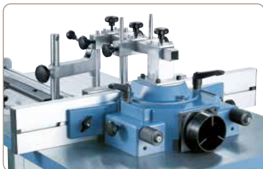
Capota de protecției a frezei este echipată cu un dispozitiv de reglare de finețe. Evacuarea șpanului aer loc prin racordul de aspirare integrat.
