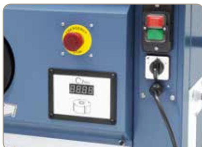
Afișaj electronic al vitezei de frezare reglate.
