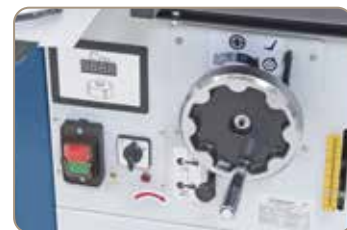
Afișaj electronic al vitezei de frezare reglate.
