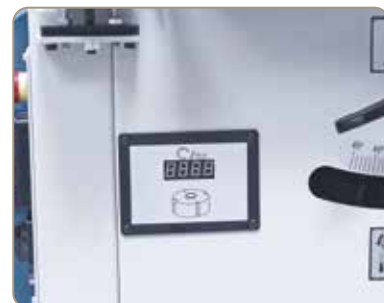
Afișaj electronic al vitezei de frezare reglate.
