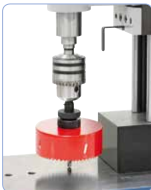
În fabricație de serie cu con MK 3 - pentru prinderea celor mai diferite scule
