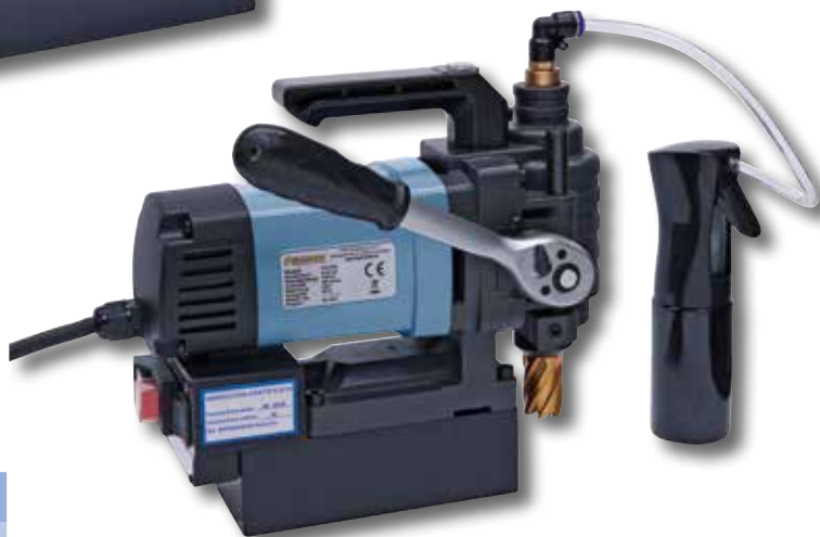
O cheie cu clichet facilitează lucrul în cazul spațiilor limitate.
