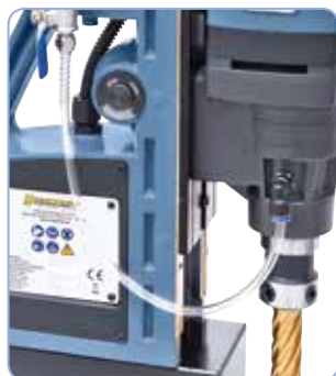
Reglarea precisă a vitezei de tăiere prin intermediul potențiometrului.
