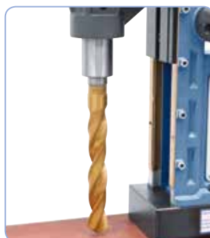
În fabricație de serie cu con MK 3 - pentru prinderea celor mai diferite scule
