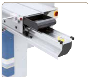
Funcționare cu deplasare ușoară și precisă datorită apreciatului sist. de ghidare cărucior cu role duble.
