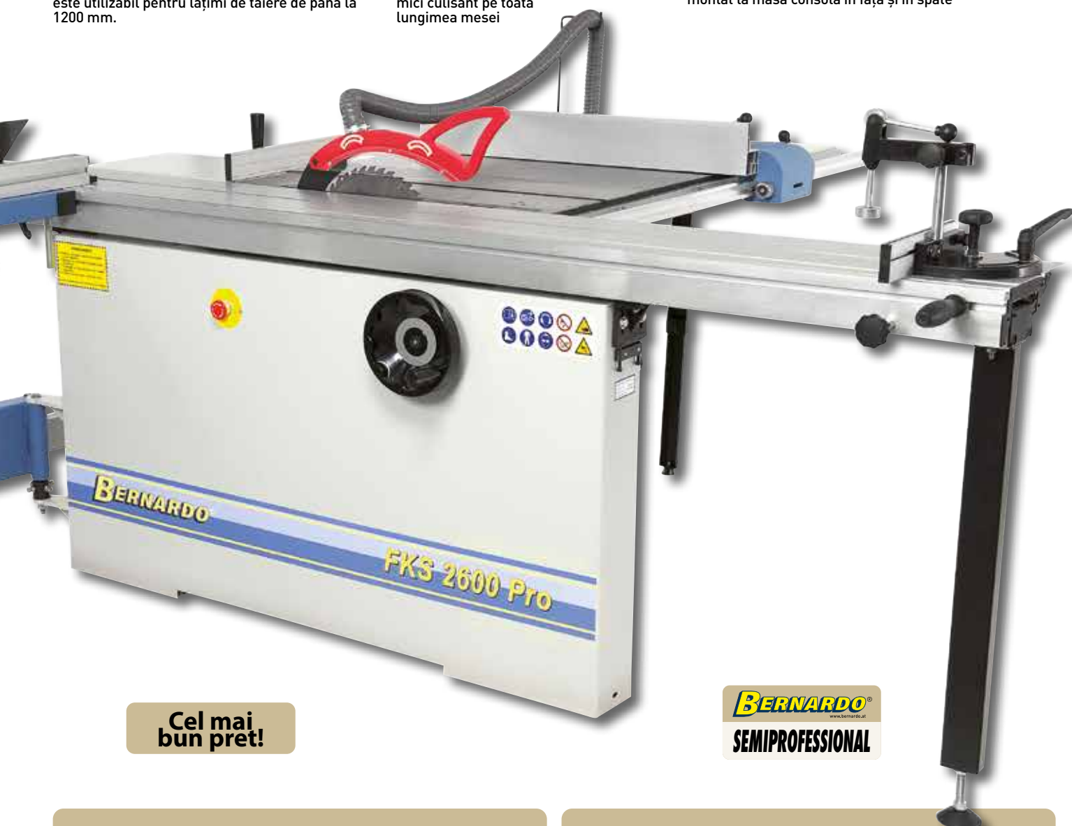
Opritorul telescopic pivotabil fără trepte (2 x 45°) poate fi montat la masa consolă în față și în spate
