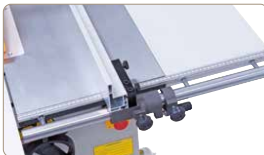
Ghidare precisă a opritorului paralel din aluminiu prin intermediul barei rotunde de 30 mm.
