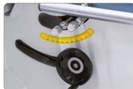
Reglare confortabilă pentru operator a dispozitivului de canelare preliminară pe înălțime și laterală.
