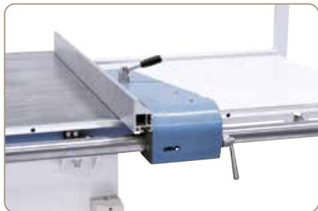
Opritorul paralel cu ghidaj bare rotunde este utilizabil pentru lățimi de tăiere de până la 1300 mm.
