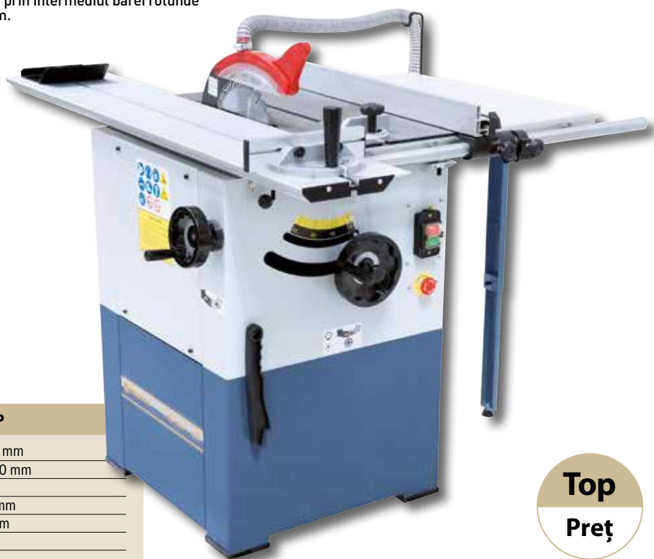
Canelură T din masa de formatare dă posibilitatea fixării opritorului oblic respectiv sabotului de tivire.
