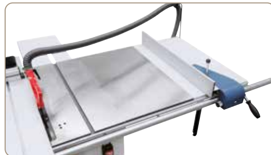
Masă de lucru dimensionată mare și extindere masă în fabricație de serie pentru lățimi de tăiere de până la 1200 mm
