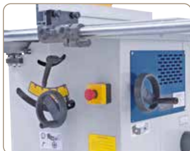
Ajustarea înălțimii respectiv pivotării agregatului fierăstrău se realizează prin roțile de mână ergonomic montate
