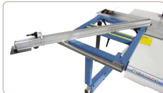
Opritorul telescopic pivotabil fără trepte (2 x 45°) poate fi montat la masa consolă în față și în spate
