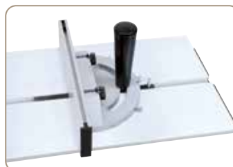
Canelură T din masa de formatare dă posibilitatea fixării opritorului oblic respectiv sabotului de tivire.
