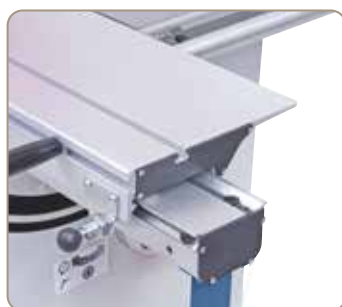
Sania de împingere formatare fără torsiune asigură un lucru precis prin ghidajul ușor deplasabil.
