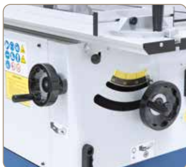
Ajustarea înălțimii respectiv pivotării agregatului fierăstrău se realizează prin roțile de mână ergonomic montate
