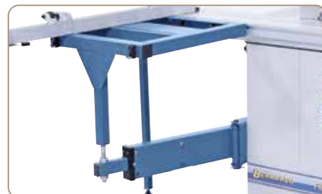
Masa consolă ușor deplasabilă este echipată suplimentar cu un braț pivotabil prin care este dată posibilitatea prelucrării plăcilor mari.
