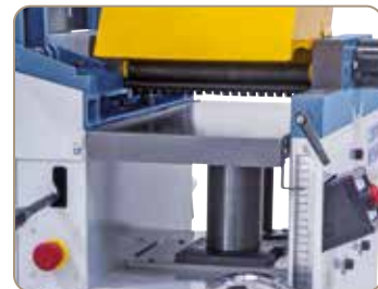
Masă de prelucrat la grosime cu ghidare prin pinole cu rezemare pentru un rindeluit exact a scândurilor, șipcilor, palplaușelor, ...
