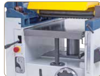
Masă de prelucrat la grosime cu ghidare prin pinole cu rezemare pentru un rindeluit exact a scândurilor, șipcilor, palplanselor, ...
