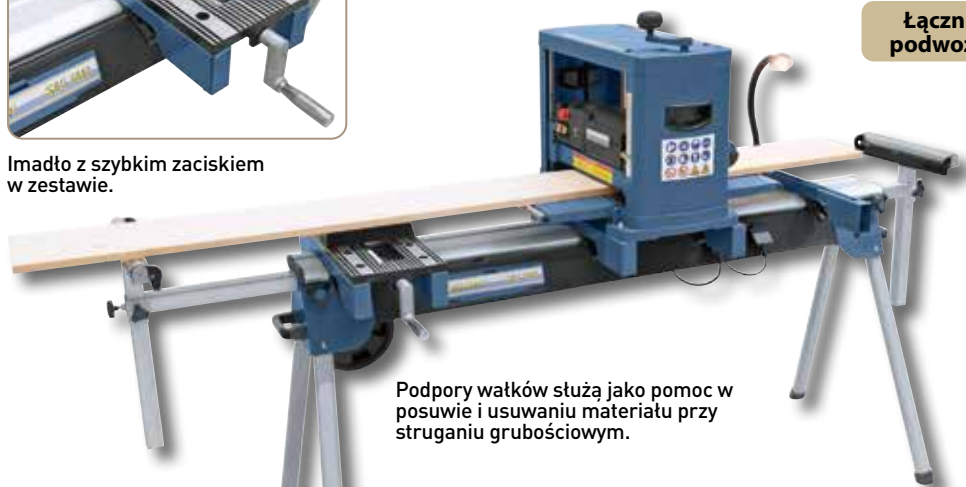
Przesuwne szyny mocujące można szybko i łatwo dopasować do szerokości maszyny.
