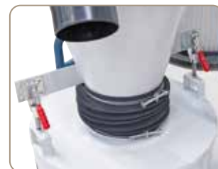
Seryjnie z dźwignią szybkiego blokowania dla łatwego dostępu do pojemnika odbiorczego
