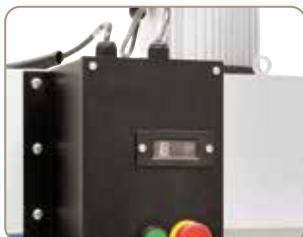
Regulowany zegar sterujący do automatycznego włączania i wyłączenia wyciągu.
