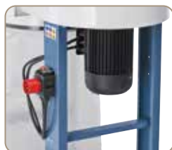
Silnik o dużej mocy ze stalowym kołem wentylatora
