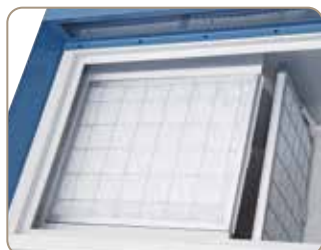
Standardowo z filtrem (drewno/metal) o dużej powierzchni.
