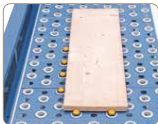
Standardowo ze zderzakami do pozycjonowania przedmiotu obrabianego.
