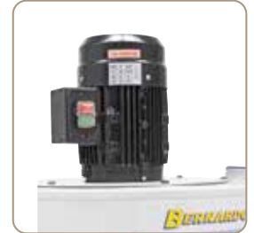
Silnik o dużej mocy ze stalowym kołem wentylatora
