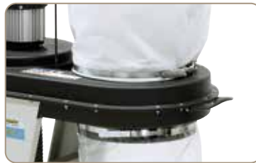
Łatwy montaż worka za pomocą pasa zaciskowego
