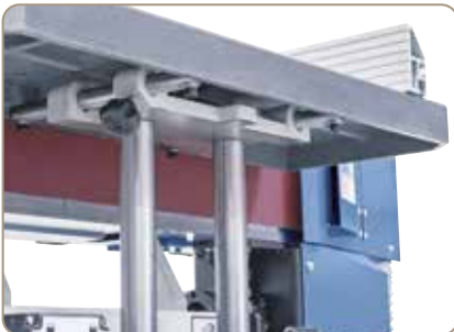
Stół z regulacją wysokości może być dodatkowo przeniesiony zarówno na przód jak i tył maszyny
