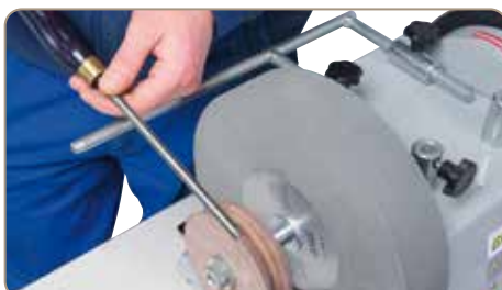
05-1809A Profilowany dysk skórzany: do obróbki i polerowania wewnątrz dłut i tomów
