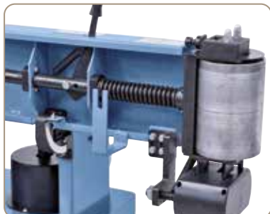
Sprężynowy naciąg taśmy powodujący automatyczne niwelowanie różnic w długości taśmy
