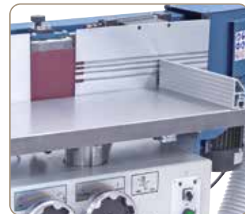
Rowkowana culała odbierająca idelana do szlifowania nadwyżki z forniru
