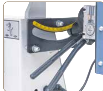
Szybkowzasciskowa dźwignia zapewnia łatwy i pewny montaż jednostki szlifującej
