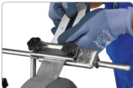
Przyrząd uniwersalny UNI-100, geeignet do verschiedenste gerade Werkzeuge (standard).
