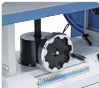
Ergonomicznie umiejscowione koło ręczne z przodu maszyny do regulacji wysokości stołu roboczego
