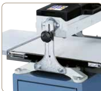
System zaciskowy do unieruchamiania agregatu szlifowania.
