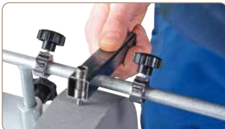
05-2058 ściągacz diamentowy: do wyrównywania tarczy szlifierskiej
