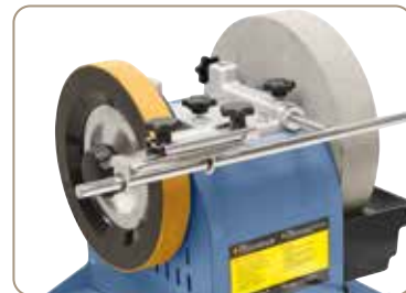
Z tarczą skórzaną do usuwania zadziorów po szlifowaniu.
