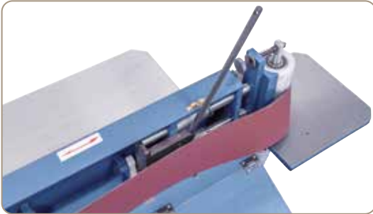
Wygodna wymiana taśmy szlifierskiej za pomocą mechanizmu szybkozaciskowego
