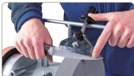
05-2057 Urządzenie do noży: długość ostrza od 100 mm, pasupo także do noży typu osńik
