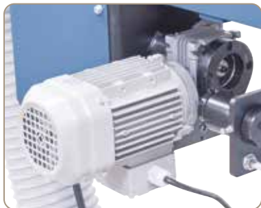
Bezobrotowy silnik napędowy zapewnia oscylację taśmy szlifierskiej
