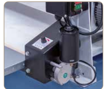
Prędkość posuwu można dopasować do obrabianego przedmiotu
