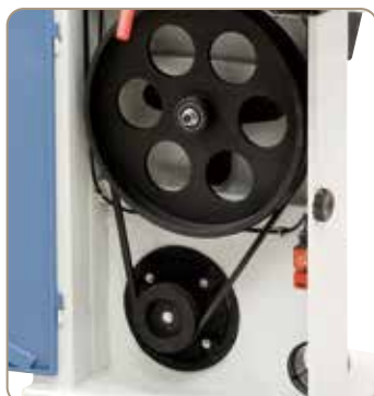
Solidne koło pasowe i wysokiej jakości pasek wielorolkowy zapewniają wysoką kulturę pracy i optymalne przeniesienie napędu
