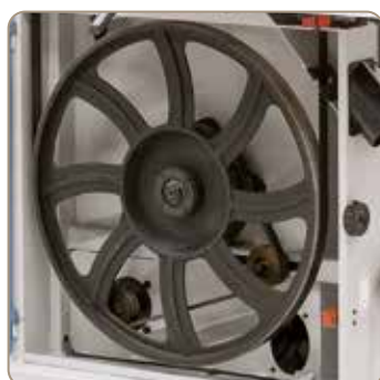
Aluminiowe koło napędowe z opaską gumową zapewnia spokojny bieg i wydłuża trwałość pily taśmowej
