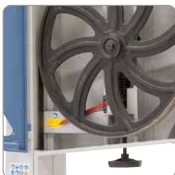
Naciąg pily ustawiany kołem ręcznym i pokazywany na wykresie w górnym kole.
