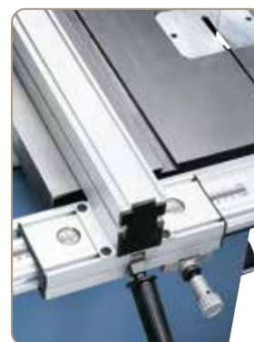
Lupa w ograniczniku utatwia odczytywanie podziatki w mm
