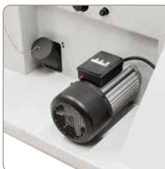
Silnik napędowy o wysokim momencie obrotowym przeznaczony również do ciągłej pracy, odciąg wiórów przez króćce o średnicy 100 mm
