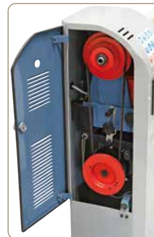
Wyrównoważone koła napędowe i wysokiej jakości paski zapewniają wysoką kulturę pracy
