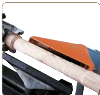
Dostępny w wyposażeniu opcjonalnym odciąg zapewnia czystość w miejscu pracy
