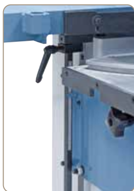
Prowadnica w celu precyzyjnego ustawienia wysokości
