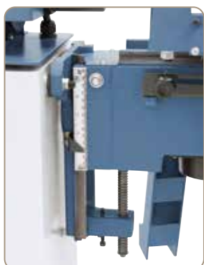
Odczyt ustawionej wysokości roboczej stołu wiertarskiego na podziatce
