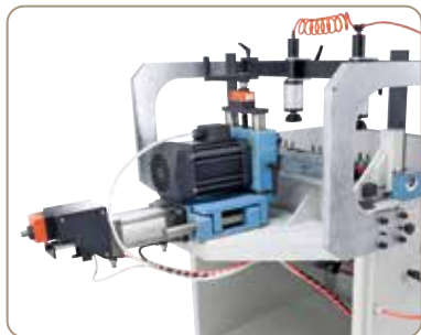
Dwa liczniki: głębokości wiercenia i ustawiania wysokości
