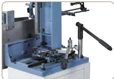
Ruch wzdłużny i poprzeczny z regulowanymi ogranicznikami
