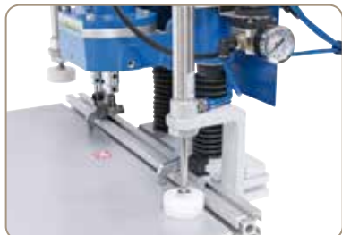
Pneumatyczny docisk pozwala na idealne zamocowanie obrabianego materiału (BBM 35 P)
