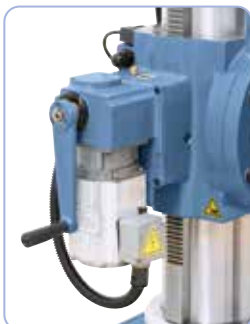
Silnikowo podnoszony stół roboczy, znacznie usprawniający pracę urządzenia.
