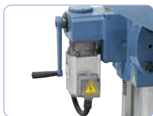
Komfortowo, silnikowo regulowana wysokość stołu.
