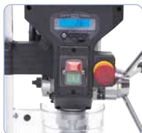
Włącznik/wyłącznik zgodny z normą IP 54 oraz oddzielny przycisk zatrzymania awaryjnego zgodnie z normą CE
