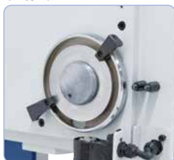
Urządzenie do gwintowania ze zmianą kierunku obrotów, idealne rozwiązanie do produkcji seryjnej (do KBM 50).
