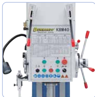
Wrzeciennik wiertarski o przejrzystej konstrukcji z wszystkimi elementami przelączającymi i obsługowymi.
