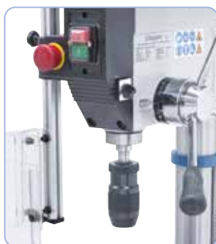
W wyposażeniu seryjnym uchwyt szczękowy szybkoomocujący 1 - 16 mm / B 16
