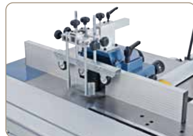
Kopuła ochronna frezarki jest wyposażona w anodizowane aluminiowe szyny oporowe
