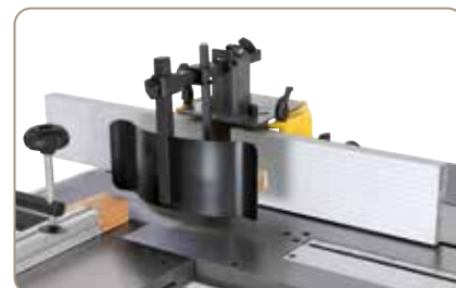
Ograniczniki kopuły ochronnej frezarki można szybko i łatwo ustawić na konkretny frez. Standardowe zabezpieczenie chroni przed odrzucaniem przedmiotów
