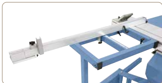
Stół wysięgnikowy do obrabiania dużych płyt
