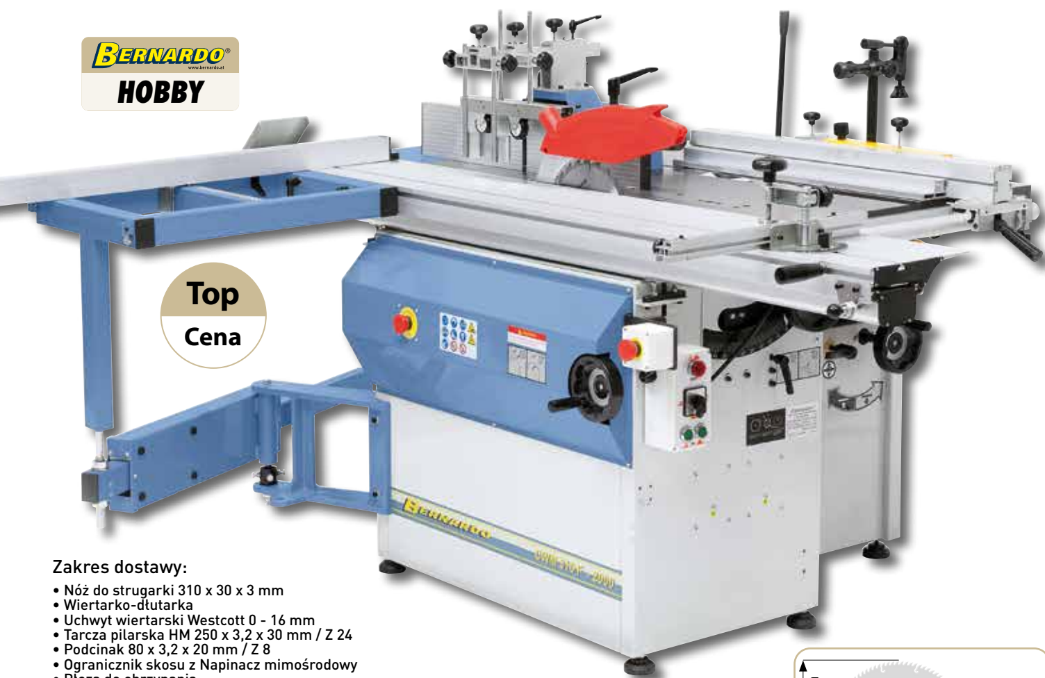
Stół wysięgnikowy do obrabiania dużych płyt
