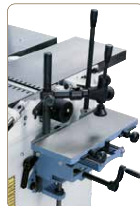
Wiertarko-dłutarka z dużym stołem i napinaczem mimośrodowym w wyposażeniu standardowym
