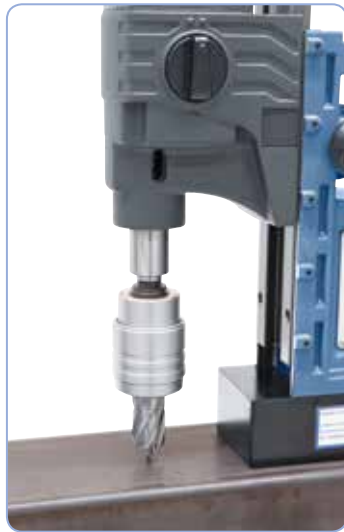
Wiercenie rdzeniowe z uchwytem szybkościowym
