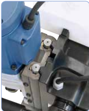
Chroniony patentem system prowadzenia dla zwiększenia stabilności.
