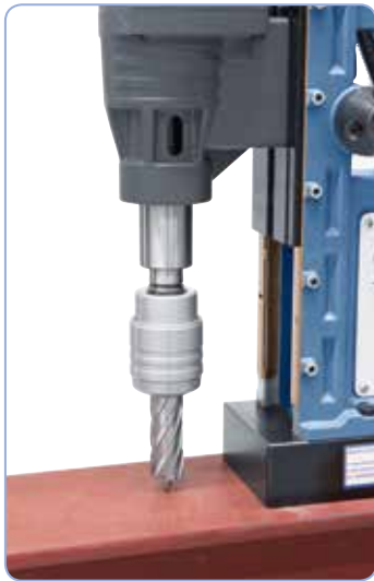
Wiercenie rdzeniowe z uchwytem szybkowymiennym
