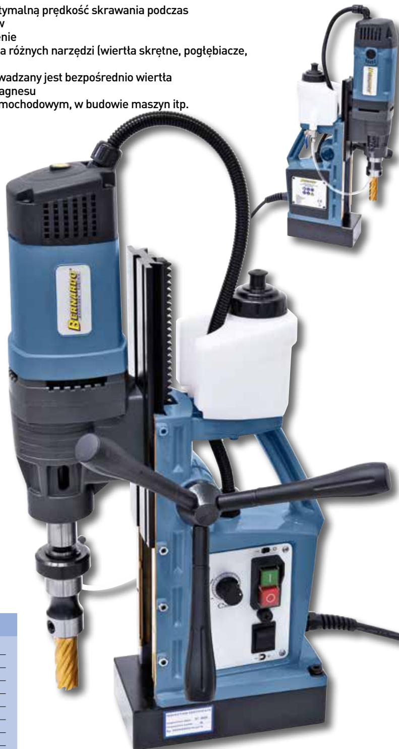
Dokładne ustawienie maszyny na elemencie obrabianym dzięki standardowej libelli okrągłej.
