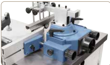
Masywny ogranicznik można używać do narzędzi frezarskich o rozmiarze do 200 mm. Obustronne szyny oporowe w wyposażeniu standardowym z precyzyjną regulacją
