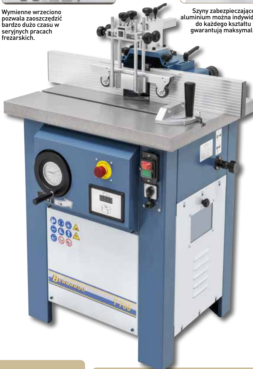
Masywny ogranicznik można używać do narzędzi frezarskich o rozmiarze do 200 mm. Obustronne szyny oporowe w wyposażeniu standardowym z precyzyjną regulacją.
