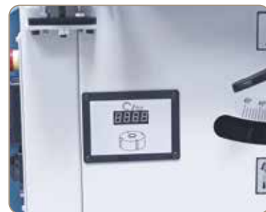
Elektroniczny wskaźnik ustawionej prędkości frezowania
