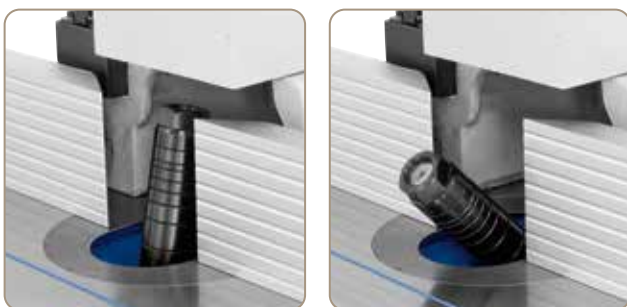
Wrzeciono frezarskie wychylne w zakresie od -10^{\circ} do +45^{\circ} i regulowane na wysokość 180 mm
