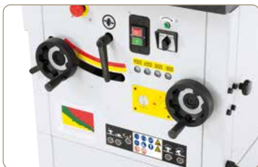
Intuicyjnie obsługiwane elementy przełączające i obsługowe, elektroniczny wskaźnik prędkości obrotowej
