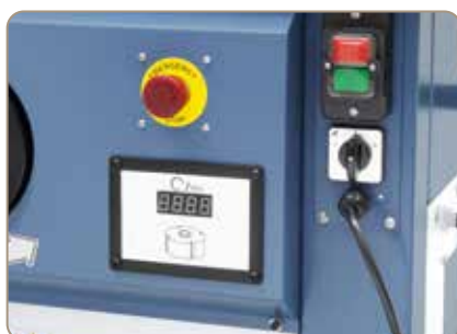
Elektroniczny wskaźnik ustawionej prędkości frezowania.
