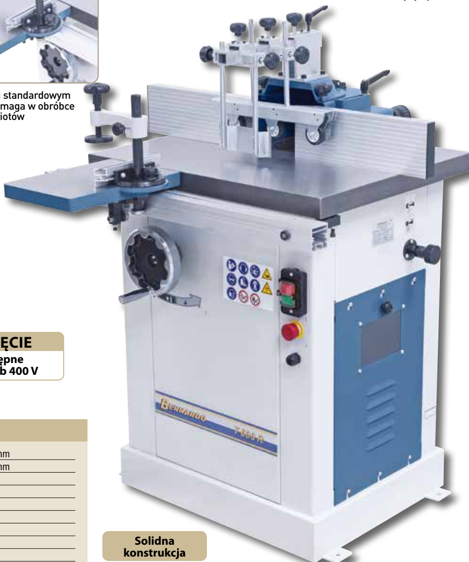
Kopuła ochronna frezarki jest wyposażona w anodyzowane aluminiowe szyny oporowe
