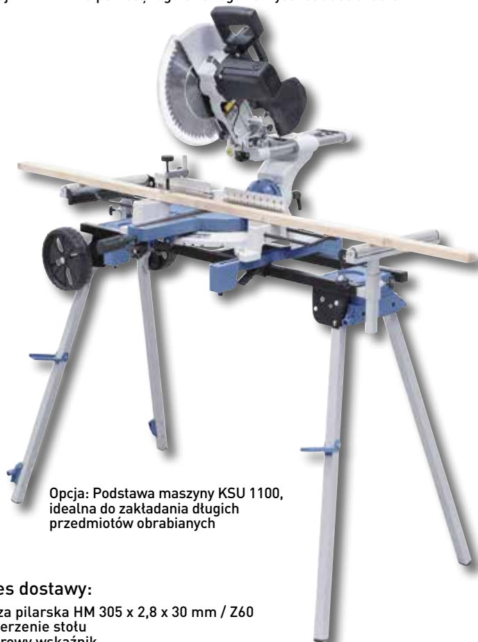
Skuteczne unieruchomienie przedmiotu obrabianego za pomocą regulowanego na wysokość dociskacza.
