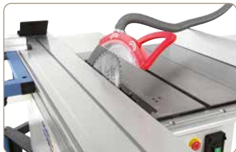
Tarczę pilarską można ustawiać pod kątem w zakresie od 90° do 45°.
