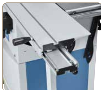
Hartowana prowadnica pryzma-tyczna zapewnia swobodny posuw stołu formatowego
