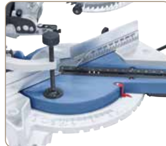
Talerz obrotowy wychyłany w zakresie 45° w prawo / w lewo z możliwością blokady pod kątem 0° / 15° / 22,5° / 31,6° / 45°
