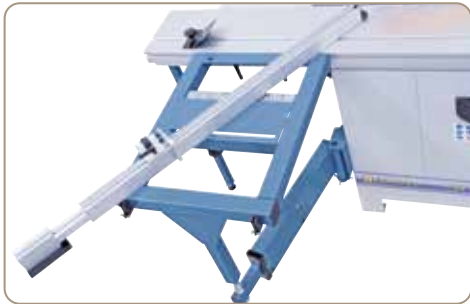
Wychylny bezstopniowo ogranicznik teleskopowy (2 x 45°), montowany na ramie do obrzynania z przodu lub z tyłu
