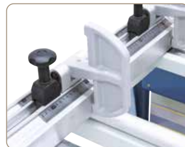
Stół wysięgnikowy można przesuwając na całej długości sanii i zdejmować w dowolnym położeniu. Precyzyjnie regulowany wyciągany ogranicznik teleskopowy z 2 maszynowymi składanymi ogranicznikami.
