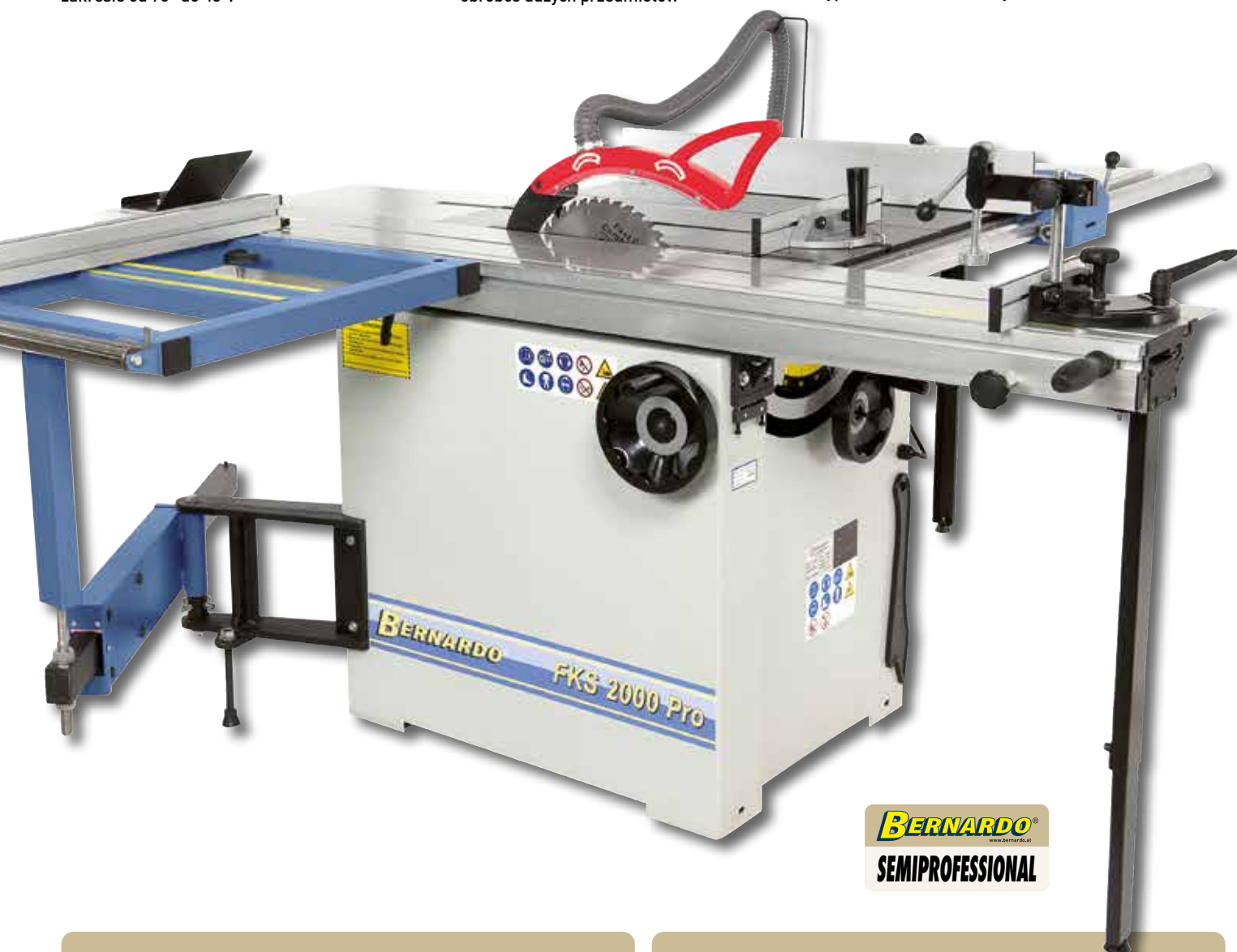
Tarczę pilarską można ustawiać pod kątem w zakresie od 90° do 45°.
