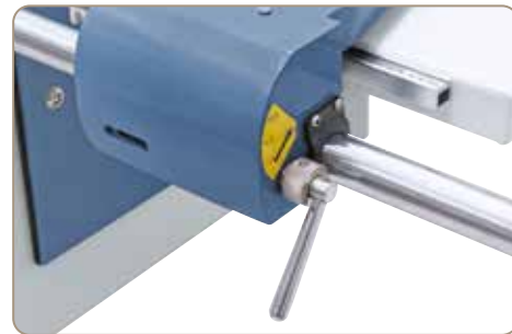
Regulowany ogranicznik równoległy ze skalą umożliwiającą obróbkę do szerokości 1295 mm
