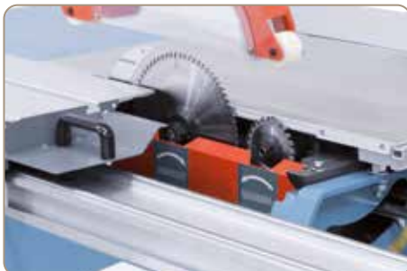
W wyposażeniu standardowym agregat wstępnego frezowania
