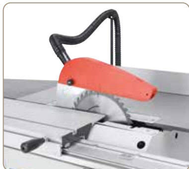
Ostona tarczy pilarskiej ze zintegrowanym króćcem odsysania przymocowana do klina rozdzielnika
