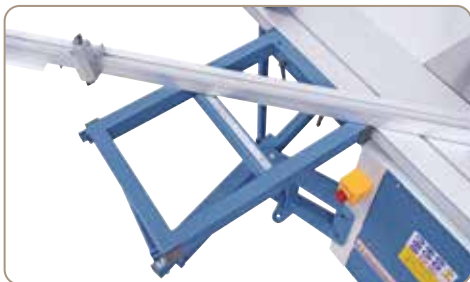
Duży stół wysięgnikowy do obrabiania dużych płyt
