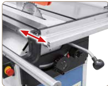
Cięcie pociągowe ułatwiają obróbkę dłuższych przedmiotów obrabianych
