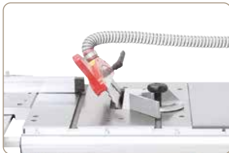
Łatwiejsze prowadzenie przedmiotu obrabianego dzięki wychylnej w lewo tarczy piłarskiej.
