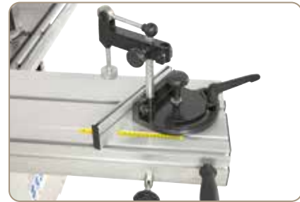
Wbudowana w stół skala umożliwia dokładne ustawienie ukosu.
