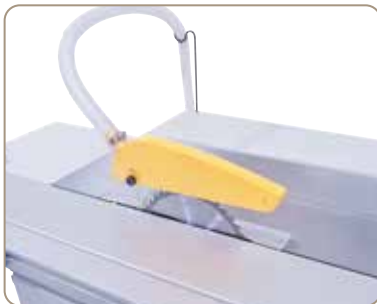
Osłona tarczy pilarskiej ze zintegrowanym króćcem odsysania przymocowana do klina rozdzielnika
