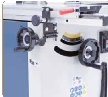
Ergonomicznie rozmieszczone koła ręczne do regulacji położenia agregatu pilarskiego
