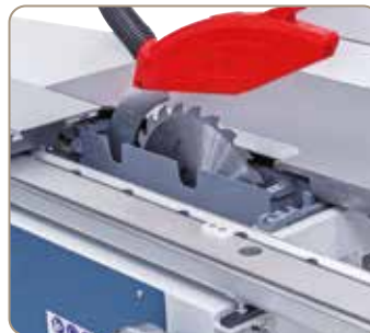
Stabilny agregat pilarski z obustronnie prowadzonymi elementami wychyłnymi z szarego żeliwa
