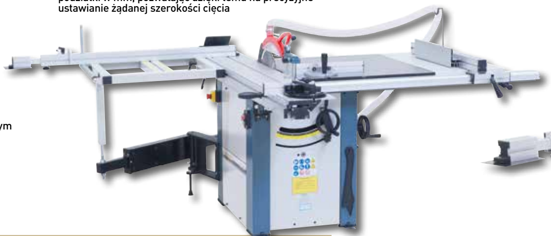
Lupa w ograniczniku wzdłużnym ułatwia odczytywanie podziałki w mm, pozwalając dzięki temu na precyzyjne ustawianie żądanej szerokości cięcia
