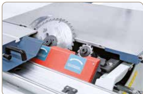
Stabilny agregat pilarski z obustronnie prowadzonymi elementami wychylnymi z szarego żeliwa
