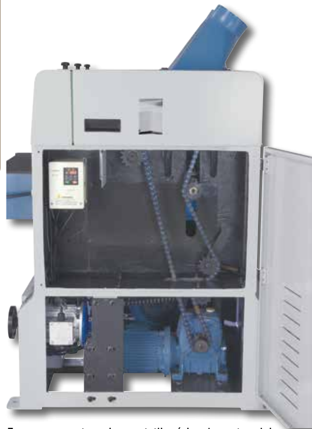
Za pomocą przetwornicy częstotliwości można optymalnie dostosowywać prędkość posuwu walca wciągającego i wyciągającego do obrabianego przedmiotu
