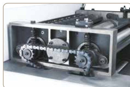
Walec wciągający i wyciągający napędzane równo za pomocą napędu łańcuchowego
