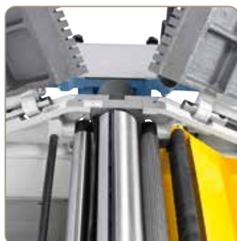
Precyzyjnie ułożony wał 4-nożowy i wałek wciągający z prostymi zębami zapewniają optymalne rezultaty strugania
