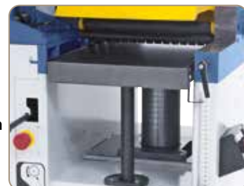
Stabilny stół grubościówki z prowadnicą kolumnową i podparciem zapewnia precyzyjne struganie desek, listew, bali,...
