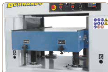
Masywny stół grubościówki wykonany z szarego żeliwa, ustawiany silnikowo na wysokość w zakresie 4 - 300 mm. Do regulacji wysokości służą 4 duże śruby
