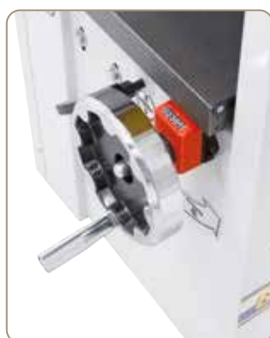
Wysokość stołu grubościówki ustawia się za pomocą cyfrowego wskaźnika z dokładnością do 0,1 mm
