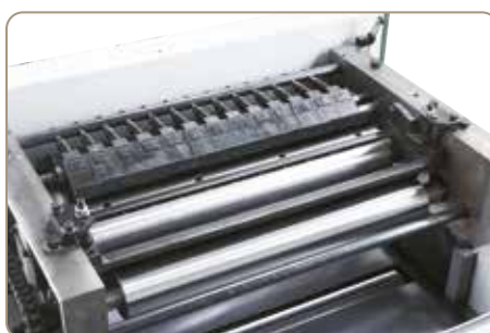
Masywny agregat strugania w wałem 4-nożowym o grubości 120 mm gwarantuje precyzyjną pracę bez względu na obciążenie
