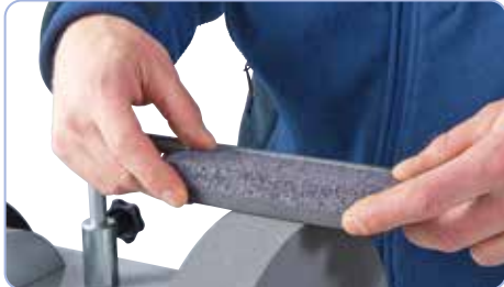
05-2050 Slijpsteen: dient voor het prepareren van de slijpschijven (fijn/grof)
