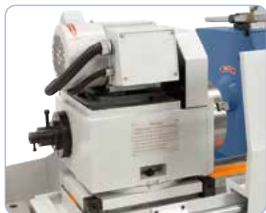
Draaibare spindelkop van 0° - 90° voor conisch slijpen.
