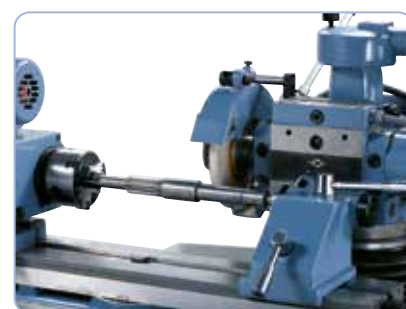
Extern cilindrisch slijpen
