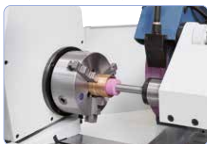
Standaard met wegklapbare innerslijpinrichting
