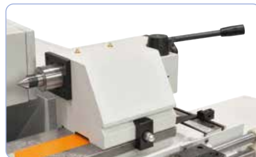
Hydraulische rijstok met hoge nauwkeurigheid en stabiliteit, via voetpedaal verplaatsbaar
