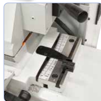
Voor conisch slijpen tussen de punten kan de tafel tussen +3° en -9° worden gedraaid.
