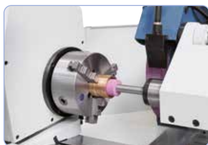
Standaard met wegklapbare innerslijpinrichting
