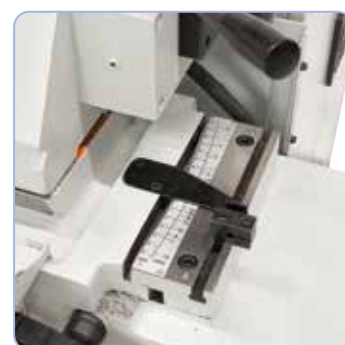
Voor conisch slijpen tussen de punten kan de tafel tussen +3° en -7° worden gedraaid.
