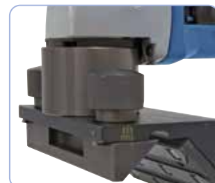
Traploze instelling van de afkantbreedte door middel van verstelbare aanslagbalk.
