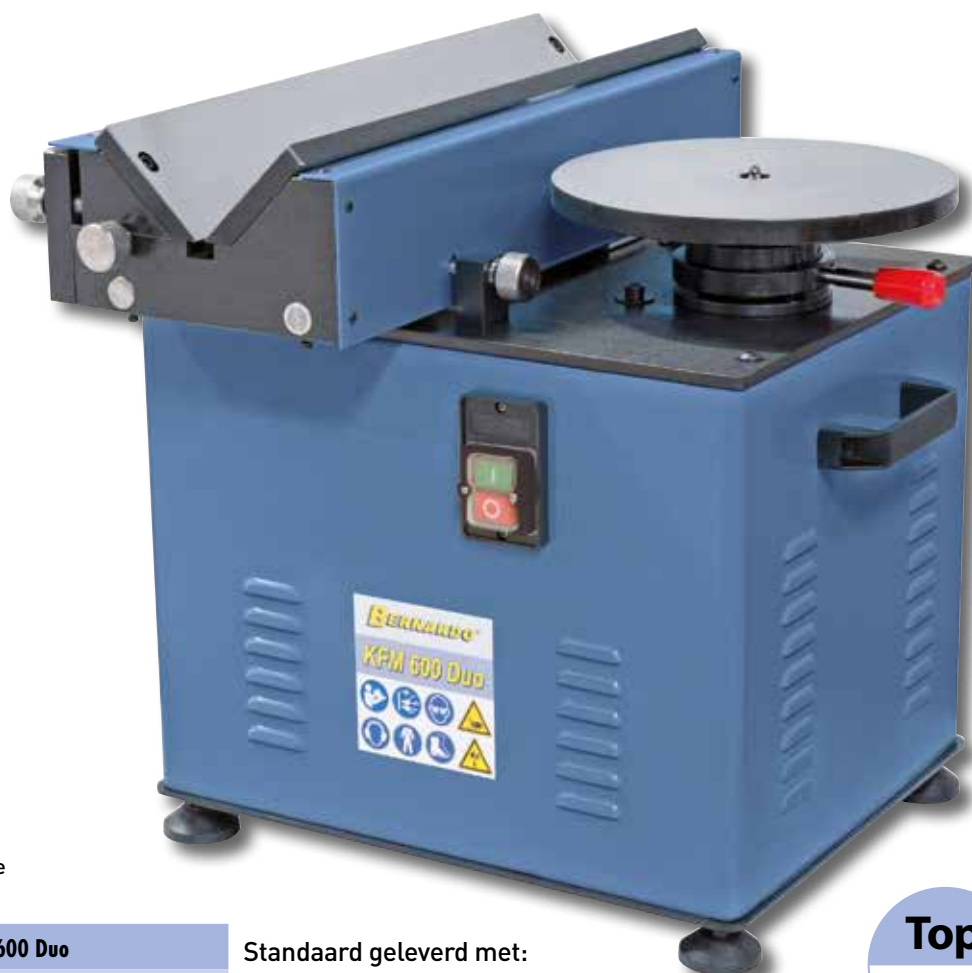
Eenvoudig verstellen van de afkantbreedte door verplaatsbare aanslagbalk.
