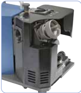
Slijpen van de vrije hoek bij frezen met 2 snijkanten
