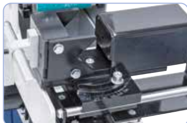
De aflezing van de gewenste hoeken gebeurt via een schaalverdeling
