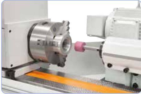
Standaard met binnenslijpinrichting
