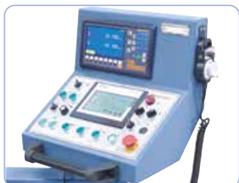
2-assige digitale meter met LCD-scherm is inbegrepen bij levering.
