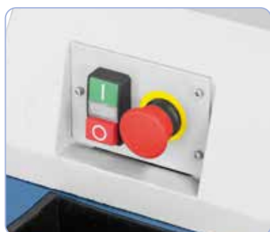
Aan- uitschakelaar met onderspanningsbeveiliging en noodschakelaar
