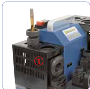
1. Teruglijpen van de vrije hoek \varnothing 2 - 13 mm 2. Teruglijpen van de vrije hoek \varnothing 8 - 32 mm
