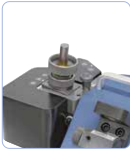
Slijpen van de snijkanten 1 en 3
