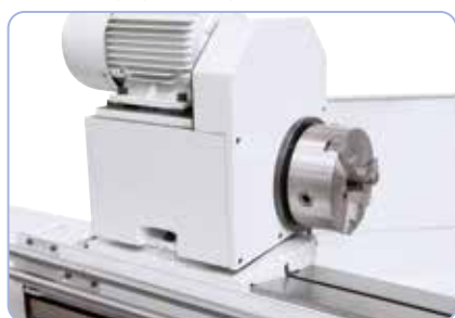
Zwenkbare spindelkop van +30° tot -30°, met traploze toerentalverstelling
