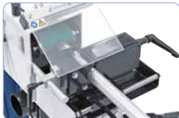
Gecombineerde werkstuklem voor het inspannen van buizen en profielen
