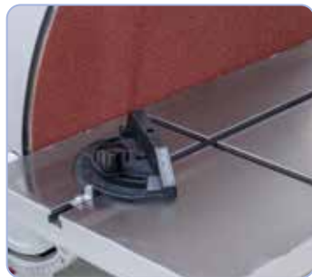
Inclusief versteekaanslag voor nauwkeurig hoek slijpen.
