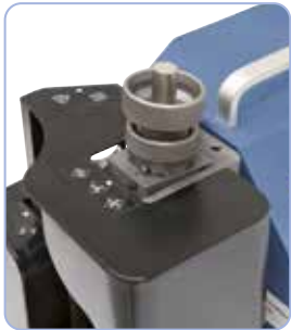
Slijpen van de snijkanten 1 en 3
