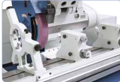
Voor het stabiliseren van lange werkstukken standaard met een gesloten of 2 open brillen uitgevoerd
