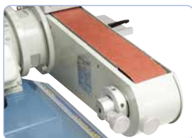
Groot vlaklijpoppervlak met werkstukaanslag
