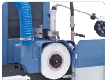
Handmatige parallelle aftrekinrichting met micrometerinstelling wordt meegeleverd
