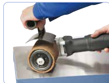
Optioneel met rubberen wielen, de lucht past zich aan het oppervlak van het werkstuk aan.
