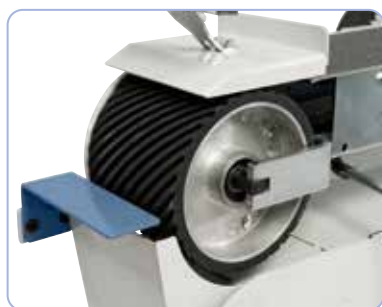
Contactrol 70° - 74° Shore A, optimaal voor schrobbewerking
