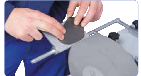
05-2056 Oplegtafel: Optimaal voor het slijpen van diverse kleine delen
