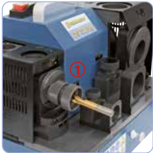
1. Slijpen van de punthoek \varnothing 2 - 13 mm 2. Slijpen van de punthoek \varnothing 8 - 32 mm
