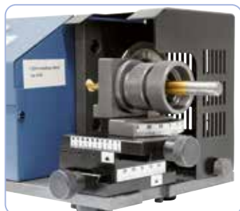
Instelbare slijphoek van -30^\circ tot +30^\circ .
