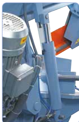
Stabiele hydraulische cilinder voor het fijngevoelig neerlaten van de zaagbeugel.
