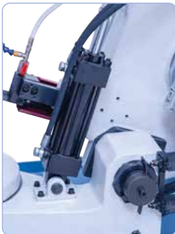
Standaard met hydraulische neerlaatcilinder voor traploos neerlaten van de zaagbeugel en automatische eindafslag na het doorzagen
