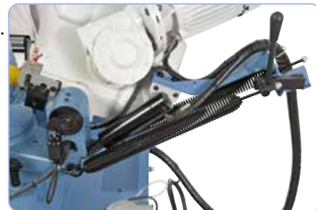
Trekveer met instelhendel voor het omschakelen naar handmatig gebruik
