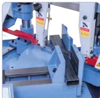
Zwenkbare zaagbeugel voor verstekzagen van 90° tot +45°
