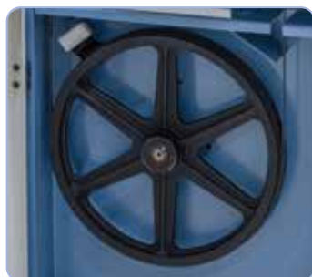
Het aandrijf wiel met speciale rubberen banden zorgt voor een rustige loop en verhoogt de levensduur van de zaagband
