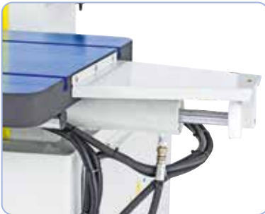
Hydraulische cilinder voor tafelverplaatsing
