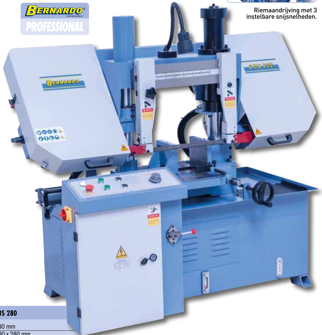
De verstelbare zaagbladgeleider voorkomt dat het zaagblad zijwaarts loopt of kantelt.
