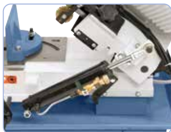
Standaard met hydraulische cilinder voor traploos neerlaten van de zaagbeugel
