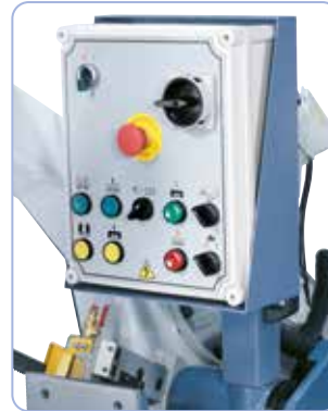
Overzichtelijk aangebrachte schakelementen aan de zwenkbare bedientafel
