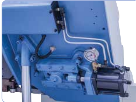
Standaard uitgerust met hydraulische bladspanning NC Pro
