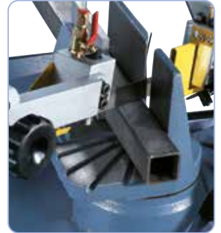
De zaagbeugel kan voor verstekzagen van 90° tot 60° versteld worden
