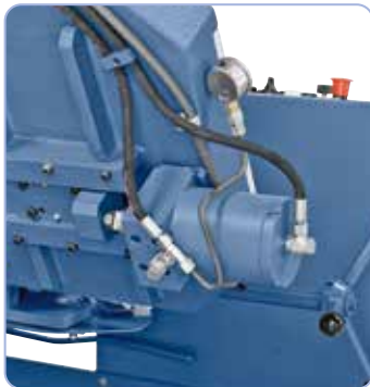
Optioneel met hydraulische zaagbandspanning leverbaar
