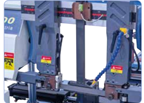
De verstelbare zaagbladgeleider voorkomt dat het zaagblad zijwaarts loopt of kantelt.
