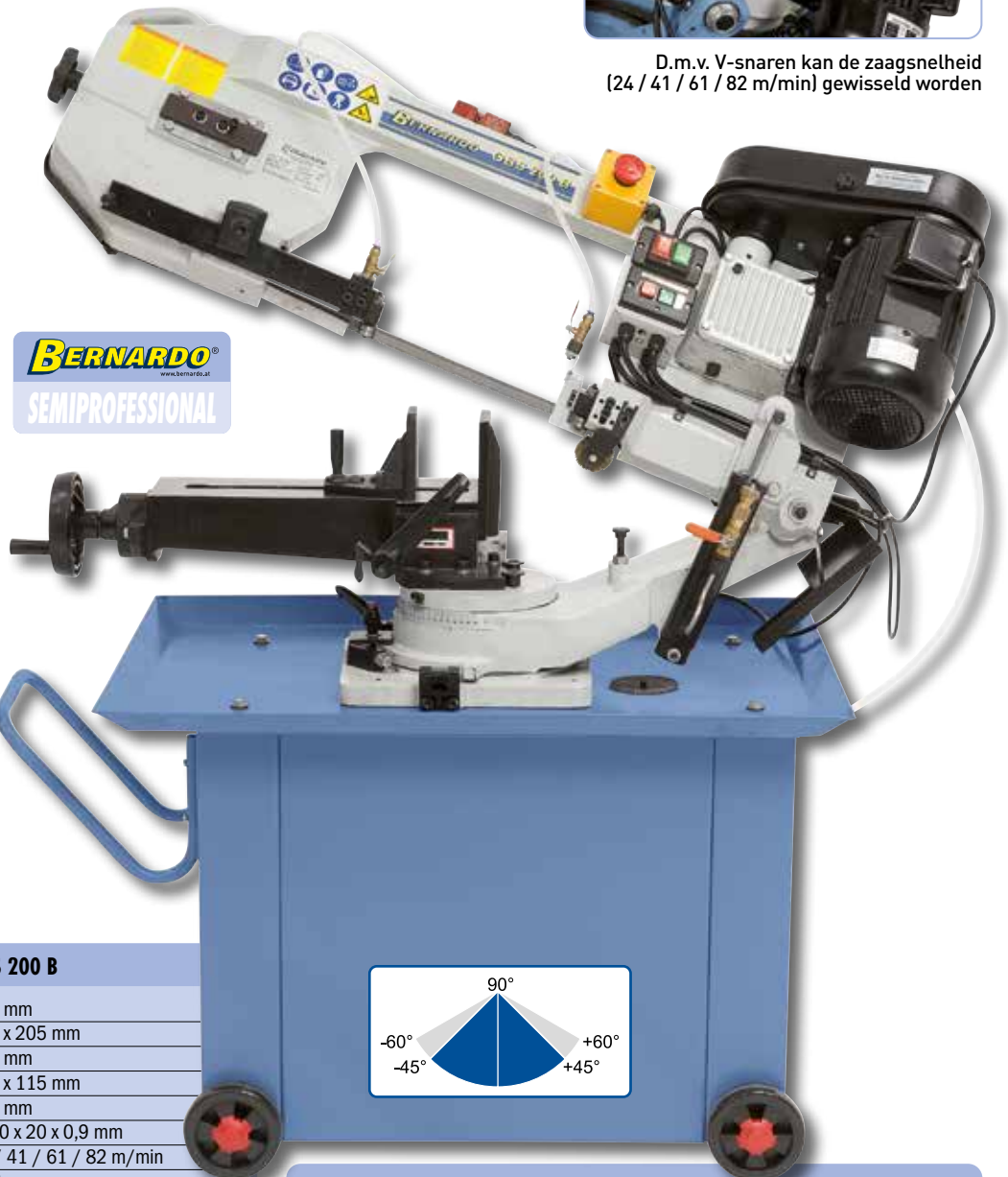
Zwenkbare zaagbeugel voor verstekzagen van -45^\circ tot +45^\circ verstelbaar
