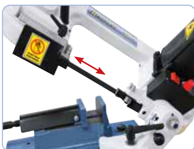
Zaagbladgeleiding kan worden aangepast aan de materiaalbreedte
