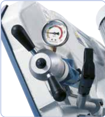
Controle van de zaagbandspanning d.m.v. manometer
