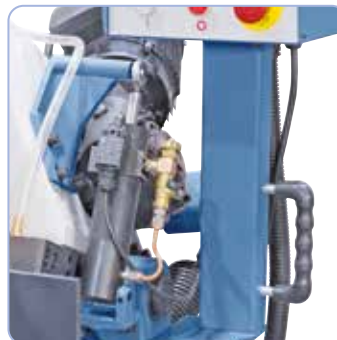
Groot bemeten hydraulische cilinder voor traploze neerlaat van de zaagbeugel
