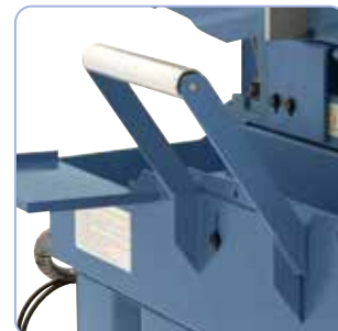
Standaard met roloplegger voor het steunen van werkstukken
