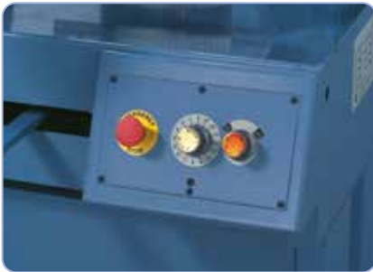
Comfortabel instellen van de zaagdruk d.m.v. regelventiel
