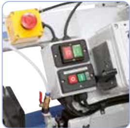
Centrale indeling van de schakel-elementen aan de zaagbeugel
