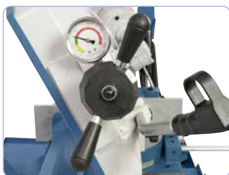
De standaard manometer maakt een optimaal instellen van de zaagbandspanning mogelijk
