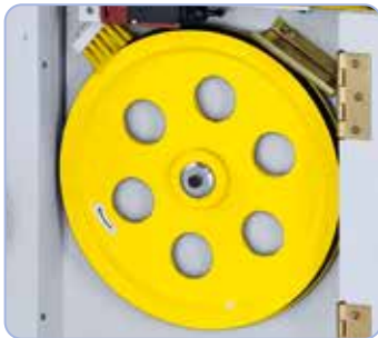
De dynamische aandrijfwielen uit gietstaal zorgen voor een rustige loop van de machine
