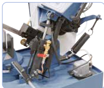
Hydraulische cilinder voor traploos neerlaat van de zaagbeugel
