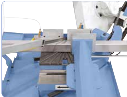
Materiaalklem met snelklemming voor dubbelverstekzagen verschuifbaar
