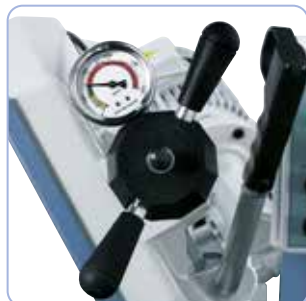
Controle van de zaagbandspanning d.m.v. manometer
