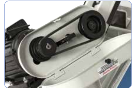
D.m.v. V-snaren kan de zaagbandsnelheid snel en makkelijk gewisseld worden
