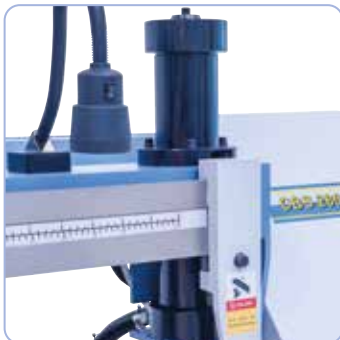
Stabiele hydraulische cilinder voor het fijngevoelig neertlaten van de zaagbeugel.
