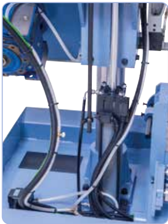
Stabiele hydraulische cilinder voor het fijngevoelig neerlaten van de zaagbeugel.
