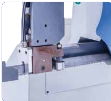
Gecombineerde rollen en hardmetalen geleiding voorkomt snel verslijten van de zaagband.
