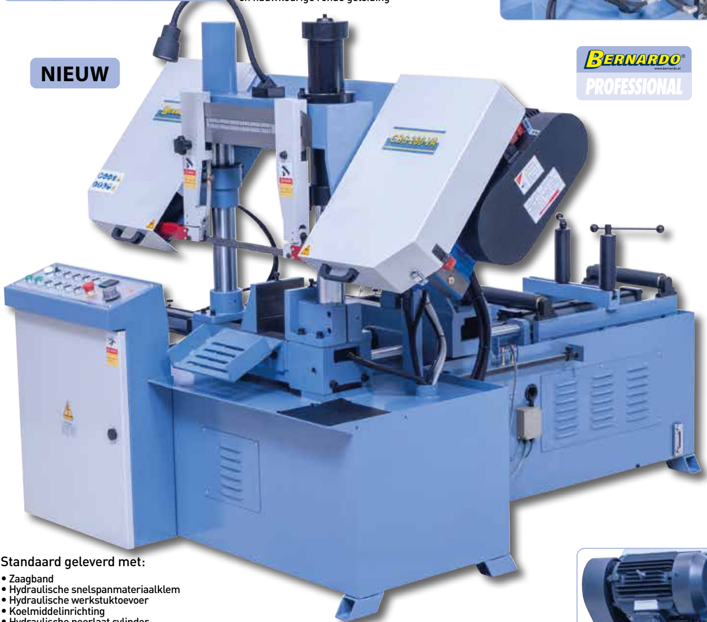
Materiaaltoevoer via hydraulische kleminrichting en nauwkeurige ronde geleiding
