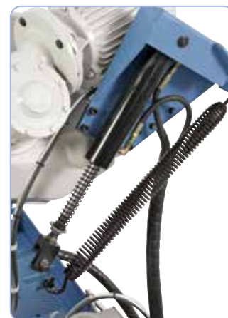
Standaard met hydraulische cilinder voor het fijngevoelig neerlaten van de zaagbeugel
