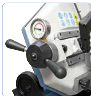
De standaard manometer maakt een optimaal instellen van de zaagbandspanning mogelijk
