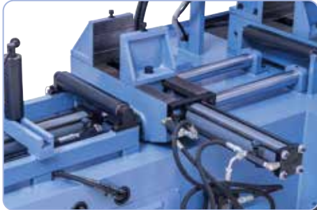
Materiaaltoevoer via hydraulische kleminrichting en nauwkeurige ronde geleiding
