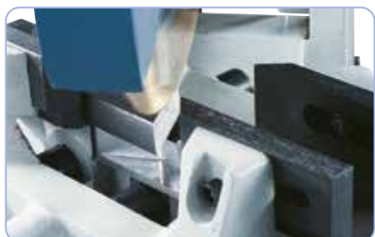
Zwenkbare aandrijfkop (45° links / rechts), optimaal voor verstekzagen
