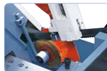
Kogelgelagerde zaagbandgeleiding en spanenborstel voor optimale zaagresultaten
