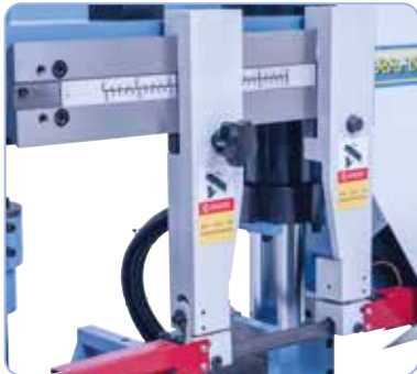
De verstelbare zaagbladgeleider voorkomt dat het zaagblad zijwaarts loopt of kantelt.
