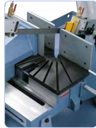
Snelspanmateriaalklem voor dubbelverstekzagen verschuifbaar
