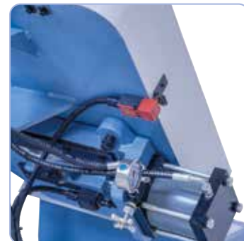
Standaard uitgerust met hydraulische zaagbladspanning
