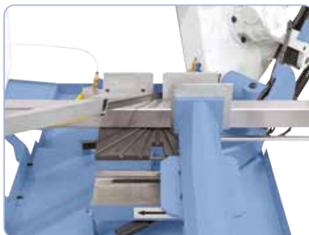
Materiaalklem met snelklemming voor dubbelverstekzagen verschuifbaar
