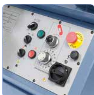
Comfortabel instellen van de neerlaatsnelheid door regelklep.
