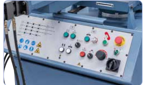
Draaischakelaar voor traploze zaagsnelheid en regelklep voor de oplegdruk op het ergonomisch gemonteerde bedieningspaneel
