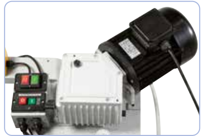
Aandrijving met geharde en geslepen wormas, het wormwiel is van brons
