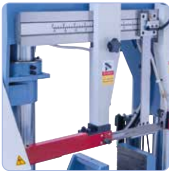
De verstelbare zaagbladgeleider voorkomt dat het zaagblad zijwaarts loopt of kantelt.
