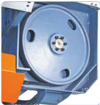
De dynamische loopwielen uit gietstaal zorgen voor een rustige loop
