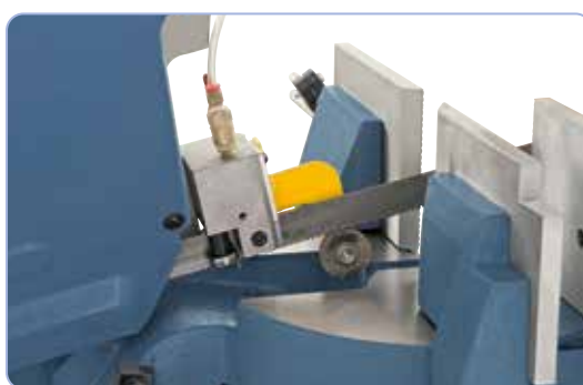
Gecombineerde rollen en hardmetalen geleiding voorkomt snel verslijten van de zaagband.
