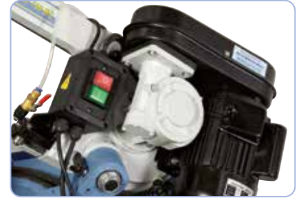
D.m.v. V-snaren kan de zaagsnelheid (24 / 41 / 61 / 82 m/min) gewisseld worden
