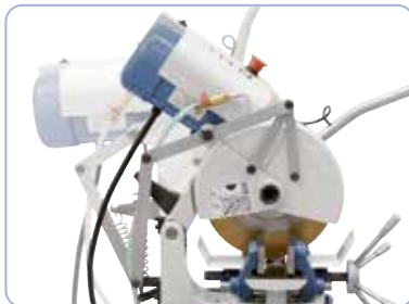
De beschermkap opent automatisch bij het neerlaten van de aandrijvingskop.
