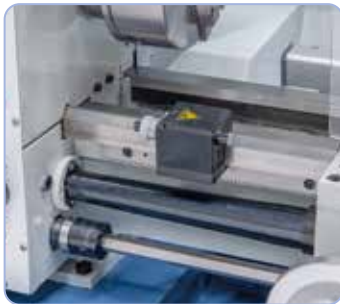
Micrometer-lengteaanslag en slipkoppeling meegeleverd
