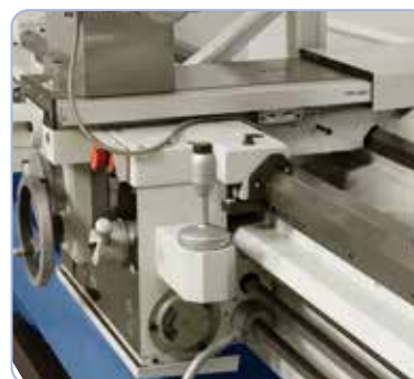
Inclusief snelgang voor de langs en dwars beweging over de sledes
