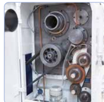
De geharde hoofdspindel met 130 mm spindelgat lagert op kegelrollagers en radiale rollagers.
