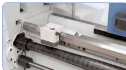
Micrometer-lengteaanslag en slipkoppeling meegeleverd
