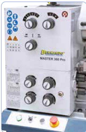
Overzichtelijk aangebrachte schakelementen in de aandrijfkop, geharde en geslepen tandwielen zorgen voor een rustige loop
