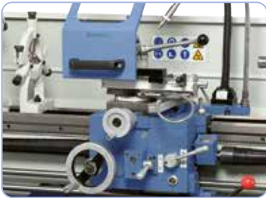
Licht lopende en exacte slede met bovenondersteuning en eenvoudige stalen houder, handwielen met instelbare metrische fijschaling
