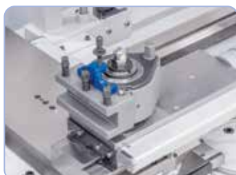
Voor economisch werken is de machine met een snelwisselbeitelhouder uitgerust.
