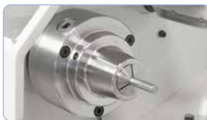
Optioneel leverbaar: spantangenhouder 5C, spanbereik 3-26 mm
