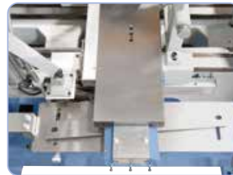
Kogeldraai-inrichting optioneel verkrijgbaar, draailengte 455 mm, instelhoek +/- 8°.
