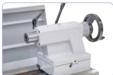
De robuuste losse kop met pinoleopname MK4 kan voor conisch draaien veresteld worden.
