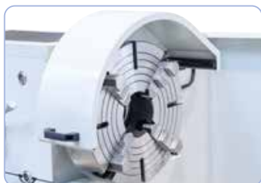
Klawuplaat 400 mm (optie) ideaal voor het opspannen van asymmetrische werkstukken
