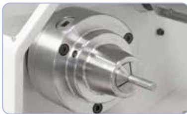
Optioneel leverbaar: spantangenhouder 5C, spanbereik 3-26 mm
