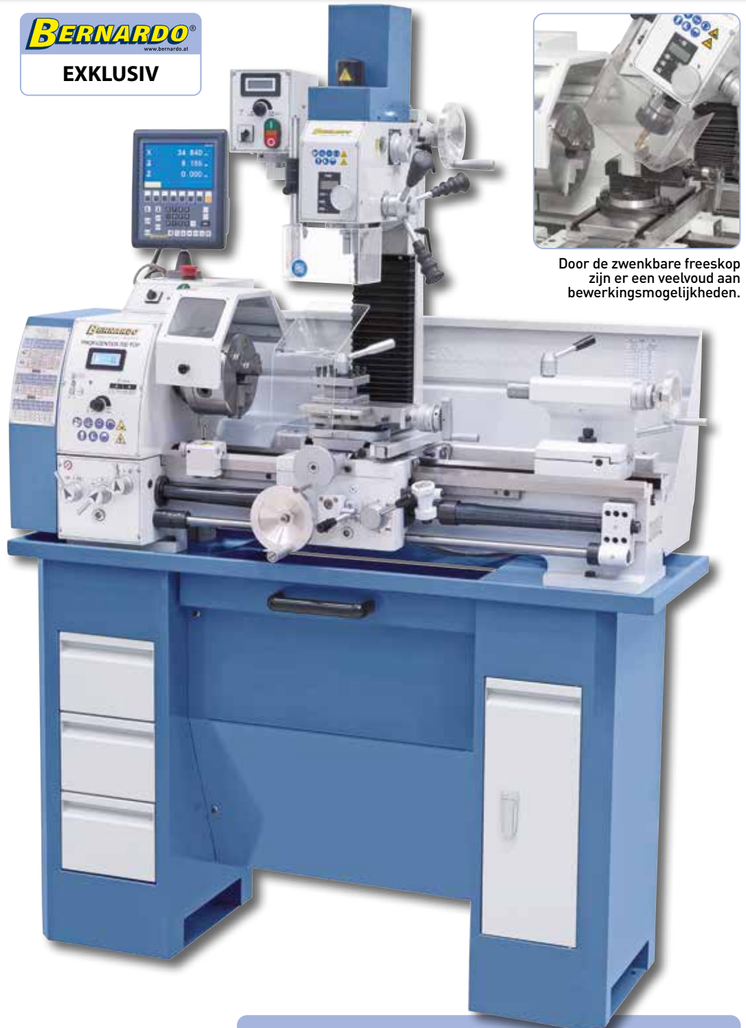
De losse kop met eenhendel klemming kan voor conisch draaien verschoven worden, naar wens met centreerkegel leverbaar.
