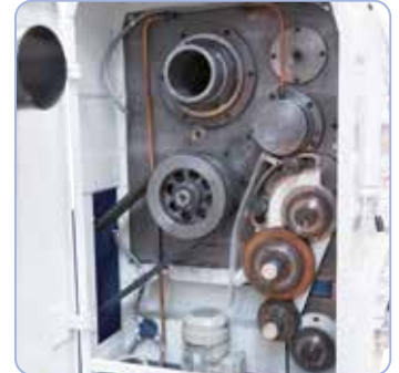
De geharde hoofdspindel met 130 mm spindelgat lagert op kegelrollagers en radiale rollagers.
