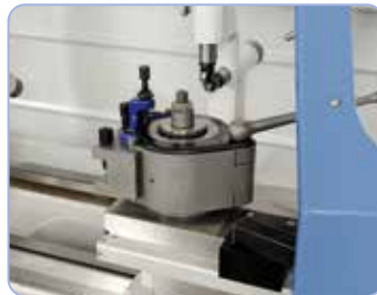
De snelwisselbeitelhouder maakt een reducering van de steltijden mogelijk en garandeert een hoge herhalingsnauwkeurigheid
