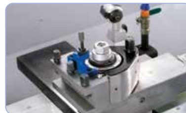
Het snelwisselsysteem met stalen houders Multifix verkort onderbrekingstijden en garandeert een hoge herhalingsnauwkeurigheid.
