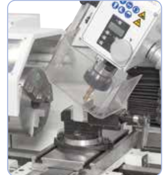
Door de zwenkbare freeskop zijn er een veelvoud aan bewerkingsmogelijkheden.
