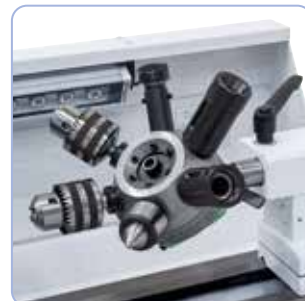
Voor economisch werken kan de machine met een revolverkop uitgerust worden
