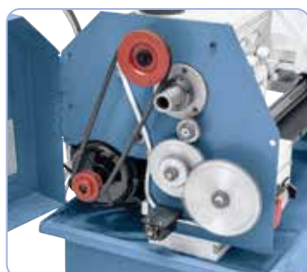
Standaard uitgevoerd met wisselwielen voor draadsnijden.
