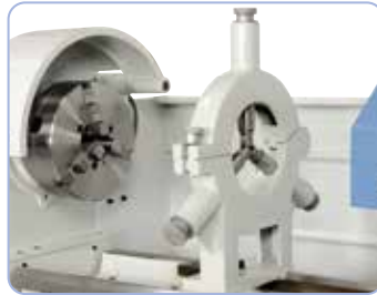
Vaste bril voor het ondersteunen van lange werkstukken
