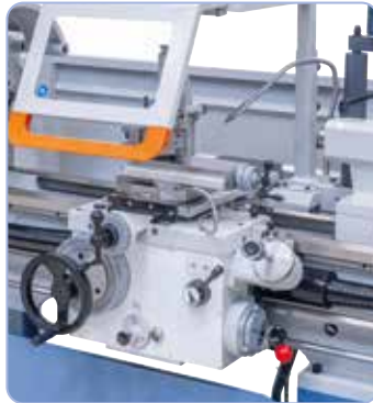
Voor de langs en dwars beweging van de sledes resp. van het bovensusport staan 42 vrij verkiesbare voedingen ter beschikking
