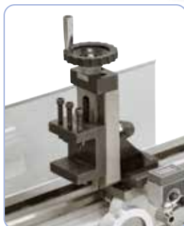
Verticale freessupport voor extra bewerkingsmogelijkheden.
