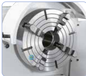
Klawplaat 400 mm (optie) ideaal voor het opspannen van asymmetrische werkstukken
