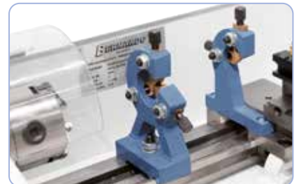
De brillen verlichten het bewerken van langere werkstukken
