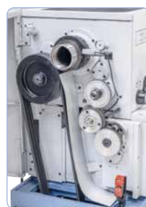
Geharde hoofdspindel met precisiekogellagers voor hoge ronddoerprecisie, optimale krachtoverbrenging door getande Optibelt-V-riemen
