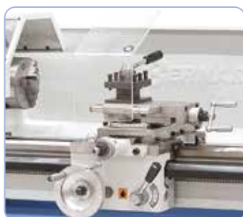
Lichtgangig en nauwkeurige sledes met bovensupport, lange levensduur door spelingsvrije nastelbare spiebanen
