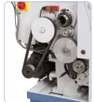
Geleverd compleet met wisselwielen voor schroefdraad snijden
