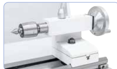
Voor universele inzet is optioneel een meelopende center type SMA met 7 uitwisselbare inzetten leverbaar.
