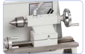
De losse kop met een hengselklemming kan voor kegeldraaien versteld worden.
