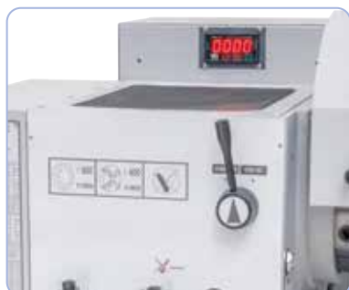
Electronische, traploze toerentalregeling, makkelijk afleesbaar d.m.v. digitale uitlezing
