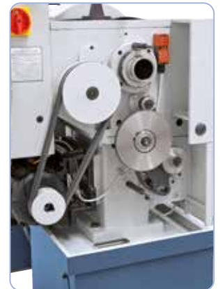
Standaard uitgevoerd met wisselwielen voor draadsnijden.
