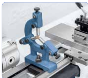
Vaste bril met bronzen geleiding voor het stabiliseren van lange werkstukken
