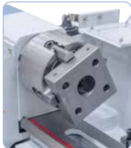
Klawplaat 100 mm (optie) voor het spannen van onregelmatig gevormde werkstukken
