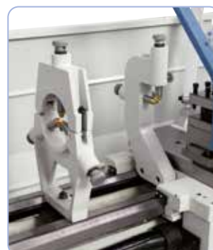
Het snelwisselsysteem met stalen houders Multifix verkort onderbrekingstijden en garandeert een hoge herhalingsnauwkeurigheid.
