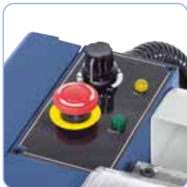
Traploze toerentalregeling van de hoofdspindel met potentiometer.
