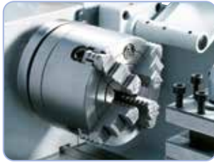
Klawwplaat 100 mm (optie) ideaal voor het opspannen van asymmetrische werkstukken
