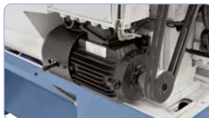
Krachtige aandrijfmotor met magneetrem volgens CE-norm
