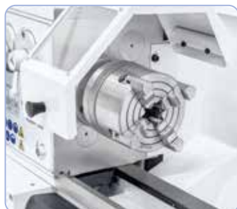
Klawwplaat 100 mm (optie) ideaal voor het opspannen van asymmetrische werkstukken
