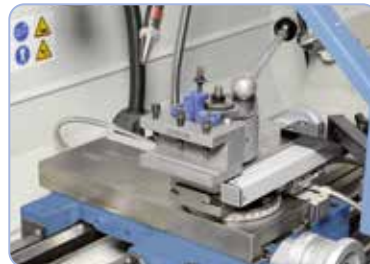
Snelwisselbeitelhouder systeem Multifix standaard meegeleverd. (Standard 165 Top)
