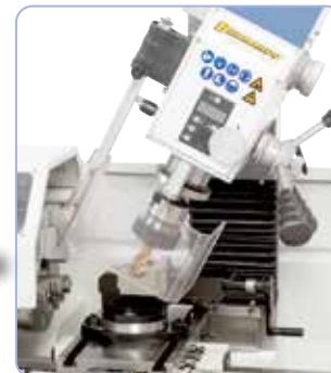
Door de zwenkbare freeskop zijn er een veelvoud aan bewerkingsmogelijkheden.
