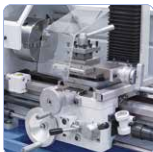
Sleden incl. handwielen met fjnschaalverdeling, ook met een automatische dwarsvoeding
