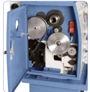
Geleverd compleet met wisselwielen voor schroefdraad snijden
