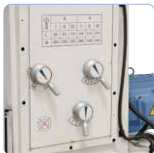
Logisch en overzichtelijk opgebouwd schakelsysteem voor horizontale spindel
