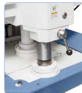
Manuele klemming in de z-as voor verhoogde stabiliteit.
