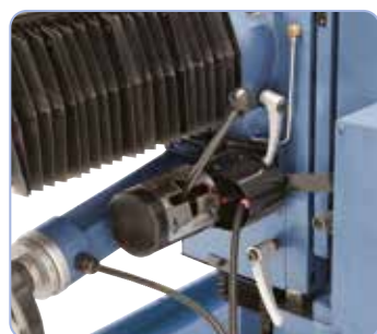
Keuzehendel voor toevoeras (afbeelding voor X- en Z-as), instellen van de toevoersnelheid d.m.v. potentiometer op het bedieningspaneel.
