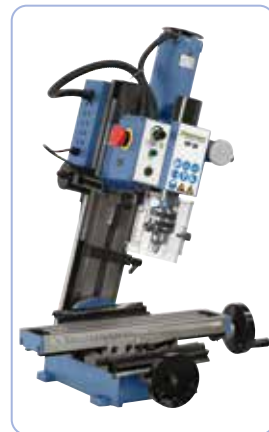
KF 20 met gedraaide freeskop voor groter inzetbereik (standaard)
