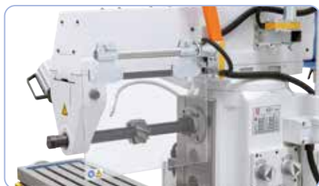
Om te frezen in horizontale positie standaard met tegenlagering en langere freesdoorn
