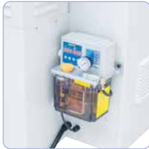
Electrische centrale smering standaard meegeleverd
