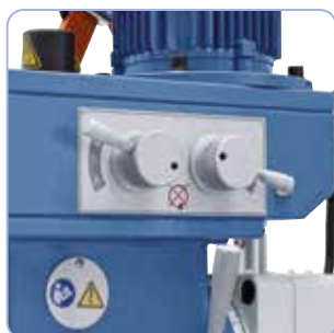
Makkelijke bediening van de schakелеlementen om het toerental te wisselen
