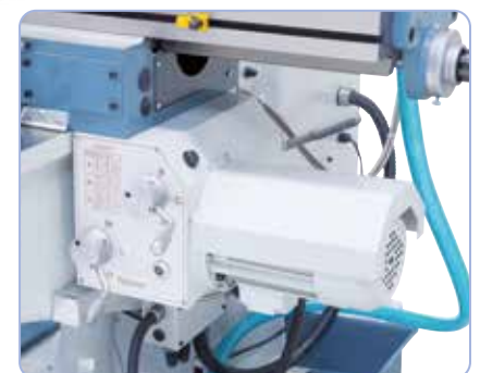
Standaard met 9 traps voeding in x- en y-as
