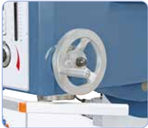
De pinoleoverbrenging (100 mm) gaat via een handwiel
