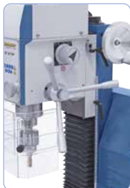
Grote stergreep voor makkelijke pinoleafstelling bij boren, handwiel voor fijnafstelling bij frezen.
