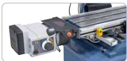
Voor verhoogd bedieningscomfort standaard met traploos regelbare freestafelvoeding (Art. nr. 02-10231 / 02-10240).
