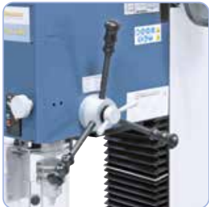
Grote stergreep voor makkelijke pinoleafstelling bij boren, handwiel voor fijnafstelling bij frezen.
