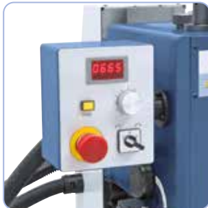
Standaard met digitale toerentalaflezing en rechts en linksloop inrichting.
