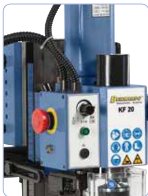
Toerentalregeling d.m.v. elektronische traploos regelbare gelijkstroommotor
