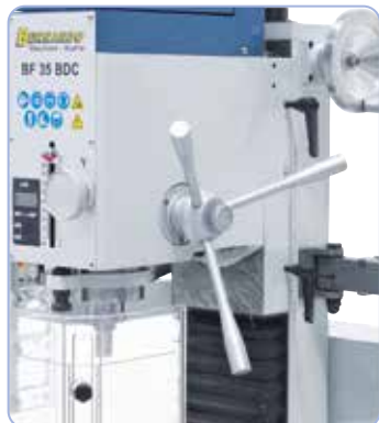
Grote stergreep voor makkelijke pinoleafstelling bij boren, handwiel voor fijnafstelling bij frezen.
