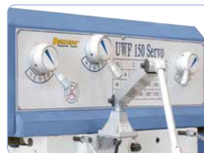
Makkelijke bediening van de schakelementen voor toerentalwissel
