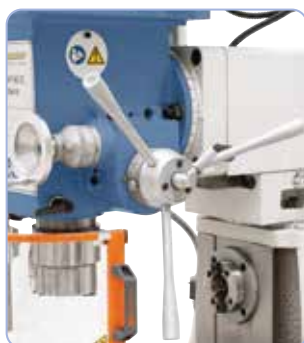
Pinolverstelling d.m.v. Handgreep, fijninstelling d.m.v. handwiel.
