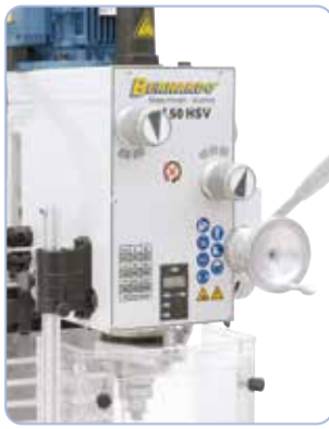
Makkelijke en snelle toerentalwissel d.m.v. schakelhendel.
