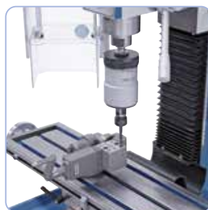
Voor tapwerkzaamheden kan de machine met een tapkop van M5 - M12 uitgerust worden
