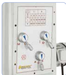
Logische en overzichtelijk opgebouwde aandrijfschakeling voor de toerental instelling
