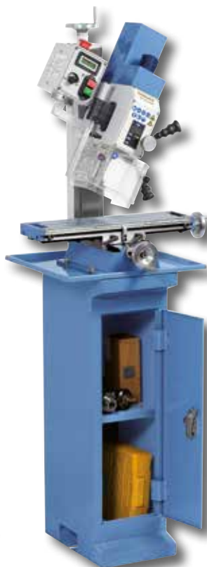
Afbeelding met onderstel BF 1 (optie) en gedraaide freeskop
