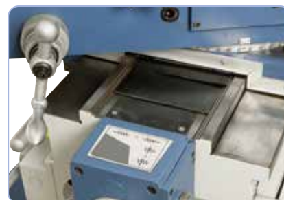
Groot bemeten vlakgeleidingen garanderen stabiliteit bij hoge freesbelasting, freestafel zwenkbaar van -45° tot +45°.
