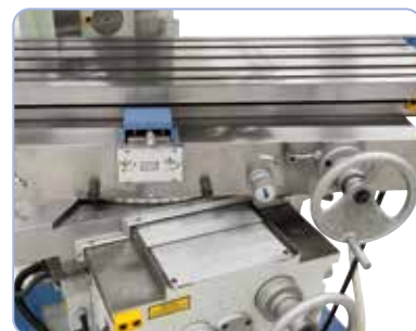
Verhoogd Bedieningscomfort door tafelverstelling in x-as d.m.v. handwiel aan de voorzijde van de machine
