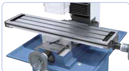
Nauwkeurig bewerkte kruistafel met 3 T-groeven
