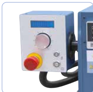
Standaard met digitale uitlezing en tapinrichting
