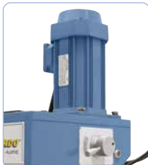
Makkelijke instelling van de versnelling d.m.v. vorkreuze schakelaar, instellen van het toerental d.m.v. potentiometer
