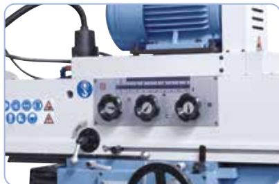
Eenvoudig instelbaar spindeltoerental op de bovenarm.
