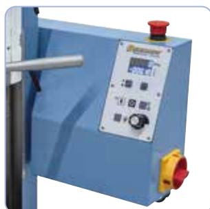
Gebruiksvriendelijke bediening via tiptoetsen. Standaard digitale toerental en boordiepteuitzetting
