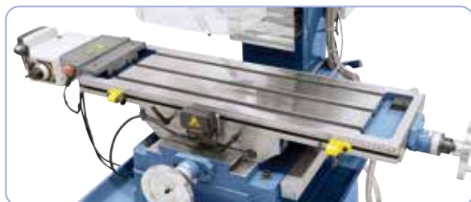
Standaard met traploze freestafelvoeding in de x-as met snelgang
