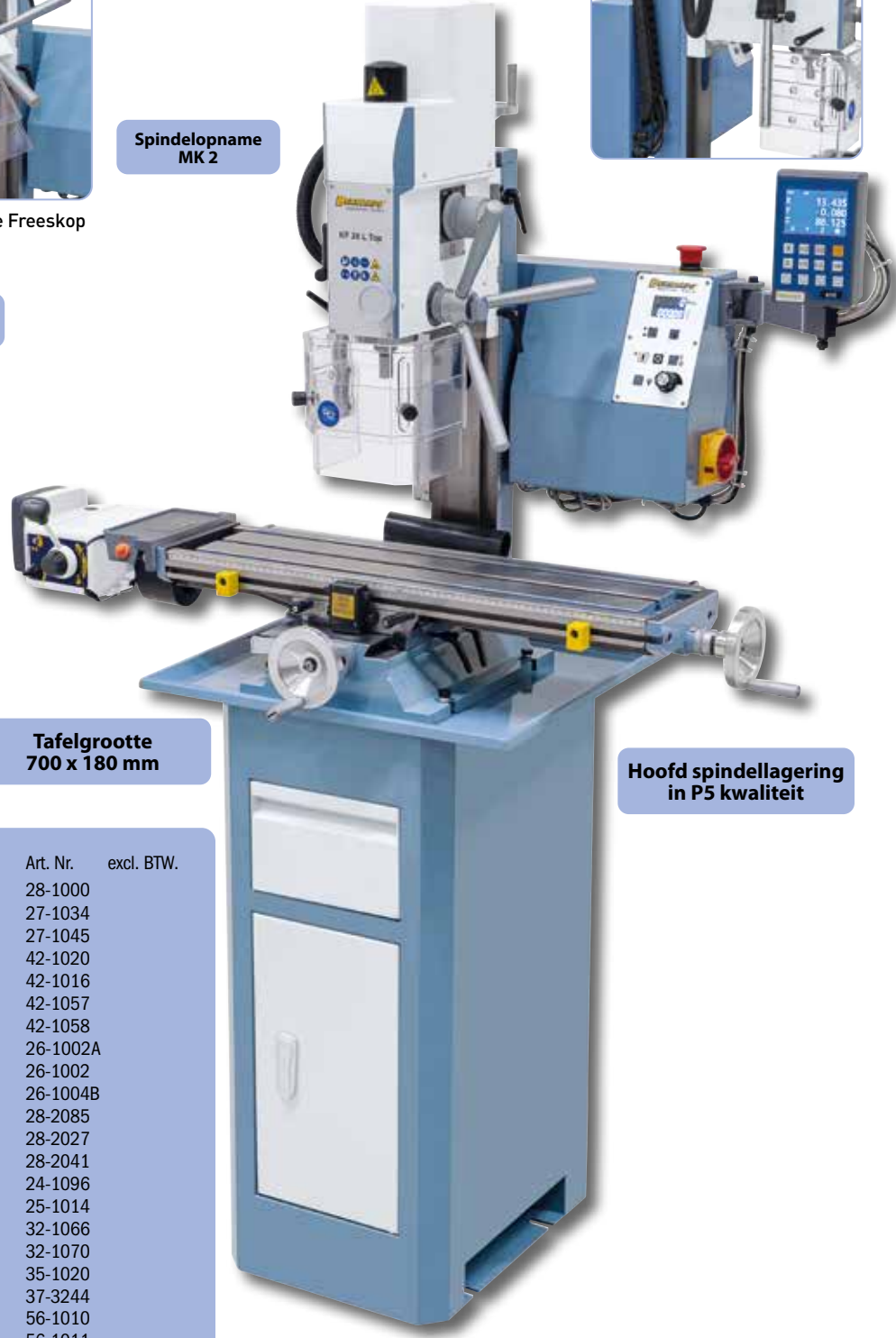
Voor verhoogd bedieningscomfort standaard met traploos regelbare freestafelvoeding (Art. nr. 02-10231 / 02-10240).
