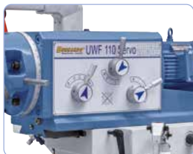
Makkelijke bediening van de schakel-elementen voor het wisselen van toerental.
