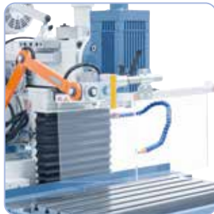
Verstelbare bescherming, te gebruiken voor zowel verticaal als horizontaal frezen.
