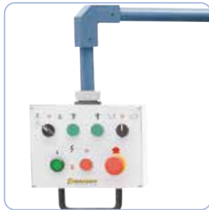
Zwenkbare bedieningstafel met ergonomisch aangebrachte schakelementen
