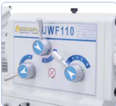
Makkelijke bediening van de schakelementen voor toerentalwissel
