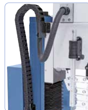
Inclusief kabelgeleiders via kabelrups
