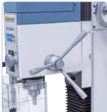
Grote stergreep voor makkelijke pinoleafstelling bij boren, handwiel voor fijnafstelling bij frezen.
