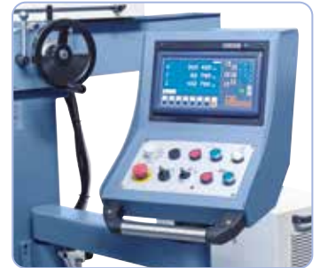
Overzichtelijk geplaatste schakelementen op het draaibare bedieningspaneel, standaard met 3-assige digitale meter met LCD-scherm.
