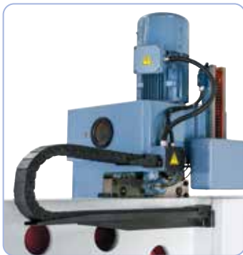
Contragewicht voor de nonius middels kettinggeleiding aan de achterzijde van de boorkop.
