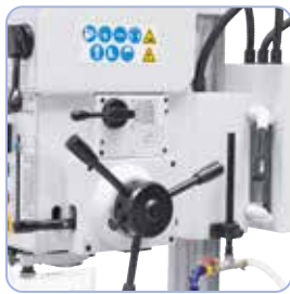
Standaard uitgerust met 3 automatische boorvoedingen.
