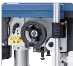
Zijdelings gepositioneerd handwiel voor het instellen van het gewenste toerental
