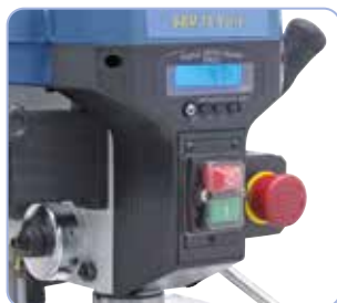
Standaard met digitale toerental- en boordiepte uitlezing
