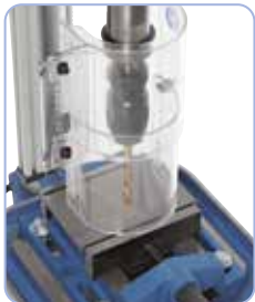
Zijdelings gepositioneerd handwiel voor het instellen van het gewenste toerental
