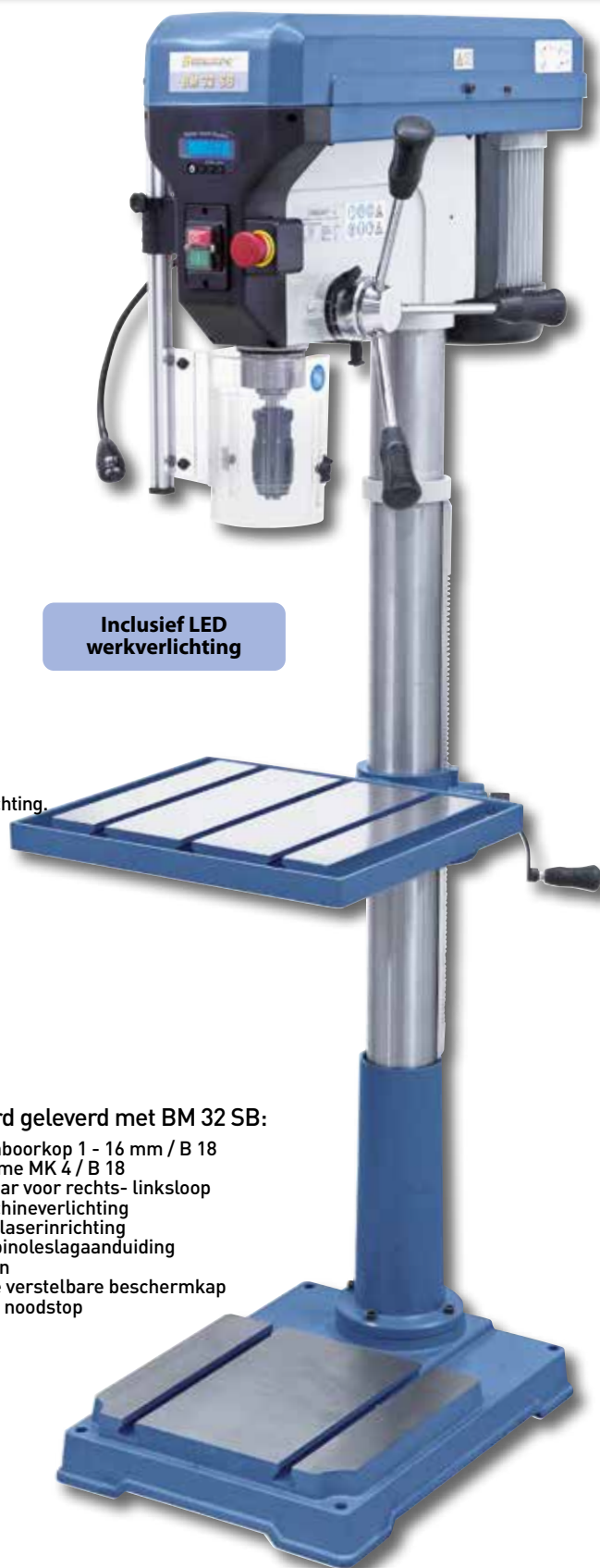
Digitale boordiepteaanduiding voor comfortabel werken.
