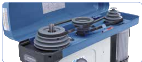
Hoogwaardige V-snaren zorgen voor een optimale krachtoverbrenging
