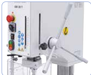
De pinole wordt aangestuurd door ergonomisch aangebrachte handgrepen
