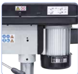
Sterke aluminium motor volgens IP 54
