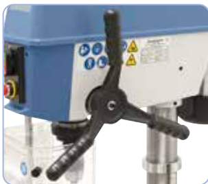
De pinole wordt aangestuurd door ergonomisch aangebrachte handgrepen.
