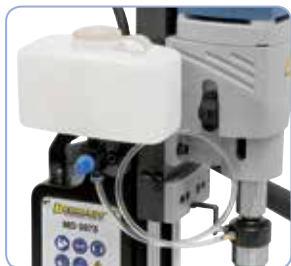
Automatisch binnensmering, het koelmiddel wordt direct op de punt van de kernboor geleid
