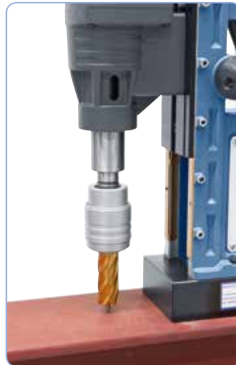
HSS-kernboor met TiN-laag
