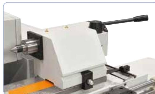
Contropunta idraulico con elevata precisione e stabilità, traslabile mediante pedali
