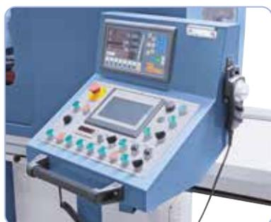
Include pannello Siemens SMART IE V3 con controllo a sfioramento e volantino elettronico
