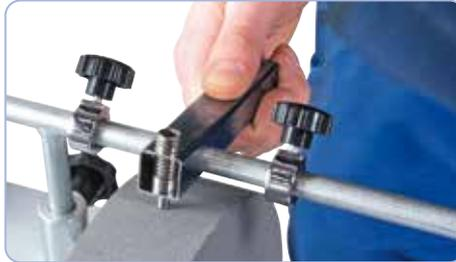
05-2058 dispositivo di estrazione diamante: per l'allineamento circolare e preciso dell'alesaggio della mola
