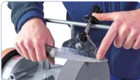
05-2057 dispositivo per coltelli: per coltelli con lama a partire da 100 mm di lunghezza, adatto anche per coltelli a petto
