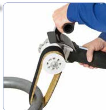
Con velcro opzionale per la ripassatura di ringhiere in acciaio inox già montate
