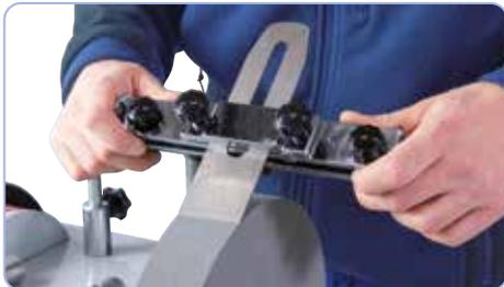
05-2054 dispositivo per taglio dritto: per ferro per pialle e ferro per scalpelli, larghezza max 70 mm, spessore max 6,5 mm
