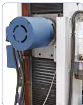
Guida piana rettificata per un preciso avvicinamento della testa di smerigliatura.
