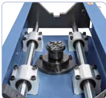
Guida a colonna rotonda per l'avanzamento uniforme della rotaia
