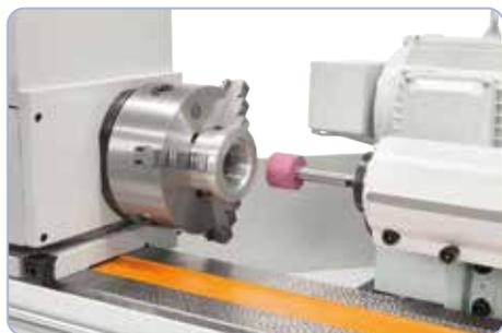
Dotato di dispositivo di smerigliatura interna
