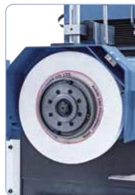
Funzionamento privo di vibrazioni ed elevata precisione del mandrino di smerigliatura mediante i cuscinetti speciali temperati
