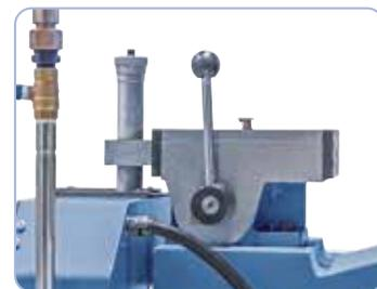
Dotato di dispositivo estrattore parallelo manuale
