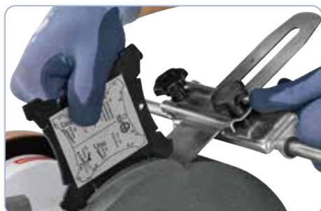
Semplice regolazione dell'angolazione ottimale mediante il misuratore angolo WL-60 (standard).
