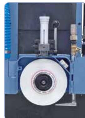
Funzionamento privo di vibrazioni ed elevata precisione del mandrino di smerigliatura mediante i cuscinetti speciali temperati
