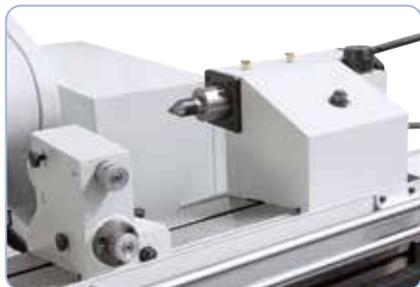
Contropunta idraulico con elevata precisione e stabilità, traslabile mediante pedali
