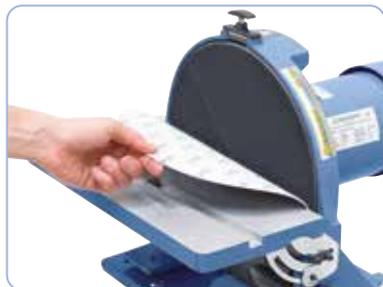
Appoggio in velcro incluso, ideale per la sostituzione del platorello (TS 300)
