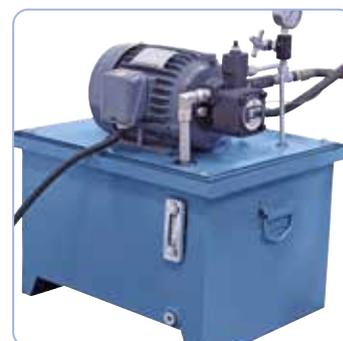
Unità idraulica separata evita vibrazioni e stress termici
