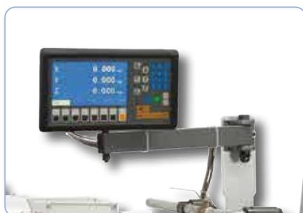
Il display di posizione a 2-assi di serie garantisce un funzionamento semplice e una maggiore precisione
