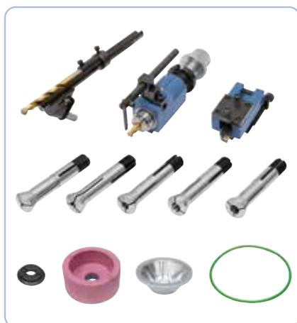
Dotazione: Supporto punte elicoidali, fresa con codolo e utensili di tornitura, pinze di bloccaggio, alesaggio della mola corindone, alesaggio della mola diamantata, cinghie di azionamento
