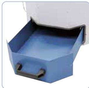
Semplice smaltimento della polvere di levigatura nella parte anteriore della macchina
