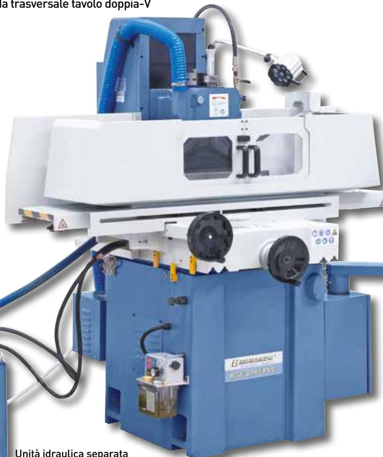
Unità idraulica separata evita vibrazioni e stress termici
