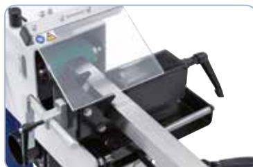
Morsa combinata per il serraggio di tubi e profilati
