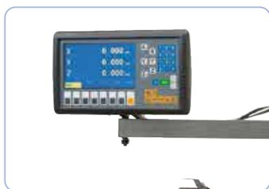
Dotato di un indicatore di posizione digitale a 2 assi
