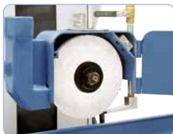
Funzionamento privo di vibrazioni ed elevata precisione del mandrino di smerigliatura mediante i cuscinetti speciali temperati.
