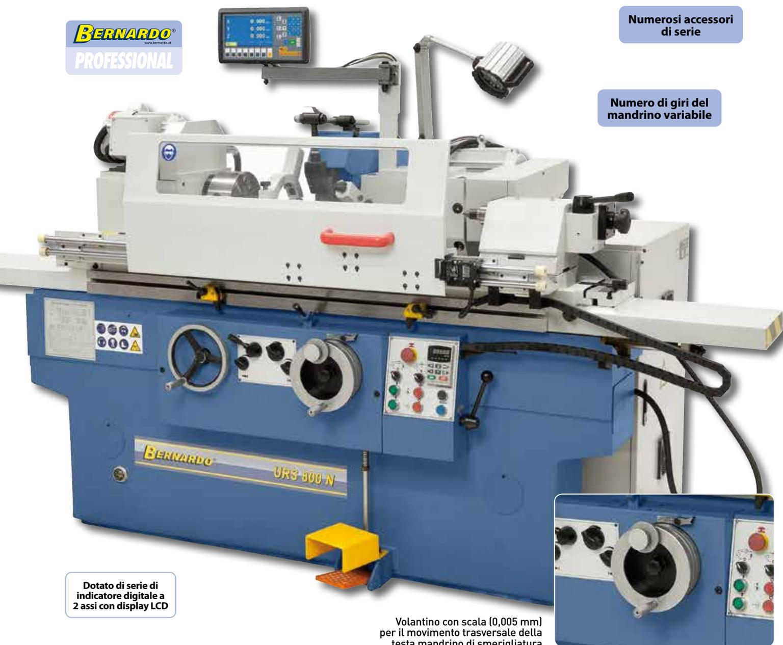
Dotato di serie di indicatore digitale a 2 assi con display LCD
