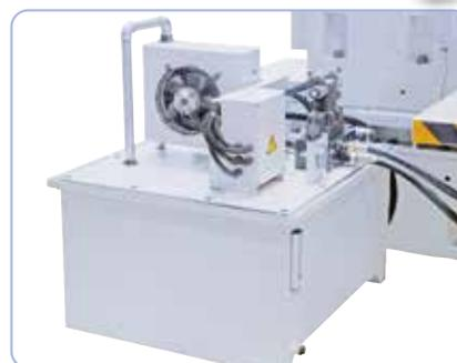
L'unità idraulica indipendente con il raffreddamento dell'olio evita vibrazioni o sollecitazioni termiche del corpo della macchina
