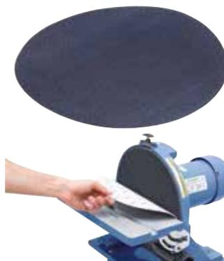
Gli appoggi in velcro sono autoadesivi sul retro e vengono incollati sulla piastra della smerigliatrice. In tal modo è possibile eseguire una rapida sostituzione dei diversi inerti di sostanza abrasiva.
