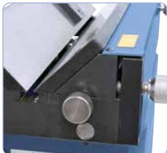
Regolazione semplice della larghezza dello smusso mediante rotaia di arresto spostabile.
