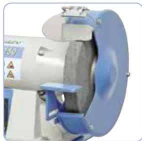
Le caratteristiche standard includono: sgrossatura, supporto Prezzo regolabile, coperchio di protezione chiuso lateralmente e protezione per gli occhi
