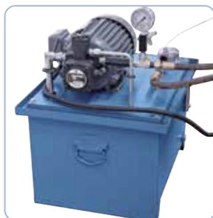
Unità idraulica separata evita vibrazioni e stress termici
