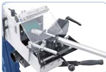
Dispositivo di smerigliatura inclin. da 30° a 90°
