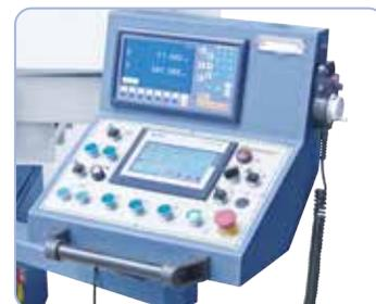
Pannello Siemens SMART IE V3 con controllo a sfioramento e volantino elettronico
