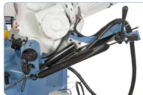
Molla di trazione con leva di regolazione per il passaggio al funzionamento manuale
