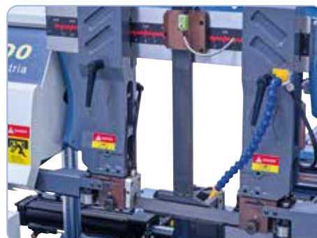
La guida a nastro per sega regolabile impedisce al nastro per seghe di spostarsi lateralmente o di inclinarsi.
