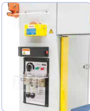
Dispositivo di saldatura della banda, taglio e mola.
