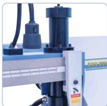
Robusto cilindro idraulico per un abbassamento delicato della seghetta ad arco
