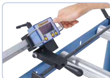
La slitta guida è condotta in modo preciso e facilmente spostabile
