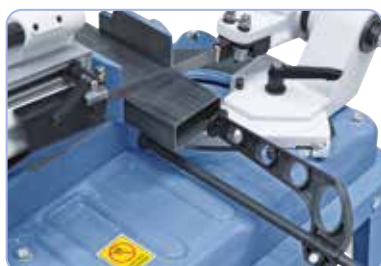
Arresto pezzo incluso per lavorare in modo efficiente, ideale per la produzione in serie
