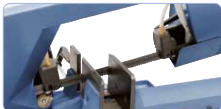
Guida nastro per sega con cuscinetto a sfera per risultati di taglio precisi
