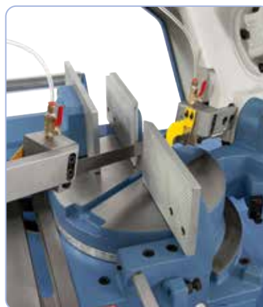
L'intaccatura nella tavola rotante si muove allo stesso tempo della seghetta ad arco
