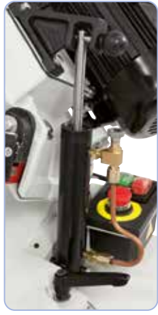
Dotato di cilindro idraulico per un abbassamento delicato della seghetta ad arco
