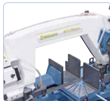
Elevata precisione di taglio grazie alla robusta seghetta ad arco in ghisa
