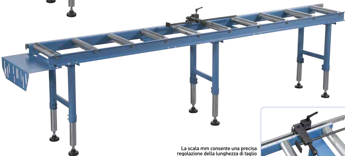
La recinzione del pezzo solida può essere inclinata in posizione verticale
