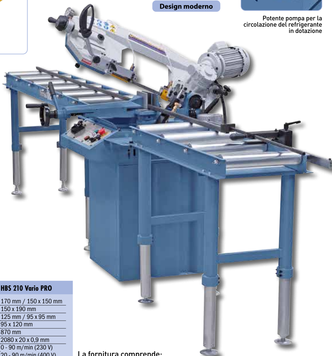
Guida nastro per sega con cuscinetto a sfera per risultati di taglio precisi
