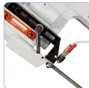
Guida nastro per sega con cuscinetto a sfera, regolabile a seconda della larghezza del pezzo e del raccordo del refrigerante
