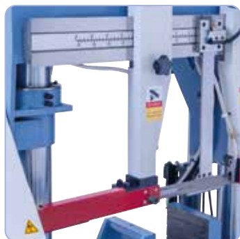
La guida a nastro per sega regolabile impedisce al nastro per seghe di spostarsi lateralmente o di inclinarsi.
