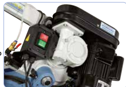
Mediante le cinghie è possibile cambiare la velocità di taglio [24 / 40 / 61 / 82 m/min]
