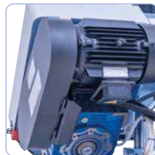
Azionamento cinghie con 3 velocità di taglio regolabili.
