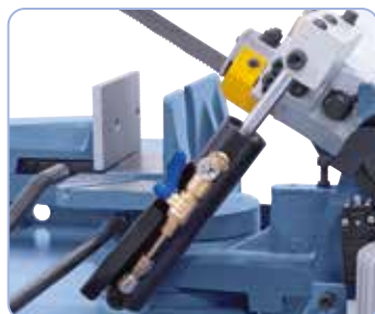
Cilindro idraulico per un abbassamento continuo della seghetta ad arco.
