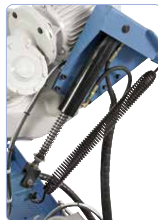
Dotato di cilindro idraulico per un abbassamento delicato della seghetta ad arco
