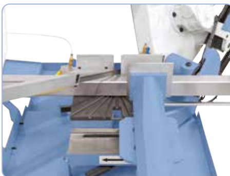
Guida nastro per sega attraverso il sistema combinato guide griffe per rulli in metallo duro
