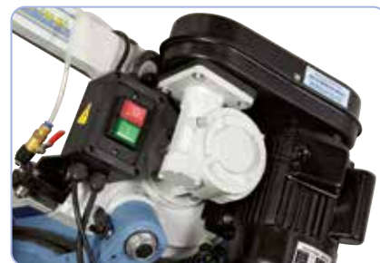
Mediante le cinghie è possibile cambiare la velocità di taglio (23 / 33 / 52 m/min)
