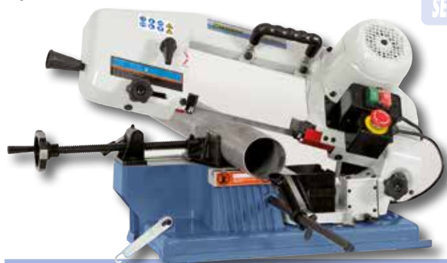
Contrasto della seghetta ad arco tripla regolabile
