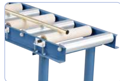
Rulli rivestiti in PVC (opzione) per evitare di graffiare il pezzo
