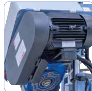
Azionamento cinghie con 3 velocità di taglio regolabili.
