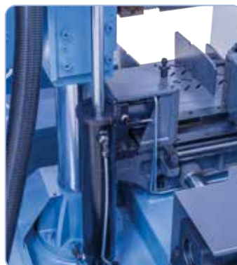
Robusto cilindro idraulico per un abbassamento delicato della seghetta ad arco
