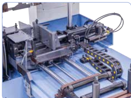
Avanzamento del materiale mediante un dispositivo di serraggio e una guida rotonda di precisione
