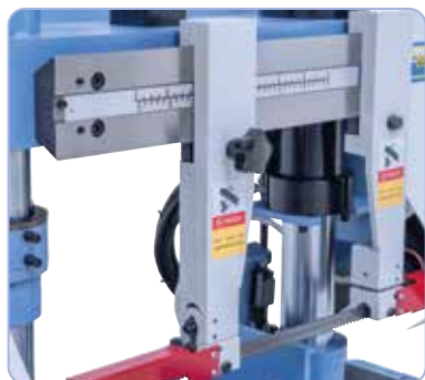
La guida a nastro per sega regolabile impedisce al nastro per seghe di spostarsi lateralmente o di inclinarsi.
