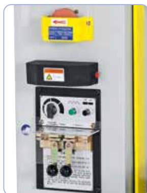
Dispositivo di saldatura della banda con un dispositivo di ricottura, taglio e mola incluso
