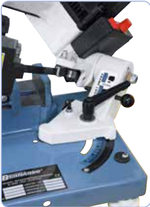
Seghetta ad arco con dispositivo di esclusione per una migliore maneggevolezza durante l'utilizzo mobile
