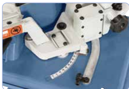
Seghetta ad arco impostabile per il taglio obliquo
