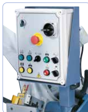
Disposizione intuitiva degli elementi di commutazione nel pannello di controllo scorrevole
