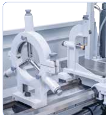
Dotato di una lunetta fissa o rotante per la stabilizzazione dei pezzi lunghi
