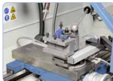
Porta-utensili a sostituzione rapida sistema Multifix in dotazione (Standard 165 Top).
