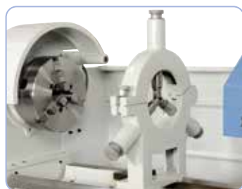
Lunetta fissa per la stabilizzazione dei pezzi lunghi
