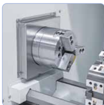
Mandrino idraulico a 3 griffe diam. 200 mm
