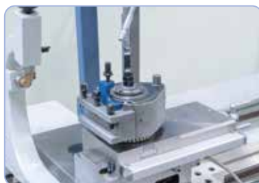
Per lavorare in modo efficiente, la macchina è dotata di un porta-utensili a sostituzione rapida di serie
