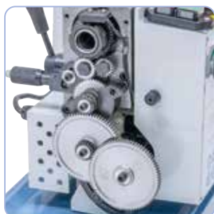
Dotato di serie di ruote di ricambio con esecuzione in metallo per il taglio di filettature metriche
