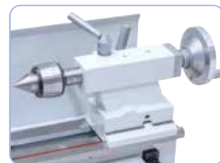
La contropunta con supporto MK 2 può essere regolata per la tornitura conica
