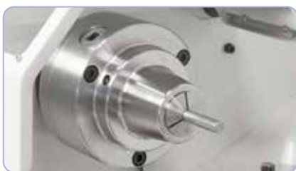
Disponibile come optional: mandrino porta pinze 5C, intervallo di serraggio 3 - 26 mm.
