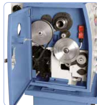
La fornitura comprende ruote di ricambio per la filettatura
