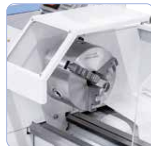
Mandrini a 3 griffe 125 mm con griffe di tornitura e foratura in dotazione
