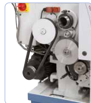
La forniture comprende ruote di ricambio per la filettatura
