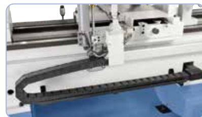
Passaggio del cavo incluso, tramite la catena energetica
