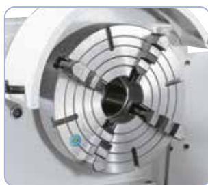
Piattaforma 400 mm (opzionale) ideale per il serraggio di pezzi asimmetrici
