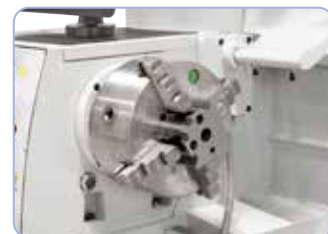
Mandrini a 4-griffe con serraggio centrale da 200 mm, ideale per pezzi quadrati (opzionale)
