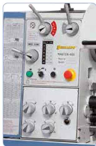
Elementi di commutazione disposti in modo intuitivo sul riduttore; gli ingranaggi temprati e rettificati assicurano un funzionamento silenzioso
