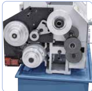
Ruote di ricambio per la filettatura in dotazione
