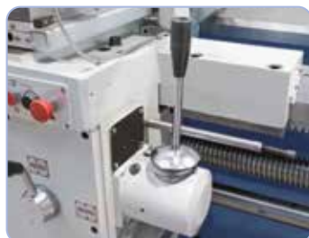
Dotato di corsa rapida di serie per ridurre i tempi morti
