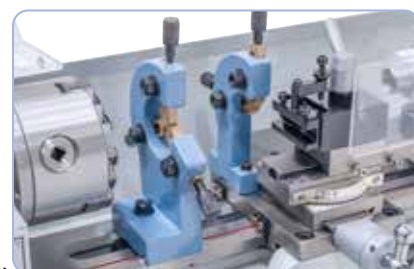
Le lunette facilitano la lavorazione di pezzi più lunghi
