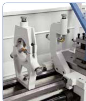
Dotato di una lunetta fissa o rotante per la stabilizzazione dei pezzi lunghi
