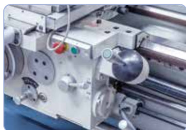
Dotato di corsa rapida di serie per ridurre i tempi morti
