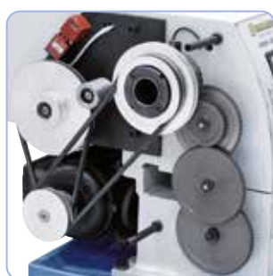
Impostazione semplice del livello di velocità mediante cinghie
