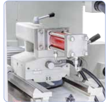
Regolazione idraulica del mandrino contropunta di serie.
