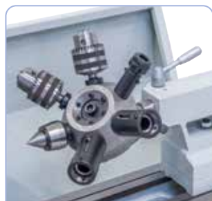
La macchina può essere dotata di una torretta per un lavoro economico
