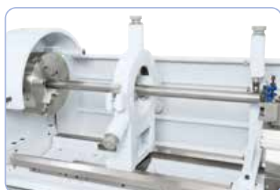
Dotato di lunetta fissa di serie per il serraggio di pezzi lunghi
