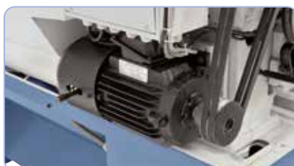
Motore potente con freno magnetico secondo la norma CE
