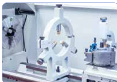
Lunetta fissa per la stabilizzazione dei pezzi lunghi
