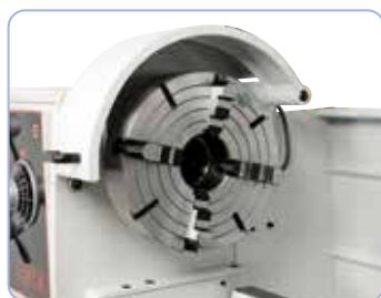
Piattaforma 400 mm (opzionale) ideale per il serraggio di pezzi asimmetrici
