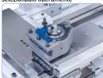
Il porta-utensili a sostituzione rapida consente una riduzione dei tempi morti e garantisce un'alta precisione di ripetibilità
