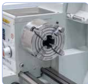
Piattaforma (opzionale) per il serraggio di pezzi di forma irregolare
