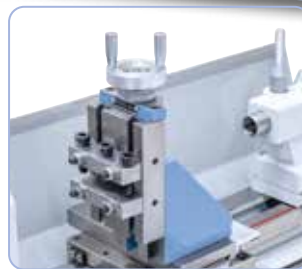
Il supporto di fresatura verticale può essere montato successivamente per lavorazioni supplementari.
