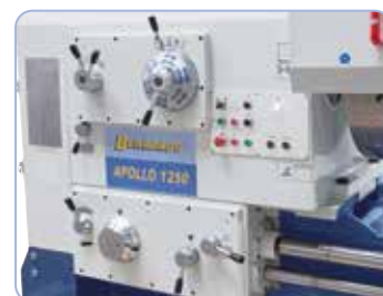
Elementi di commutazione disposti in modo intuitivo sul riduttore; gli ingranaggi temprati e rettificati assicurano un funzionamento silenzioso
