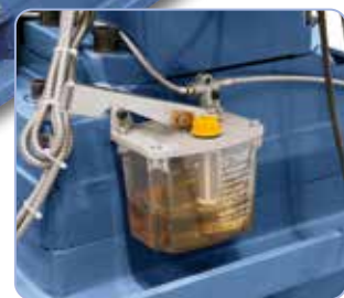
Lubrificazione centrale manuale per tutte le guide in dotazione
