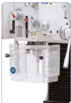
Elevata sicurezza grazie alla protezione mandrino ad altezza regolabile con microinterruttore
