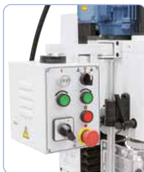
Elementi di commutazione chiaramente disposti, dotati di un dispositivo di filettatura
