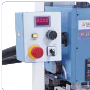
Dotato di un visualizzatore digitale della velocità ed un dispositivo di rotazione in senso orario e antiorario
