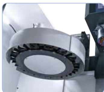
Sostitutore del pezzo a 16 posizioni per tempi di trasformazione rapidi
