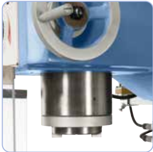
Mandrino di grandi dimensioni che assicura la massima stabilità
