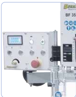
Visualizzatore della velocità e della profondità di foratura digitale in dotazione
