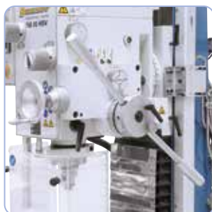
L'alimentazione del mandrino può essere impostata a 0,10 / 0,18 o a 0,26 mm/giro.
