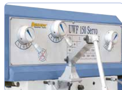
Funzionamento semplice degli elementi di commutazione per la variazione di velocità
