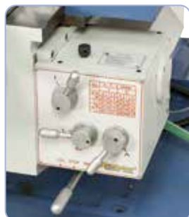
Con l'avanzamento del tavolo di serie con la funzione di corsa rapida i tempi morti sono notevolmente ridotti in tutti e 3 gli assi.
