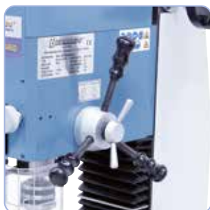
Grande manopola a stella per un facile avanzamento del mandrino durante la foratura; volantino per avanzamento di precisione per la fresatura.
