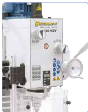
Variazione della velocità semplice e veloce mediante l'interruttore di cambio
