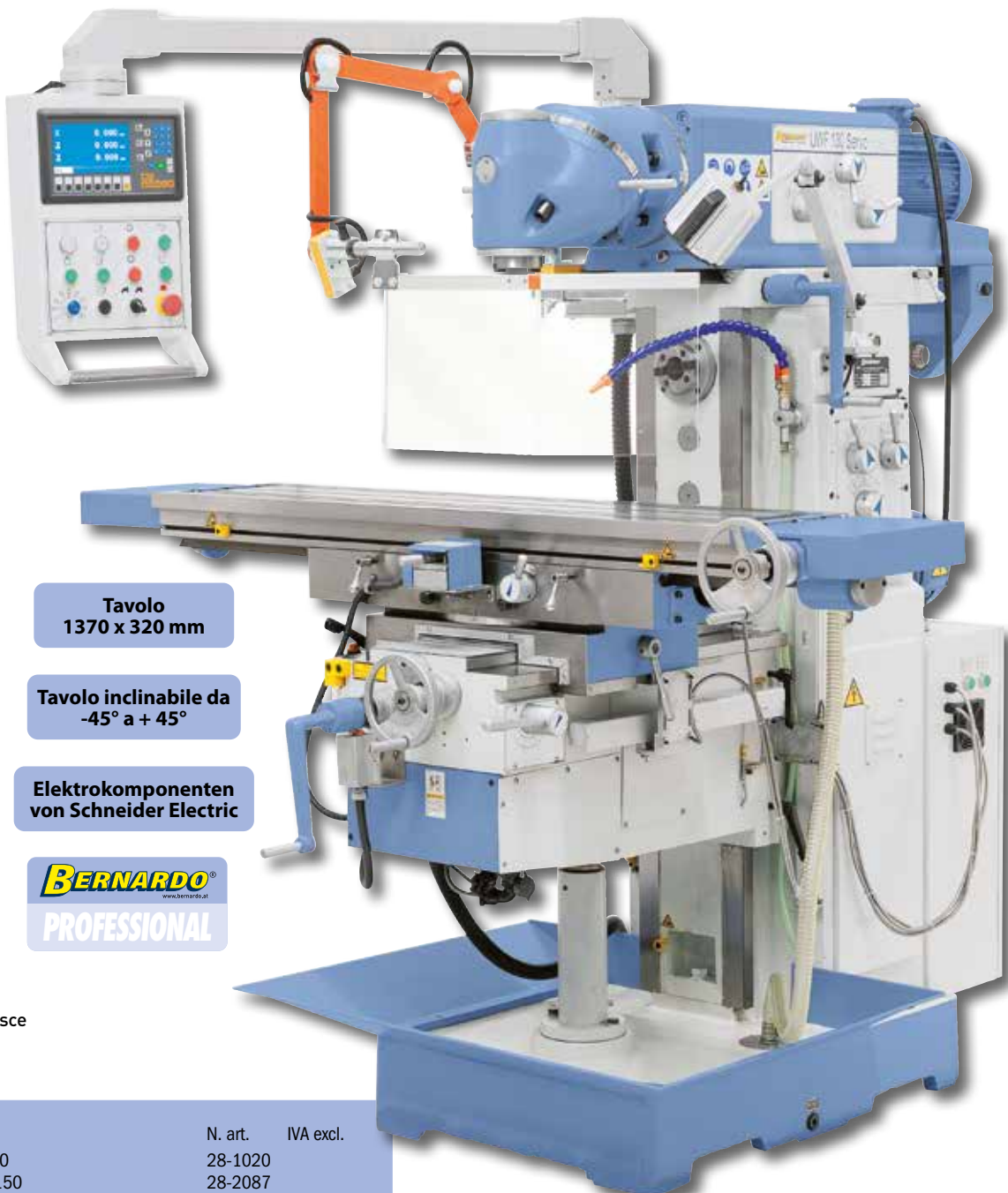
Testa di fresatura universale con 2 assi rotanti, regolabile in tutte le posizioni angolari.
