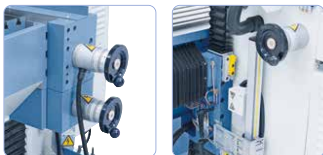
Dotato di serie di volantini elettronici per il movimento manuale negli assi x, y e z.
