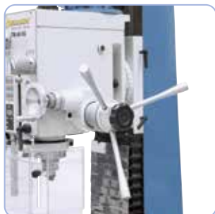
Facile regolazione dei mandrini attraverso le impugnature disposte ergonomicamente; volantino con scala per un'impostazione precisa nelle frese
