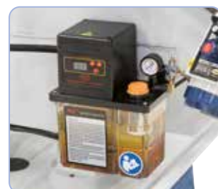
Lubrificazione elettrica in dotazione
