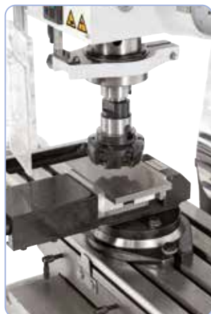
Fresatura con fresa per spianare (N. art.: 42-1085)
