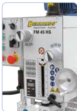
Variazione della velocità semplice e veloce mediante l'interruttore di cambio
