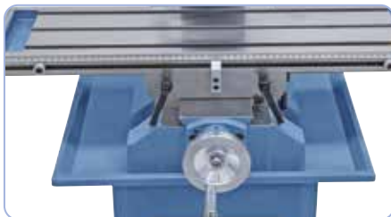
Guida a coda di rondine per gli assi x, y e z, impostabile mediante lardoni
