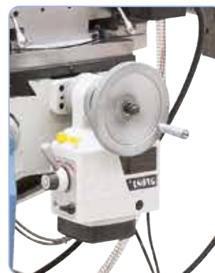
Dotato di un dispositivo di avanzamento continuo per l'asse y
