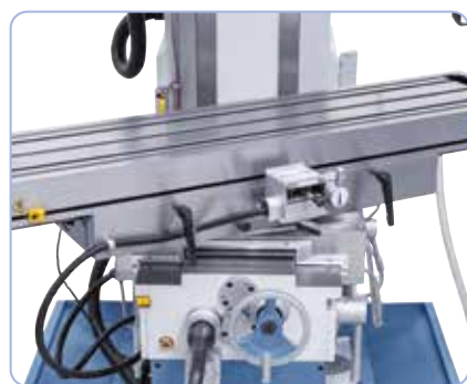
Le guide piane di grandi dimensioni garantiscono stabilità per carichi elevati di fresatura; tavola di fresatura inclinabile da -45^\circ a +45^\circ .
