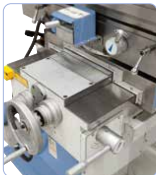
La guida rettangolare di grandi dimensioni negli assi y e z garantisce un'elevata stabilità.
