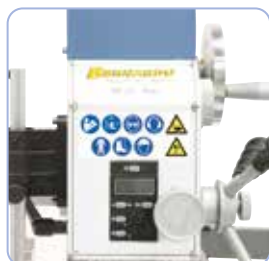
Un indicatore di posizione digitale Bernardo ES-12 V per gli assi x, y e z è in dotazione (N. art. 02-1033B)
