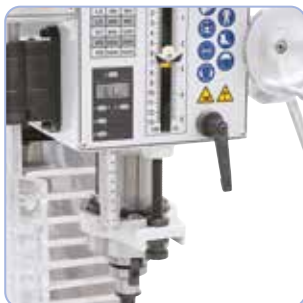
Mandrino di grandi dimensioni con corsa di 125 mm, dotato di serie di un visualizzatore digitale del mandrino
