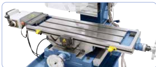
Grande tavola composta con scanalature a T e un canale di raffreddamento. Figura con avanzamento tavolo di fresatura opzionale AL 450 D
