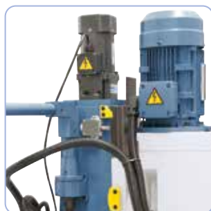
Regolazione dell'altezza della testa di fresatura di serie con il motore di sollevamento
