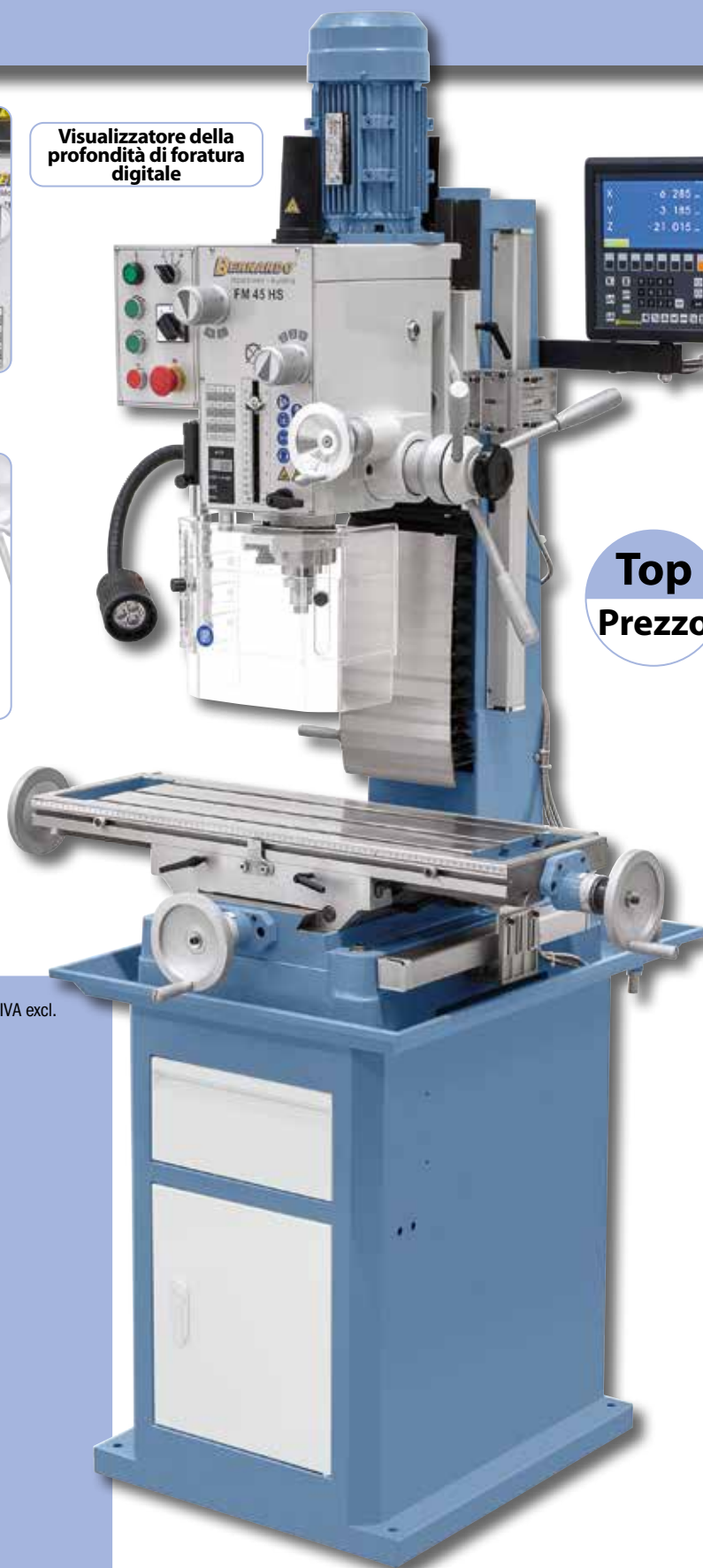
Mandrino di grandi dimensioni con corsa di 125 mm, dotato di serie di un visualizzatore digitale del mandrino
