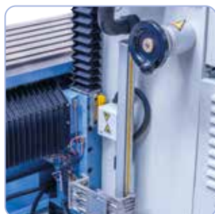
Dotato di serie di volantini elettronici per il movimento manuale negli assi x, y e z.
