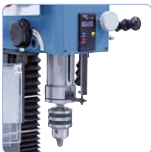
Spoletta di dimensioni considerevoli con cuscinetti a rulli conici, di serie con indicatore digitale di profondità del foro.
