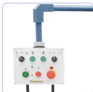
Pannello di comando inclinabile con elementi di commutazione montati ergonomicamente
