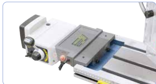
Grande tavola composita con scanalature a T e un canale di raffreddamento. Figura con avanzamento tavolo di fresatura opzionale AL 450 D
