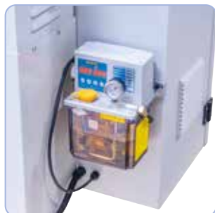
Lubrificazione elettrica in dotazione
