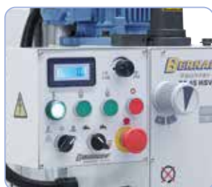
Facile preselezione del livello di velocità mediante l'interruttore di cambio, impostazione della velocità desiderata con il potenziometro.
