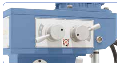
Funzionamento semplice degli elementi di commutazione per la variazione di velocità
