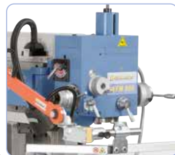
Testa di fresatura verticale orientabile, con corsa del canotto 60 mm e tre avanzamenti di perforazione automatici
