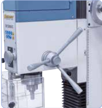
Grande manopola a stella per un facile avanzamento del mandrino durante la foratura; volantino per avanzamento di precisione per la fresatura.
