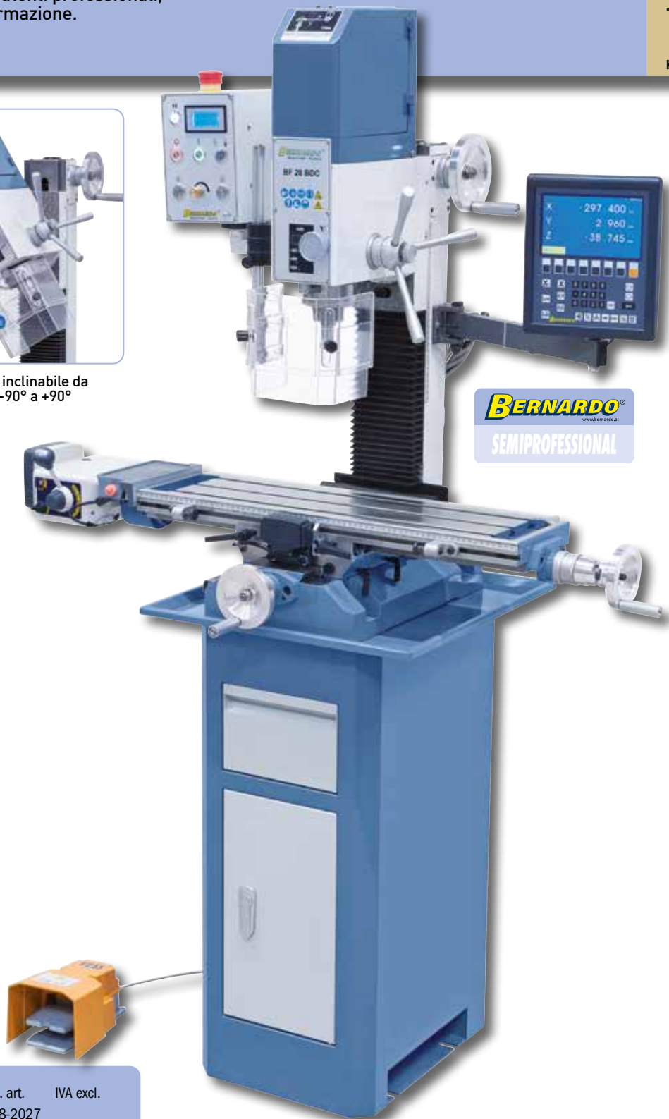
Pedale di serie per cambiare il senso di rotazione durante la filettatura
