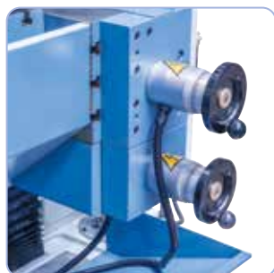
Dotato di serie di volantini elettronici per il movimento manuale negli assi x, y e z.
