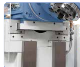
La guida rettangolare di grandi dimensioni negli assi y e z garantisce un'elevata stabilità. (FU 1600 / FU 2000).
