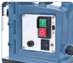
Disposizione razionale degli elementi di commutazione.
