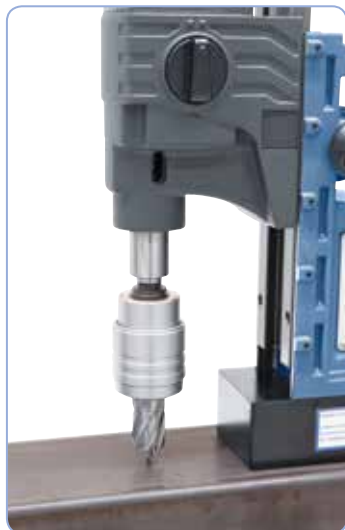
Carotaggio con supporto a cambio rapido
