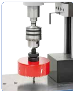
Dotato di serie di cono MK3 - per il supporto di diversi utensili
