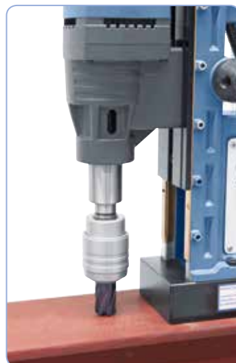
Fresa a corona HSSCO5 con rivestimento in nACO
