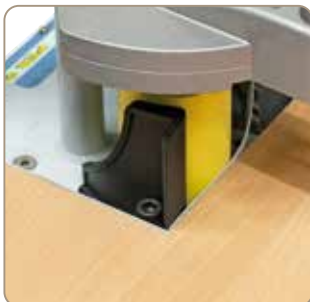
Az élyanyag sarkokba történő felviteléhez alapkitelben egy vezetőlappal rendelkezik.
