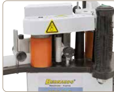
Beállítható magasságú vezetőlemez 10 – 55 mm lapvastagságokhoz
