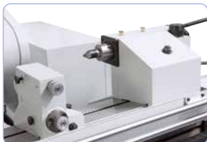
Hidraulikus nyeregszeg nagy pontossággal és stabilitással, lábpedál által kezelhető
