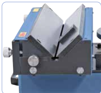
Egyszerűen állítható a fóz-szélesség az eltolható ütközősín által.
