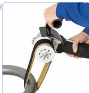
Opcionálisan tépőzáras flísszel a már összeépített nemesacél munkadarabok megmunkálására
