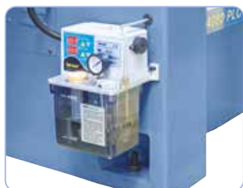
Minden vezetősín és orsó automatikus kenésű
