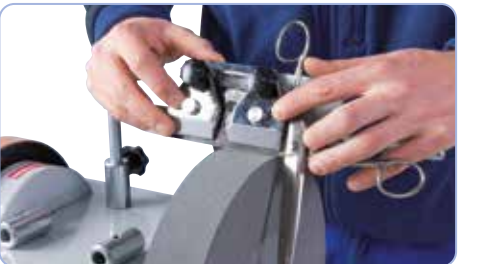
05-2055 Rögzítő eszköz ollókhöz: Ideális egyenes ollókhöz és metszőollókhöz.
