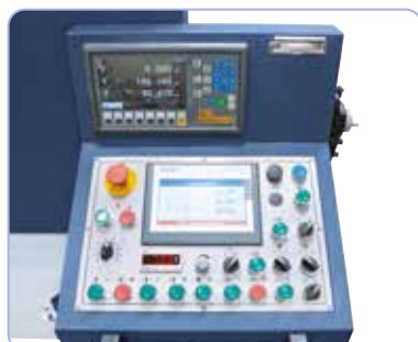
Inkluzív Siemens SMART-Panel IE V3 érintésvezérléssel és elektronikus kézikerék
