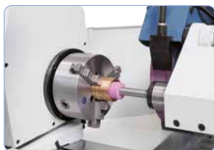
Sorozatszerűen levehető belső köszörűberendezéssel
