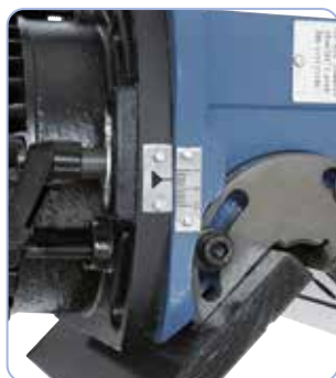
Az élmagasság / marási mélység szerszám nélküli beállítása
