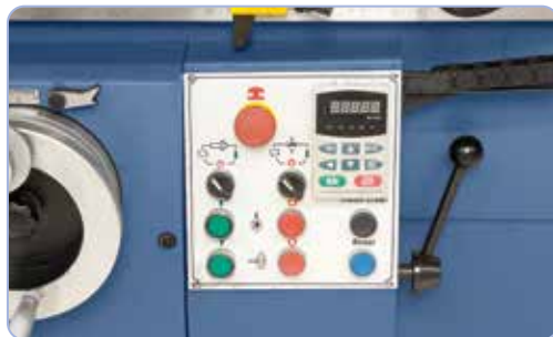
Áttekinthetően és ergonomikusan kialakított elektro-kezelőpult
