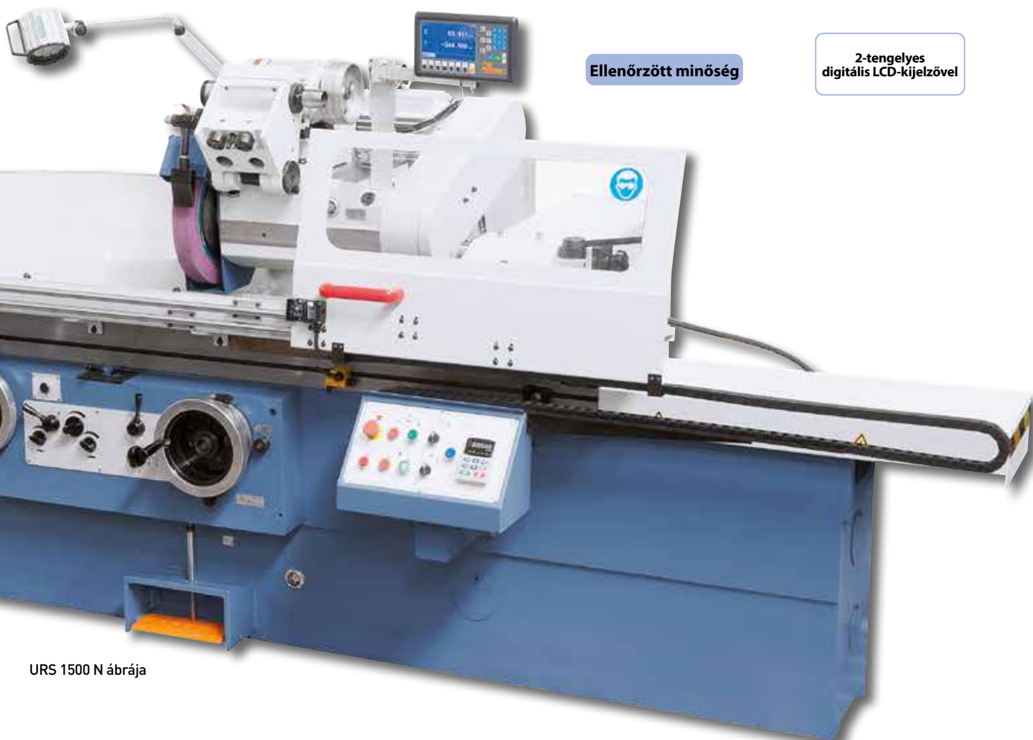
Hosszú munkadarabok stabilizálására sorozatszerűen egy zárt, ill. 2 nyitott lünettával felszerelt
