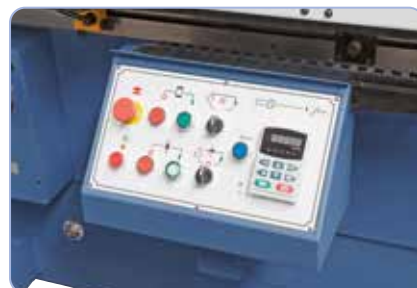
Minden fontos elektro-kapcsolási alkotóelem felhasználóbarát módon elhelyezve
