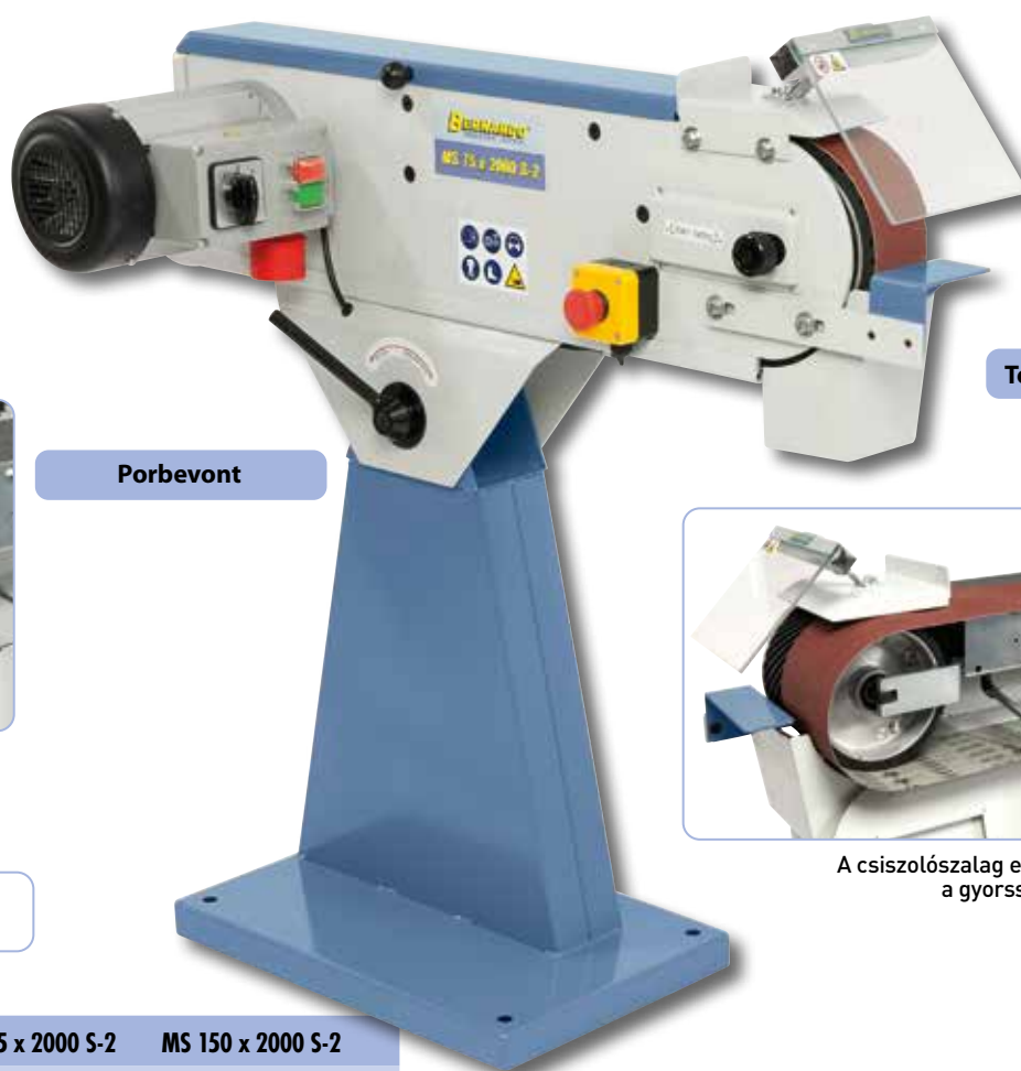
Sorozatszerűen elszívócső-toldattal, átmérő: 100 mm.
