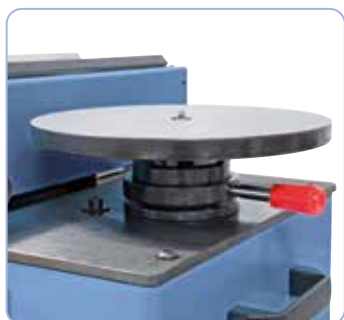
A forgótányér forgatásával a kontúrmarás fózolásai szélességének gyors beállítása.
