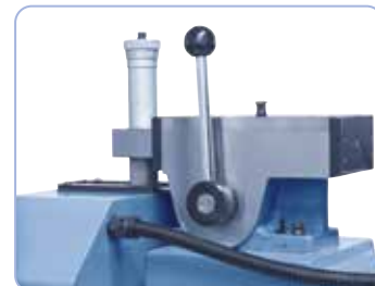
Kézi párhuzamos lehúzóberendezés mikrométer-beállítással a szállítási terjedelemben
