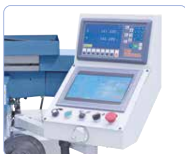
Vezérlés érintős kezelővel és elektronikus kézikerékkel.
