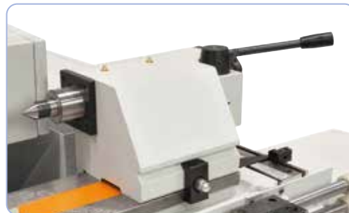
Hidraulikus nyeregszeg nagy pontossággal és stabilitással, lábpedál által kezelhető
