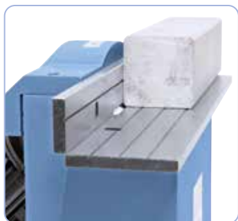
Nagyra méretezett vezetőléc a munkadarab stabil felhelyezéséhez
