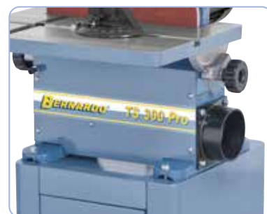
Sorozatszerűen elszívó ventilátorral a géptestben
