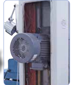
A csiszolófej robusztus vezetése hajszálpontos fogásvételt biztosít.
