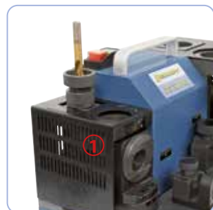
1. A szabadszög hátraköszörülése \varnothing 2 - 13 mm 2. A szabadszög hátraköszörülése \varnothing 8 - 32 mm
