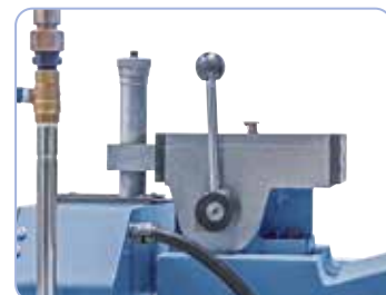
Kézi párhuzamos lehúzóberendezés a szállítási terjedelemben
