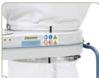
A forgács-, ill. filterzsák egyszerű szerelése szorító heveder segítségével
