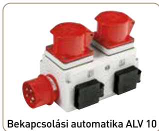
A famegmunkáló gép be-, ill. kikapcsolásakor az elszívóberendezés időráhagyással hozzá-, ill. lekapcsolható (opció).
