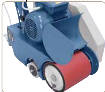
Gumírozott csiszolóhenger gyorszorító-rendszerrel a csiszolószalag egyszerű cseréjéhez
