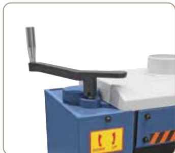
A munkasztal kézikerékkel és skálával a munkadarab vastagságához igazítható
