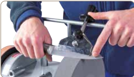
05-2057 Berendezés hosszú késekhez: késekhez 100 mm-es pengehossztól, vonókésekhez is alkalmas
