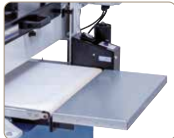
Nagyobb feltérfelület a kétoldali asztalhosszabbítók által.
