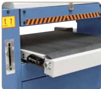
Beállítócsavar az előtolószőnyeg párhuzamos futtatásához.
