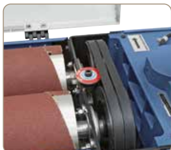
A hátsó csiszolóhenger finombeállítása.
