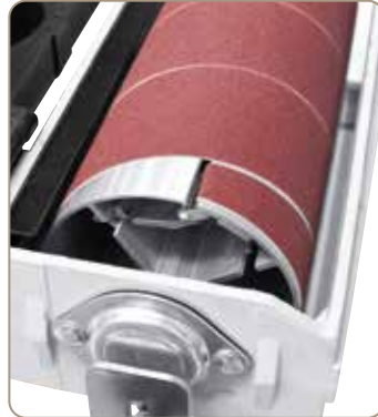
Gyorszorító-rendszer a csiszolószalag rögzítéséhez.
