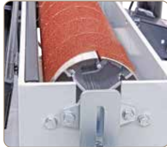
Gyorszorító-rendszer a csiszolászalag rögzítéséhez.
