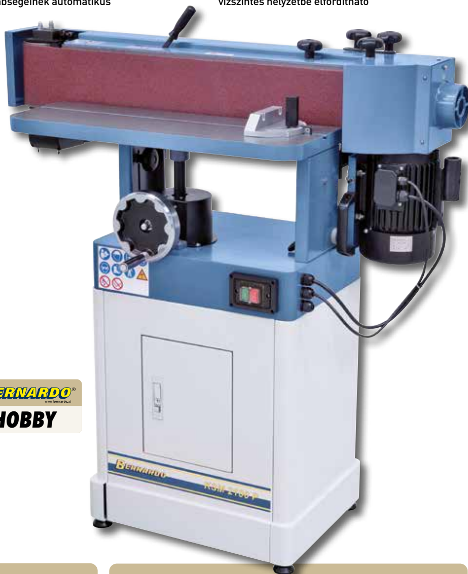
A csiszolóaggregát fokozatmentesen függőlegesről vízszintes helyzetbe elfordítható
