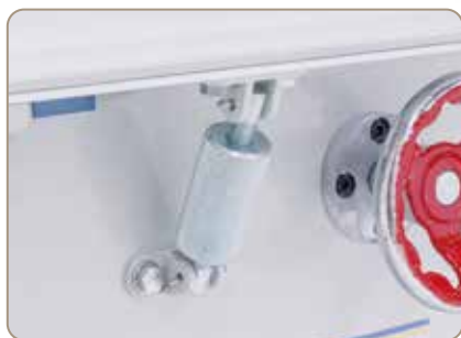
A csiszolási szög 23° és 55° között állítható.
