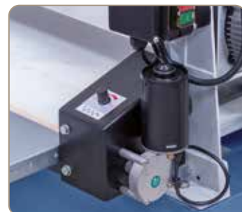
Változatosan beállítható előretolási sebesség.
