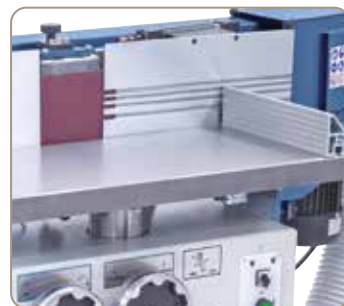
Hornyos bevezető-vonalzó a furnér-kiálló részekhez
