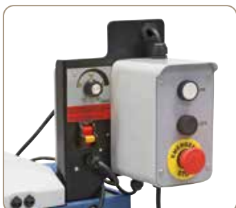
Változatosan beállítható előretolási sebesség.
