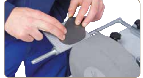
05-2056 feltéasztal: Optimális különböző kis alkatrészek köszörülésére
