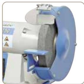
Sorozatszerűen nagyolótárcsával, beállítható munkadarabfettét, oldalt zárt védőfedéllel és szemvédővel
