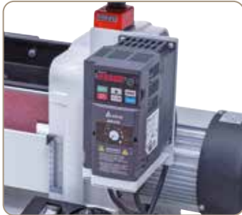
A kiváló minőségű frekvenciaváltó az orsó fordulatszámának fokozatmentes beállítását teszi lehetővé
