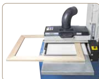
Alkalmazási példa: keretcsiszolás
