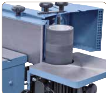
Kontúrcsiszoláshoz sorozatszerűen gumírozott csiszológörgővel
