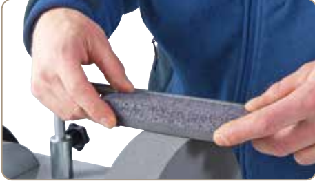
05-2050 köszörűkő: a köszörűtárcsa előkészítésére szolgál (finom/durva)
