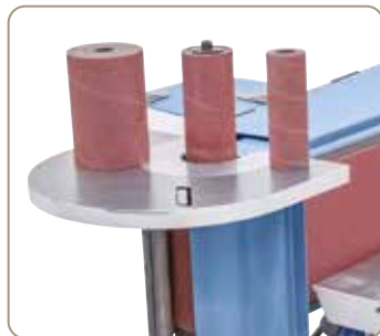
Három csiszolóhüvely kontúr-csiszoláshoz a szállítási terjedelemben
