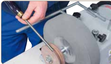
05-1809A Profilos bőr-csiszolótárcsa: forgócsövek és gérvésők belső oldalainak csiszolására és polírozására
