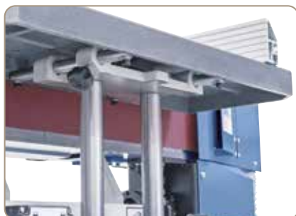
A beállítható magasságú munkaasztal előre és hátra tolható
