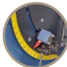
Fokozatmentesen elfordítható csiszolóaggregát a függőleges és vízszintes csiszolásért
