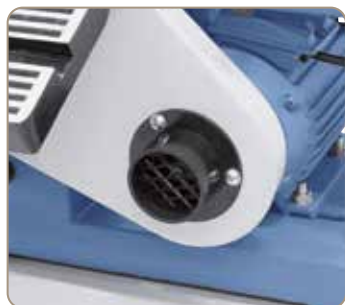
Szériaszériúen 2 elszívőcsonkkal, 50 mm-es átmérő.
