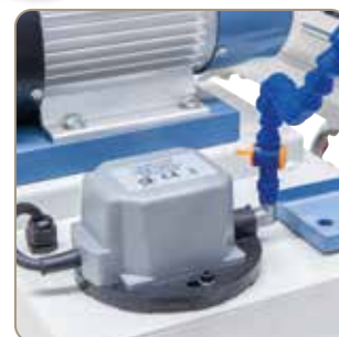
Sorozatszerűen hűtőanyag berendezéssel.
