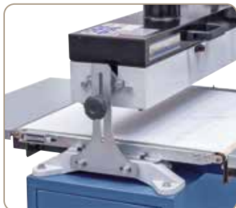
Szorítórendszer a csiszológység rögzítéséhez.
