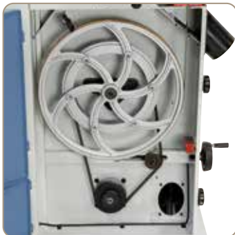
A kívánt forgácsolási sebesség egy ékszj által az alsó futókereken állítható be (HBS 400 N / HBS 460 N).
