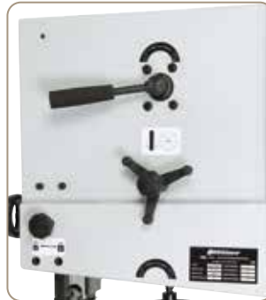
A fűrészlap egyszerű cseréje gyorszorítókarokkal, a hajtókerek alapbeállítása emellett nem változik
