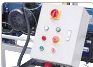
Ábra elektro-panellel és tolórúddal a kézi előretoláshoz (beállítható magasságú)
