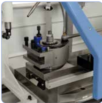
A gyorsváltó-szerszámtartó lehetővé teszi a mellékidők csökkentését és nagy, ismétlődő pontosságot biztosít
