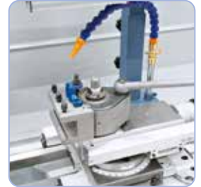
A gép felszerelhető egy gyorsváltó-szerszámtartóval a hatékony munka érdekében
