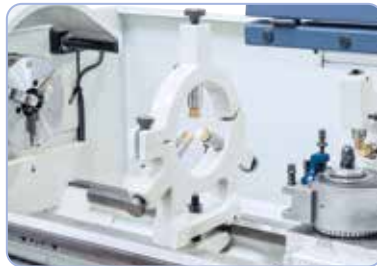
Rögzített lünetta a hosszú munkadarabok stabilizálására
