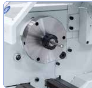
A szorítófogó-tokmány ER 25 a körmozgás nagy pontosságát biztosítja munkadarabok befogásánál, befogási tartomány 1 - 16 mm
