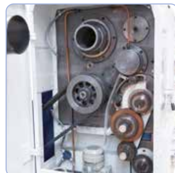
A 130 mm-es orsófurattal ellátott edzett főorsó a kúpgörgős csapágyakra és a radiális görgőscsapágyakra támaszkodik.
