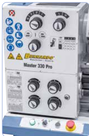
Áttekinthetően elhelyezett kapcsolási elemek a hajtóműfejen, az edzett és csiszolt fogaskerekek nyugodt menetről gondoskodnak
