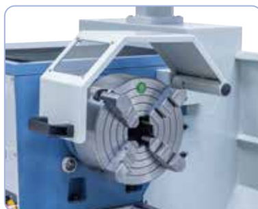
Centrikus szorítású 4-pofás tokmány 200 mm, optimális négyélű-munkadarabokhoz (opció)
