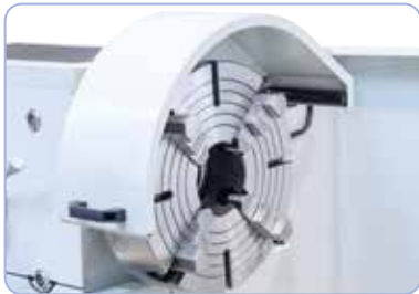
Síktárcsa 400 mm (opció) ideális aszimmetrikus munkadarabok befogásához
