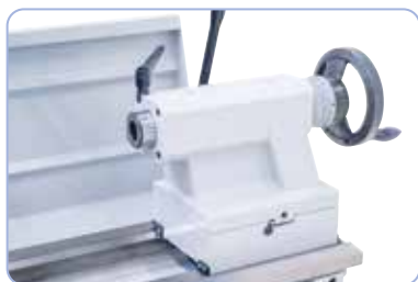
A robusztus nyeregszeg MK 4 szegnyereg felvételével kúpsztergáláshoz beállítható
