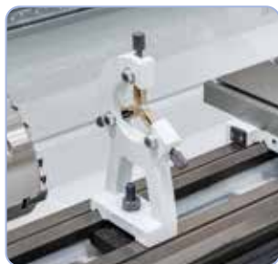
Rögzített lünetta bronzvezetével hosszú munkadarabok stabilizálására
