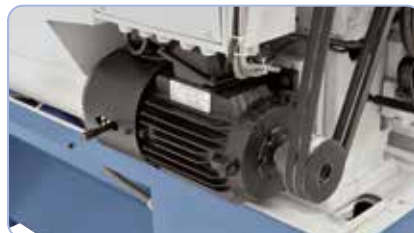
Nagy teljesítményű hajtómotor mágneses fékkel CE-norma szerint
