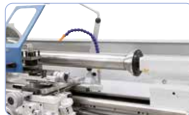
Központozókúp diam. 125 mm, ideális csövek és üreges testek befogására (opció)
