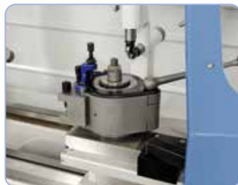
A gyorsváltó-szerszámartó lehetővé teszi a mellékidők csökkentését és nagy, ismétlődő pontosságot biztosít
