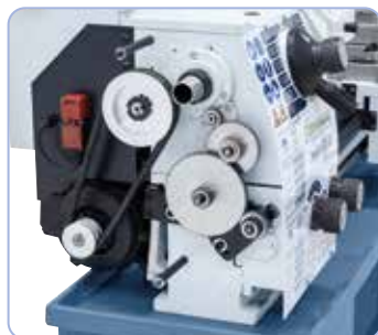
Sorozatszerűen váltókerékkel menetvágáshoz felszerelt
