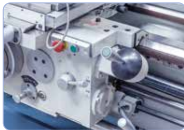
Sorozatszerűen gyorsmenettel a mellékidők lecsökkentésére
