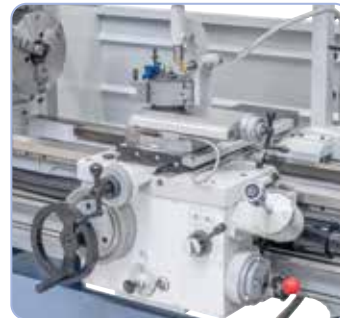
A szán hosszanti- és keresztirányú mozgásához, ill. a felsőszupportnak 42 szabadon választható előretolás áll rendelkezésre
