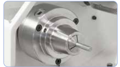
Opciósan szállítható: szorítófogó-tokmány 5C, befogási tartomány 3 - 26 mm
