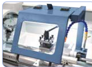
A szerszámtartó-védelemben beépített LED-géplámpa az optimális megvilágításért munka közben.
