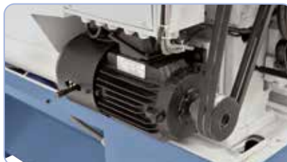
Nagy teljesítményű hajtómotor mágneses fékkel CE-norma szerint
