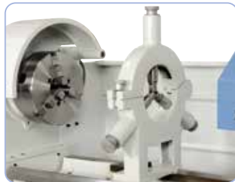
Rögzített lünetta a hosszú munkadarabok stabilizálására
