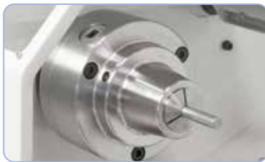
Opciósan szállítható: szorítófogó-tokmány 5C, befogási tartomány 3 - 26 mm
