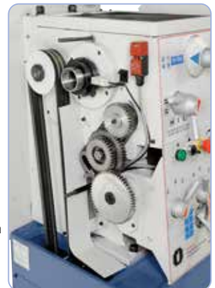
Sorozatszerűen váltókerekekkel menetvágáshoz felszerelt
