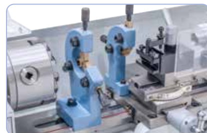
A lünetták megkönnyítik a hosszabb munkadarabok megmunkálását
