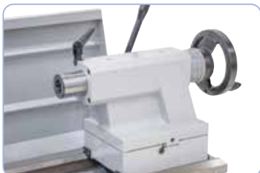
A robusztus nyeregszeg MK 4 szegnyereg-felvéttelél kúpesztergáláshoz beállítható
