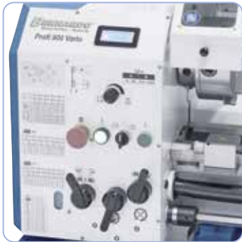
Elektronikus, fokozatmentes fordulatszám-szabályzás, könnyű leolvasás a digitális mutató segítségével
