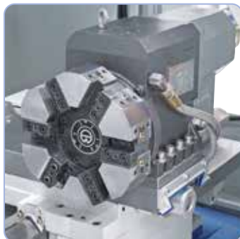
Robosztus szerszámrevolver 6 állomással.
