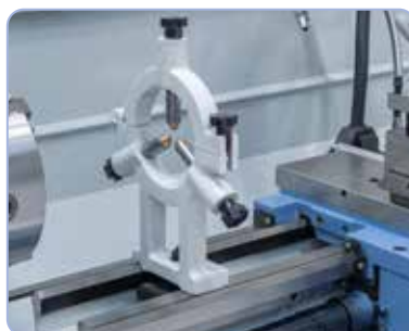
Rögzített lünetta bronz-vezetővel hosszú munkadarabok stabilizálására
