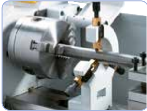
Rögzített lünetta bronz-vezetővel a hosszú munkadarabok stabilizálásához
