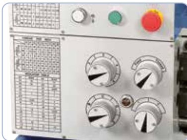
Könnyen és precízen kapcsolható, olajfürdőben futó előretoló-hajtómű
