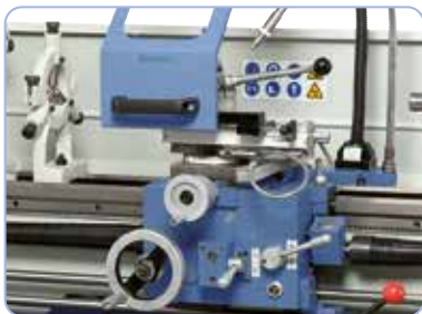
Könnyed menetű és precíz szán felsőszupporral és négyes- szerszámtartóval, kézikerek beállítható metrikus finom-skálabeosztással
