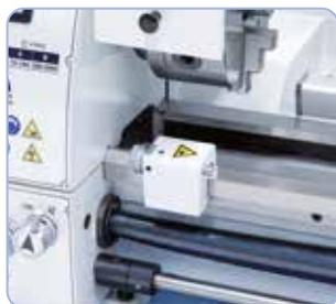
Modell 700 Top sorozatszerűen csúszóklunggal és mikrométer hosszanti-ütközővel felszerelt
