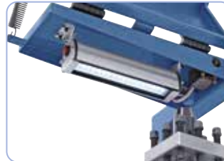
A szerszámtartó-védelembe beépített LED-géplámpa az optimális megvilágításért munka közben.
