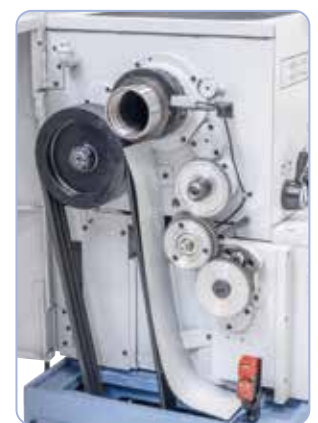
Edzett főorsó precíziós kúpos csapággal a körmozgás nagy pontosságáért, optimális erőátvitel a fogazott Optibelt-ékszíj által.
