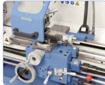
Könnyű menetű és precíz szán felsőszupporttal és négyes-szerszámtartóval, kézikerek beállítható metrikus finom-skálabeosztással
