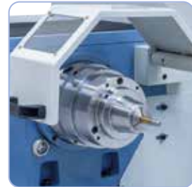
Opciósan szállítható: szorítófogó-tokmány 5C, befogási tartomány 3 - 26 mm
