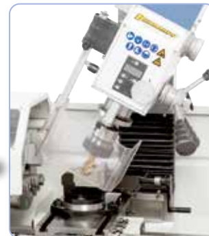
Az elfordítható marófej a megmunkálási lehetőségek sokszínűségét kínálja
