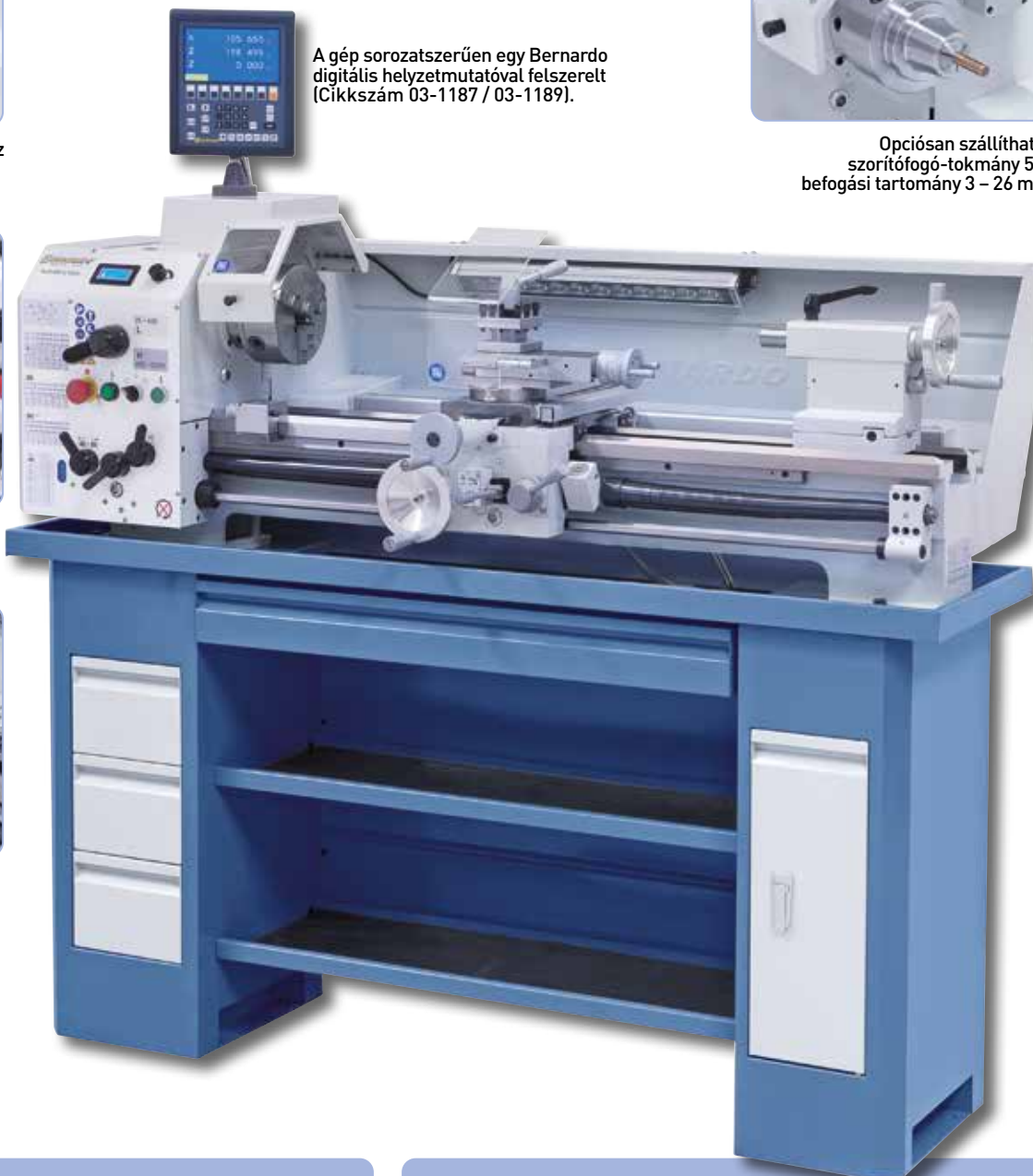
Nagy átmérők megmunkálásához sorozatszerűen egy 38 mm-es orsófurattal ellátva
