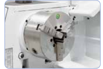
A Bernardo-pofás tokmány előnye DK11-200 mm / D5: Monoblokk-, alap-, fordító- és feltépfóákkal szállítható
