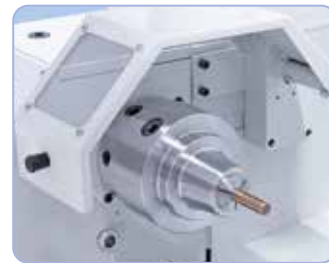
Opciósan szállítható: szorítófogó-tokmány 5C, befogási tartomány 3 - 26 mm
