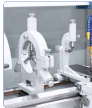
Hosszú munkadarabok stabilizálá-sához sorozatszerűen egy rögzített, ill. együttfutó lünettával van felszerelve
