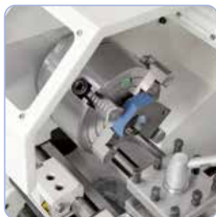
Síktárcsa 160 mm (opció) ideális aszimmetrikus munkadarabok befogására
