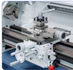
Könnyű menetű szán felső -szuporttal és négyes-szerszám-tartóval, kézikerekkel beállítható metrikus finom-skálaosztással
