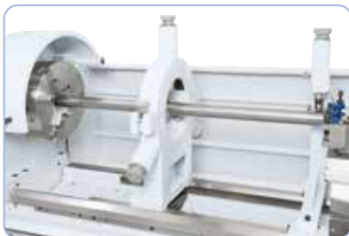
Sorozatszerűen rögzített lünettával hosszú munkadarabok befogására
