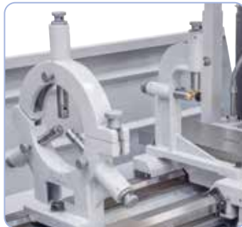
Hosszú munkadarabok stabilizálására sorozatszerűen egy rögzített, ill. együttfutó lünettával felszerelt
