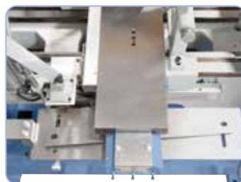
Kúpszterga-berendezés opciósan kapható, esztergahossz 455 mm, beállítási szög \pm 8^\circ
