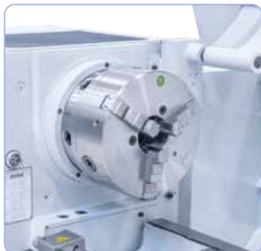
A Bernardo-pofás tokmány előnye PS3-250 mm / D6: Monoblokk-, alap-, fordító- és feltépfók szállíthatók
