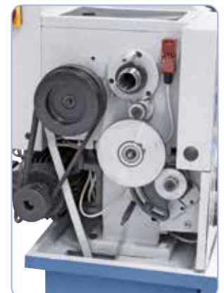
Sorozatszerűen váltókerekekkel menetvágáshoz felszerelve
