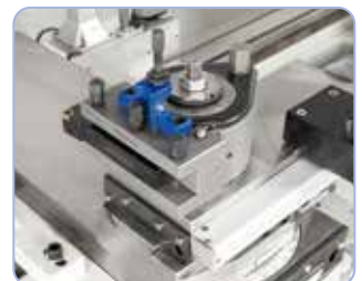
A gyorsváltó-szerszámtartó a mellékidők csökkentését teszi lehetővé és nagy ismétlési pontosságot biztosít
