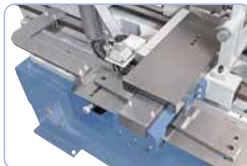
Kúpeszterga-berendezés opciósan kapható, esztergahossz 300 mm, beállítási szög \pm 10^\circ
