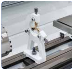
Rögzített lünetta bronz-vezetővel a hosszú munkadarabok stabilizálásához
