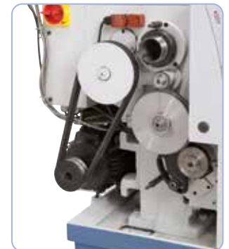
Szállítási terjedelemben komplett váltókerekekkel menetvágáshoz
