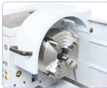
Síktárcsa 250 mm (opció) ideális aszimmetrikus munkadarabok befogásához
