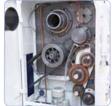
A 130 mm-es orsófurattal ellátott edzett főorsó a kúpgörgős csapágyakra és a radiális görgőcsapágyakra támaszkodik.
