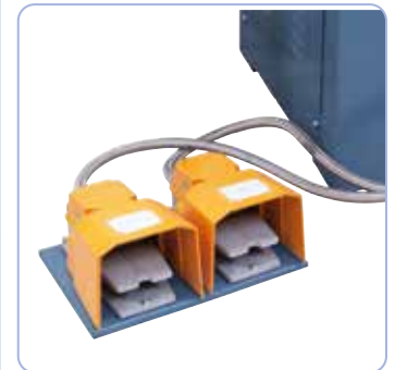
Alapfelszereltségben lábpedállal a befogópofák szorításához, ill. nyeregszeghüvely mozgathatásához.
