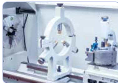
Rögzített lünetta a hosszú munkadarabok stabilizálására
