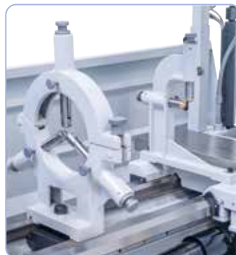
Hosszú munkadarabok stabilizá-lására sorozatszerűen egy rögzített, ill. együttfutó lünettával felszerelt
