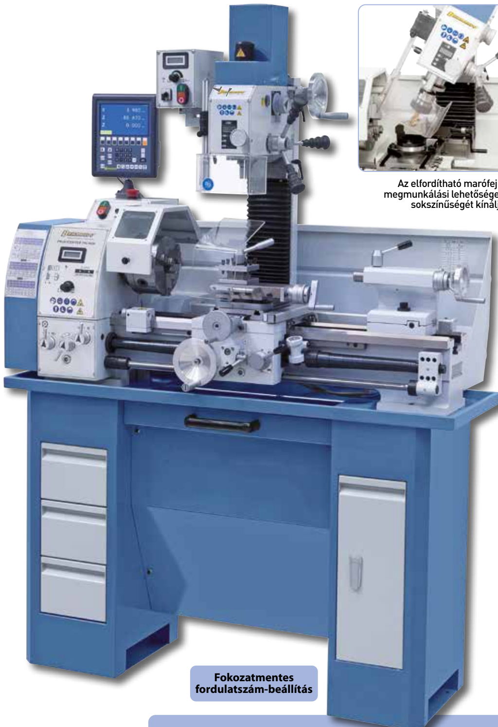
Szán kézikerekek finom-skálabeosztással, pótlólagosan automatikus keresztirányú előretolással
