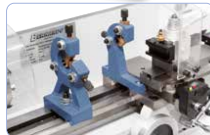
A lünetták megkönnyítik a hosszabb munkadarabok megmunkálását
