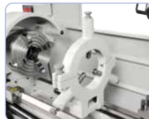
Rögzített lünetta hosszú és vékony munkadarabok megtámasztására
