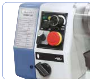
Egyszerű alkalmazás, minden kapcsolási elem az orsófejen
