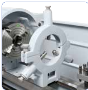
Rögzített lünetta hosszú és vékony munkadarabok megtámasztásához
