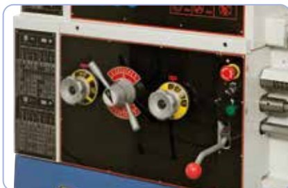
Könyven és precízen kapcsolható előretoló hajtómű, a csiszolt fogaskerekek nyugodt menetről gondoskodnak
