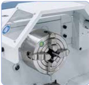
Síktárcsa (opció) szabálytalan formájú munkadarabok befogásához
