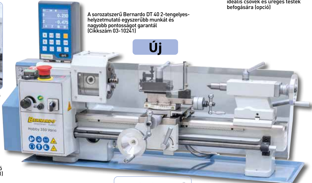
Elektronikus, fokozatmentes fordulatszám-szabályzás, könnyű leolvasás digitális mutató által
