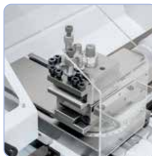
Könnyű menetű szán felső -szuporttal és négyes-szerszám-tartóval, kézikerekkel beállítható metrikus finom-skálaosztással
