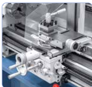
Könnyű menetű szán felsőszupporttal és négyes szerszámtartóval, a kézikerekek beállíthatók metrikus finom-skálabeosztással
