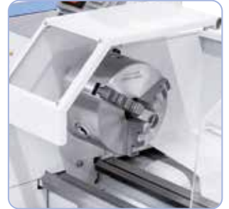
3-pofás tokmány 125 mm, eszterga- és fúrópofákkal a szállítási terjedelemben
