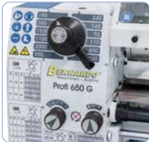
Az orsópálcánál elhelyezett kapcsolómű lehetővé teszi a gyors és egyszerű fordulatszám változtatást
