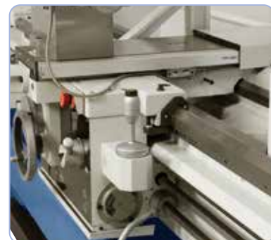
Inkluzív gyorsmenet a szán hosszanti és síkmozgásához
