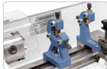
A lünetták megkönnyítik a hosszabb munkadarabok megmunkálását
