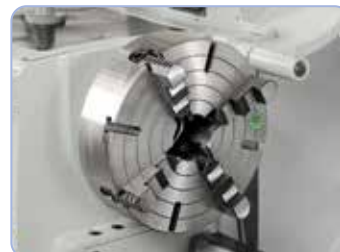
Síktárcsa 320 mm (opció) ideális aszimmetrikus munkadarabok befogásához
