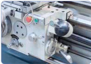
Sorozatszerűen gyorsmenettel a mellékidők lecsökkentésére
