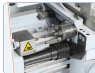
4 beállítható ütköző és mikrométer hosszanti-ütköző, ideális szériamunkákhoz
