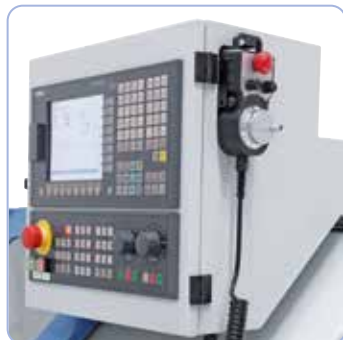
Siemens 808D Advanced vezérlés sorozatszerűen sok előreprogramozott funkcióval
