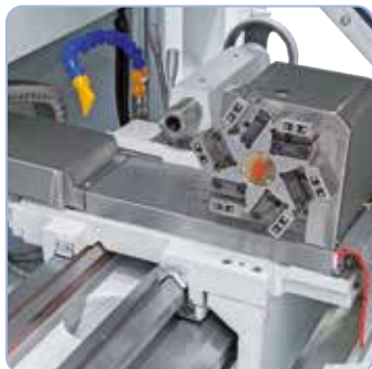
Az automatikus 6-szoros szerszámrevolver a csomag részét képezi.
