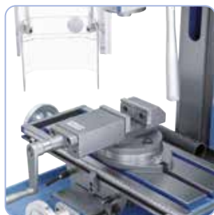
Marás PS 75 precíziós gépszuval
