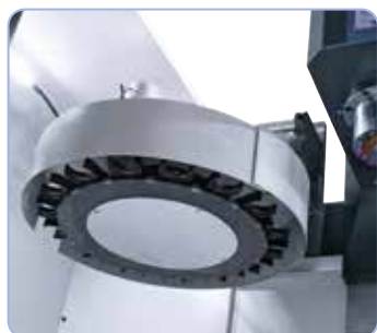
16-szoros szerszámcsere a rövid átszerelési idő érdekében
