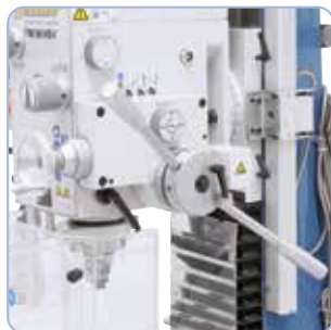
Sorozatszerűen egy hármass automatikus szegnyereg előretolóval van felszerelve
