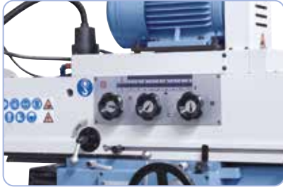
A felső karon egyszerűen beállítható orsó-fordulatszám.
