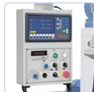
A függőleges orsó változtatható fordulatszám-beállítása frekvenciaváltóval
