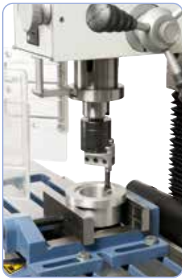
Igény szerint a gép kiesztorgálófejjel is felszerelhető
