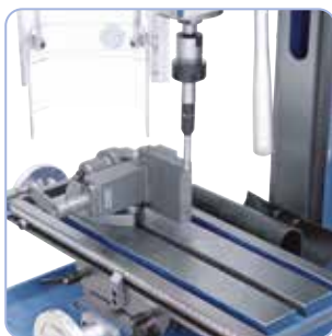
Szállítható kültartozék: Eltapintó fénykijelzővel MK 2
