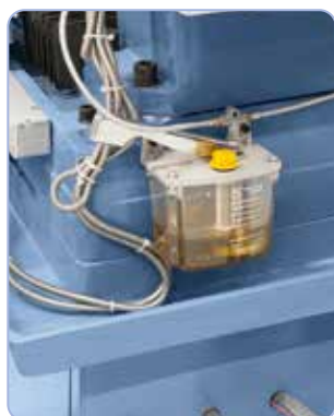
Sorozatszerűen központi kenéssel minden vezetópályához
