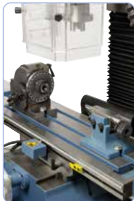
Fél-univerzális-osztófej BS-0: optimális tengelyek megmunkálására
