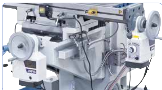
Sorozatszerűen automatikus maróasztal-előretolóval az x- és y-tengelyen
