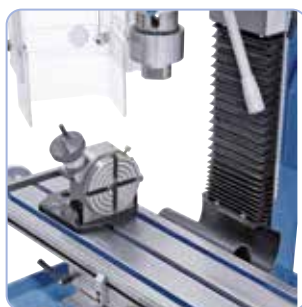
Opciósan szállítható kerekasztal további alkalmazási lehetőségek bővítéséhez
