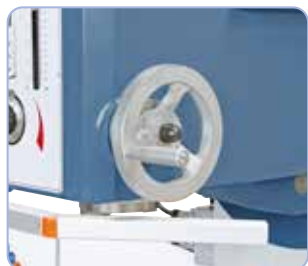
Az orsóhüvely-beállítás (100 mm) kézikerek segítségével történik
