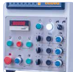
Az előretolási sebesség gyors és egyszerű beállítása direkt a kezelői panelen.
