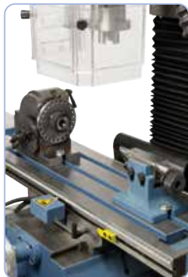
Fél-univerzális-osztófej BS-0: optimális tengelyek megmunkálására
