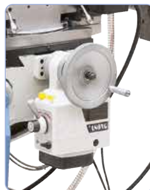
Sorozatszerűen fokozatmentes előretolással az y-tengelyen
