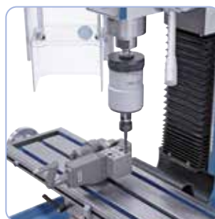
Menetvágáshoz a gép felszerelhető M5 - M12 menetvágó-készülékkel
