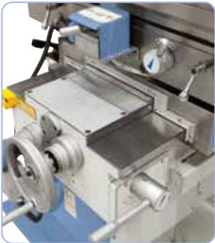
A nagyra dimenzionált derékszögű-vezető az y- és z-tengelyen nagyfokú stabilitást biztosít
