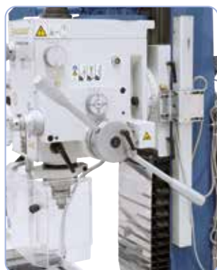
Az orsóhüvely-előretolás választható módon 0,10 / 0,18 vagy 0,26 mm/fordulatra beállítható
