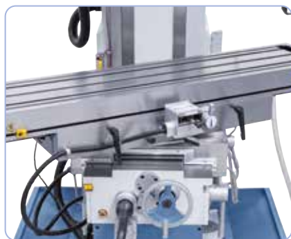
A nagyra dimenzionált síkvezetők stabilitást garantálnak nagy marási terhelés esetén, a maróasztal -45^\circ -tól +45^\circ -ig elfordítható
