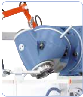
Az univerzális marófej a legkülönbözőbb szöghelyzetbe beállítható
