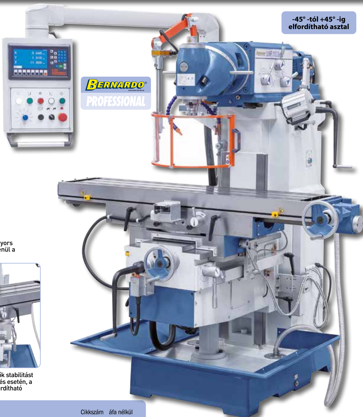
Az univerzális marófej a legkülönbözőbb szöghelyzetbe beállítható
