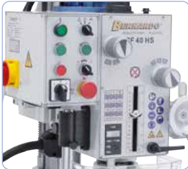
Áttekinthetően elhelyezett kapcsolók és kezelőelemek a hajtóműfejen.
