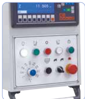
A kívánt előretolási sebesség gyors és egyszerű beállítása közvetlenül a kezelői panelen
