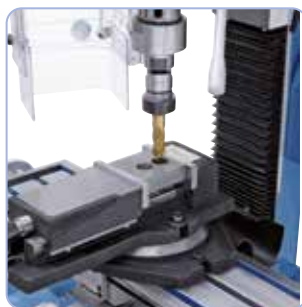
Marás FJ 100 nagybefogású gépsatuval
