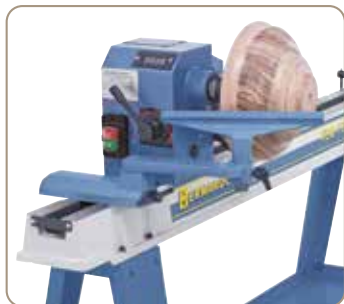
Nagyobb munkadarabok megmunkálásához az orsófej 90°-kal elfordítható
