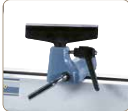
A kéziszán egyszerű rögzítése gyorszorítókar segítségével
