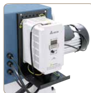
A nagyértékű frekvenciaváltó az orsó fordulatszámának fokozatmentes beállítását teszi lehetővé
