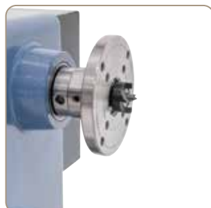
Felfogató tárcsa (100 mm átmérőjű), és négykörmös menesztő a szállítási terjedelem része.
