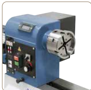
Szorítótkmány készlet Premium, M 115, Széles szorítófogó, belül / kívül recézett
