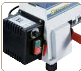
A fokozatmentes fordulatszám-szabályzó által a sebesség optimálisan a munkadarabhoz igazítható.
