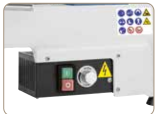
A fordulatszám optimális beállítása a fokozatmentes szabályzás által
