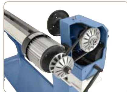
A sebességátvitel motorról szegnyeregre szolid variátor-hajtóművel történik
