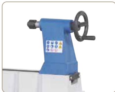
Szegnyereg átmenőfurattal, ideális pl. kábelcsatornák előállításához lámpaaljakokban
