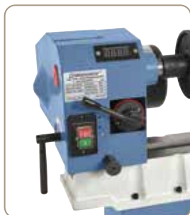
A kívánt fordulatszám optimális beállítása érdekében a gép egy digitális fordulatszám-mutatóval felszerelt
