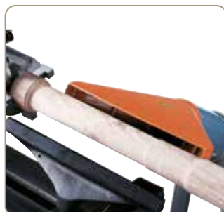
Az opcionálisan kapható elszívó tiszta munkahelyről gondoskodik esztergálásnál
