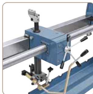
Sorozatszerűen hozzáépített másolóberendezéssel, másolás eredeti vagy sablon szerint lehetséges
