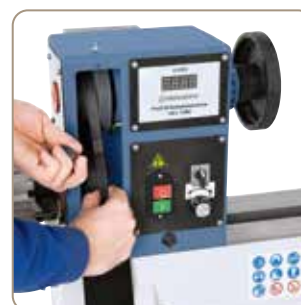
Az áttét fokozat egyszerű váltása az ékszíj áthelyezése által
