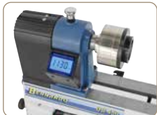
A fordulatszám egyszerű leolvasása a LED kijelzőn
