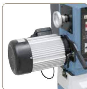
A nagyteljesítményű hajtómotor alacsony fordulatszám mellett is magas forgatónyomatékot biztosít
