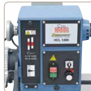
A sorozatszerű digitális mutató megkönnyíti a kívánt fordulatszám beállítását
