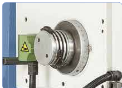
Menetvágó berendezés gyors- ill munka-előretolással és gyors visszamenettel (KBM 63-tól)
