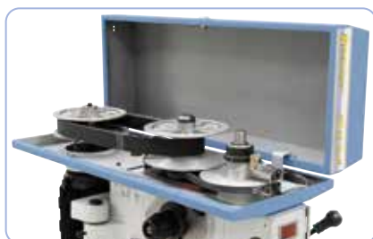
A sebességátvitel a motortól a szegnyereg szolid variátormeghajtó által történik
