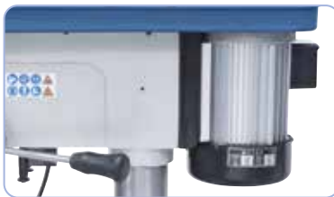
Nagyteljesítményű alumínium-motor IP 54 szerint
