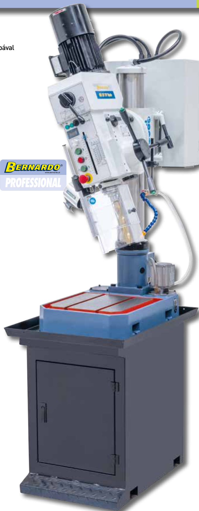
A hajtómű-fokozat egyszerű előzetes kiválasztása előtét segítségével, a kívánt fordulatszám beállítása potméterrel
