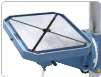
A nagyra méretezett fúróasztal -45° -tól +45°-ig elfordítható valamint dönthető
