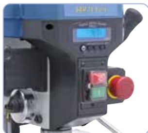
Sorozatszerűen digitális fordulatszám- és fúrásmélység-mutatóval
