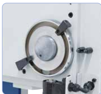
Menetvágó berendezés forgásirány-váltóval, ideális sorozatgyártáshoz (KBM 50-ig)
