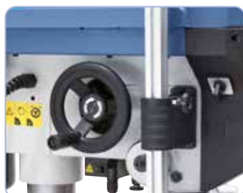
Oldalt elhelyezett kézikerék a kívánt fordulatszám beállításához
