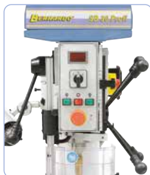
Sorozatszerűen digitális fordulatszám mutatóval felszerelve. Ergonomikus kialakított kapcsolási és kezelő elemek a gép elején
