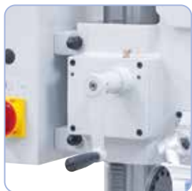
A fűrőfej egyszerű magasság-beállítása forgattyúval
