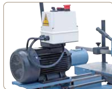
Erős teljesítményű 2-fokozatú-hajtómotor az optimális fúrási teljesítményért
