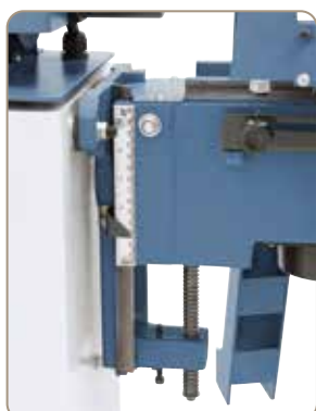
A fúróasztal beállított magassága skála segítségével olvasható le
