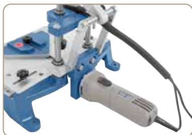
A 850 W motor alkalmas W-1, W-2 és W-3 fecskenyagyságok előállítására
