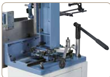
Hosszanti- és keresztirányú mozgás beállítható ütközőkkel
