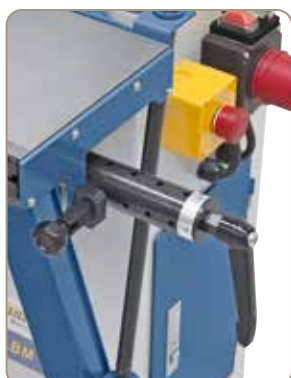
Sorozatszerűen csapfúró-berendezéssel, 16 / 20 / 22 / 25 mm raszterbeosztással
