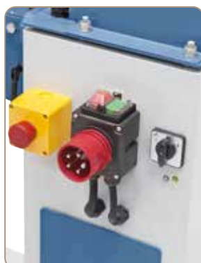
Vész-Ki- és forgásirány-kapcsoló a géptesten oldalon
