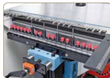
Ujjas-ütközőléc 3 mélyedéssel fazekpántokhoz való kombifűrő-szegmensek alkalmazására
