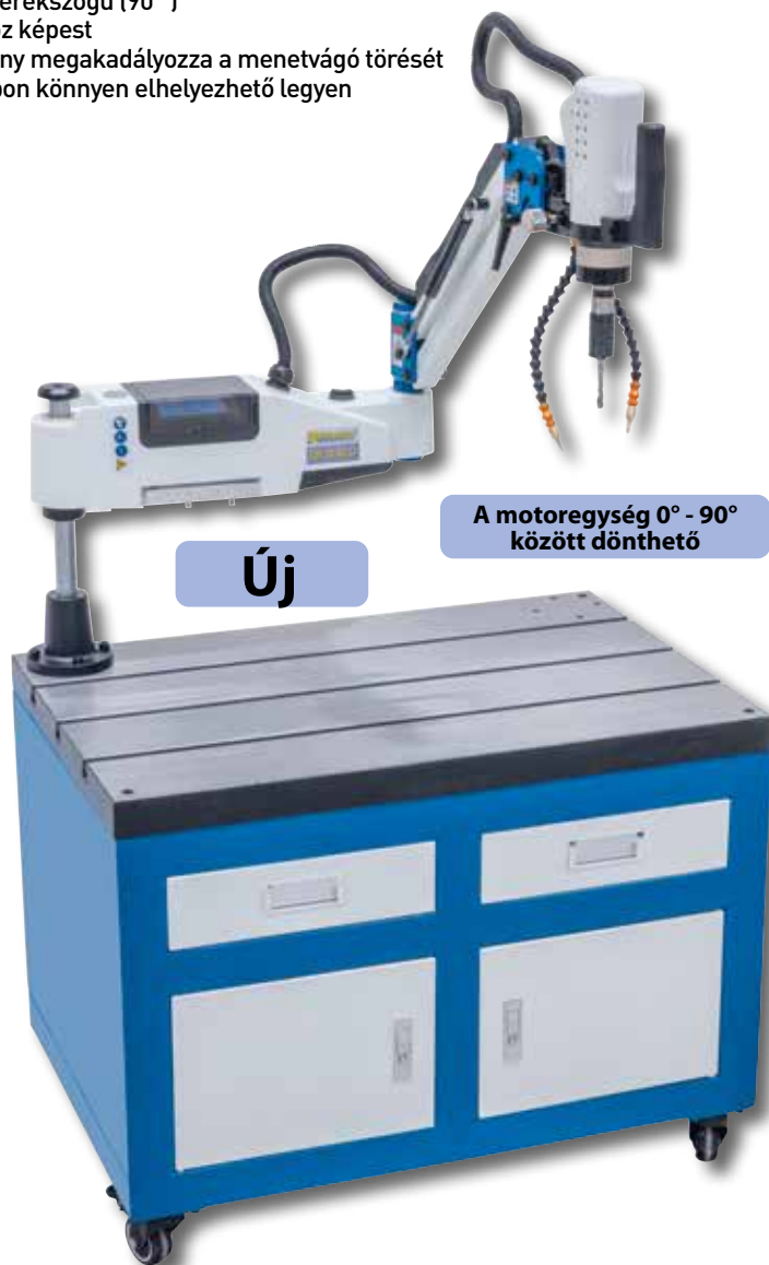
Kényelmes munkavégzés: a menetméret, a menetemelkedés, a sebesség és a fúrási mélység beállítása közvetlenül az integrált érintőképernyőn
