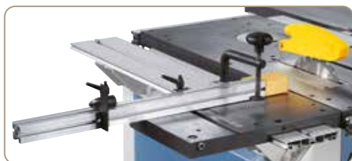
A masszív, 45°-ig ferdén beállítható egyengető-ütköző prizmás vezetéssel könnyen beállítható
