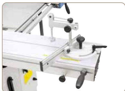
A T-horony a formázó-asztalban lehetővé teszi a sarkalat-ütköző és a szélezősaru felszerelését
