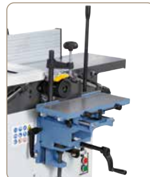
A hosszlyukfúró-berendezés ideális hosszlyukakhoz, csap- és ferde lyukfuratokhoz (opció).
