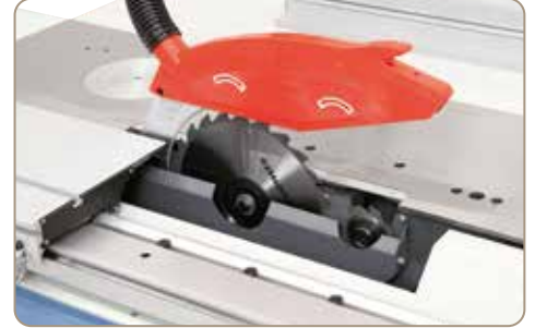
A fűrészlapvédő integrált elszívó-csőtoldattal a hasítóéken van rögzítve. Sorozatszerűen előmetsző-aggregáttal felszerelt.
