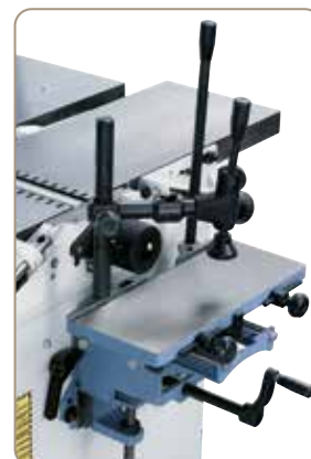
Hosszlyukfúró-berendezés nagy feltét-asztallal és excenter-szorítóval sorozatszerűen
