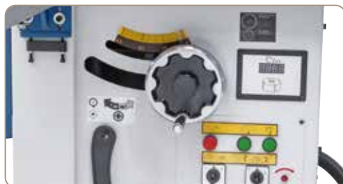
A beállított orsó-fordulatszám elektronikus kijelzése
