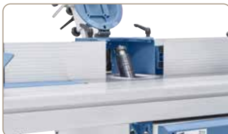
A hátrafelé elfordítható maróorsó előnyei: egy előretoló készülék optimális alkalmazása, a biztonság maximuma és tiszta marási kép
