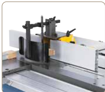
A szolid maró-védősapka max. 140 mm átmérőjű szerszámokhoz alkalmazható
