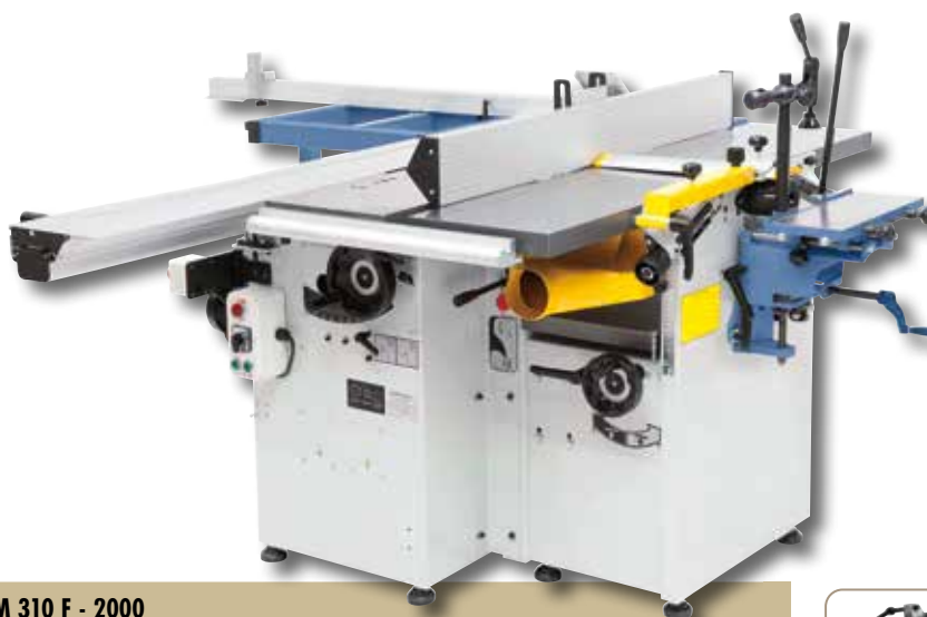
A maró-védősapka eloxált alumínium ütközősínekkel felszerelt
